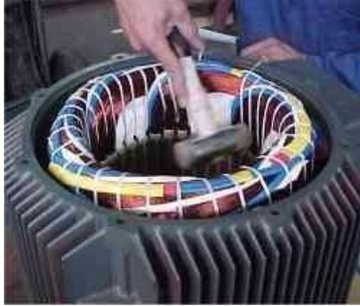
شكل (7-11) الجزء الثابت في محركات التيار المتناوب
