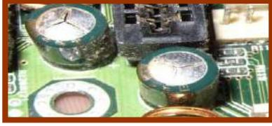
9- في الشكل المجاور متسعات نالفة، كيف يمكنك تشخيصها بدون استخدام أجهزة القياس وباستخدام الافوميتر الرقمي
