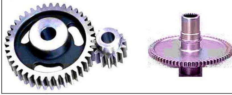
شكل 11-33 التروس المستقيمة Spur Gear
