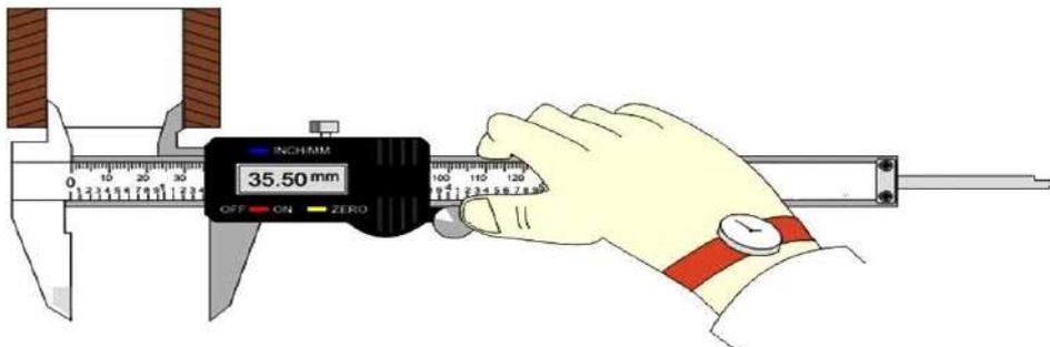
الشكل ( 10 -11) قياس القدمة الرقمية للمسافات الخارجية
