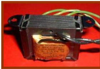
تتنوع صناعة المحولات حسب نوع القلب (core) ونوع الاستخدام المطلوب فالمحولات ذات القلب الهوائي والفرايت تنقل التيارات بالترددات الراديوية والواطئة بينما المحولات ذات القلب الحديدي هي عبارة عن مجموعة من الصفائح الرقيقة المعزولة لتركيز المجال المغناطيسي وتحسين الكفاءة والتقليل من ارتفاع درجات الحرارة، لاحظ الشكل (5 - 8).
