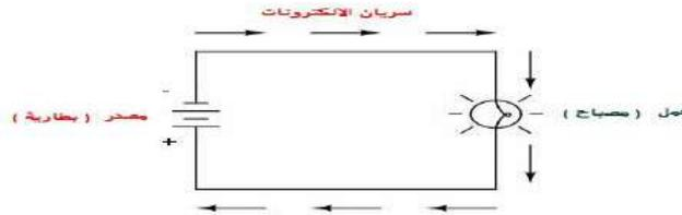
شكل ( 2 - 2 ) الدائرة الكهربائية المغلقة
