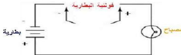
شكل ( 2 - 3 ) الدائرة الكهربائية المفتوحة
