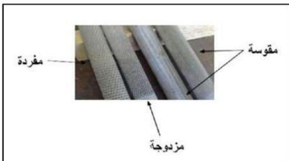
الشكل (2-52) يوضح انواع المبرد بحسب شكل الاسنان
