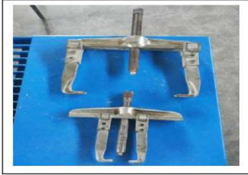
شكل (2-34) قالعة كرسي التحميل بذراعين
