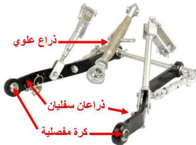
الشكل (34-3) مكونات منظومة التعليق
