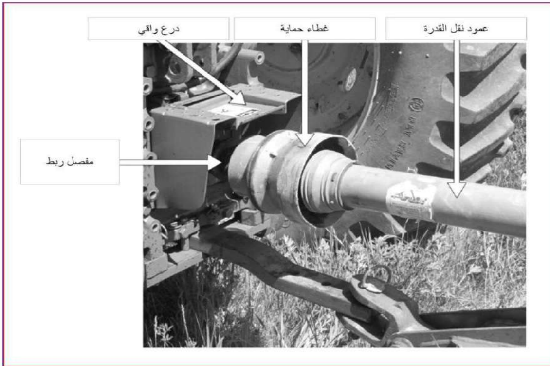
الشكل (8-5) عمود نقل القدرة مربوط بين الساحبة والمُعَدّة الزراعية
