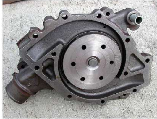
الشكل (24-3) مضخة سائل التبريد المستخدم في المحرك
