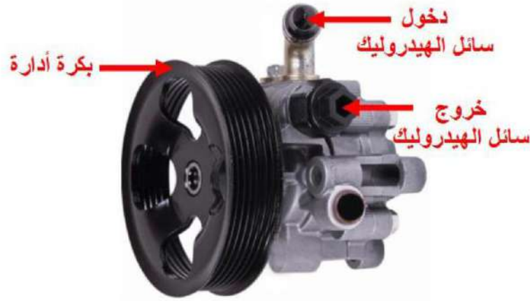
الشكل (31-3) مضخة هيدروليكية ملحقة مع منظومة الاستدارة
