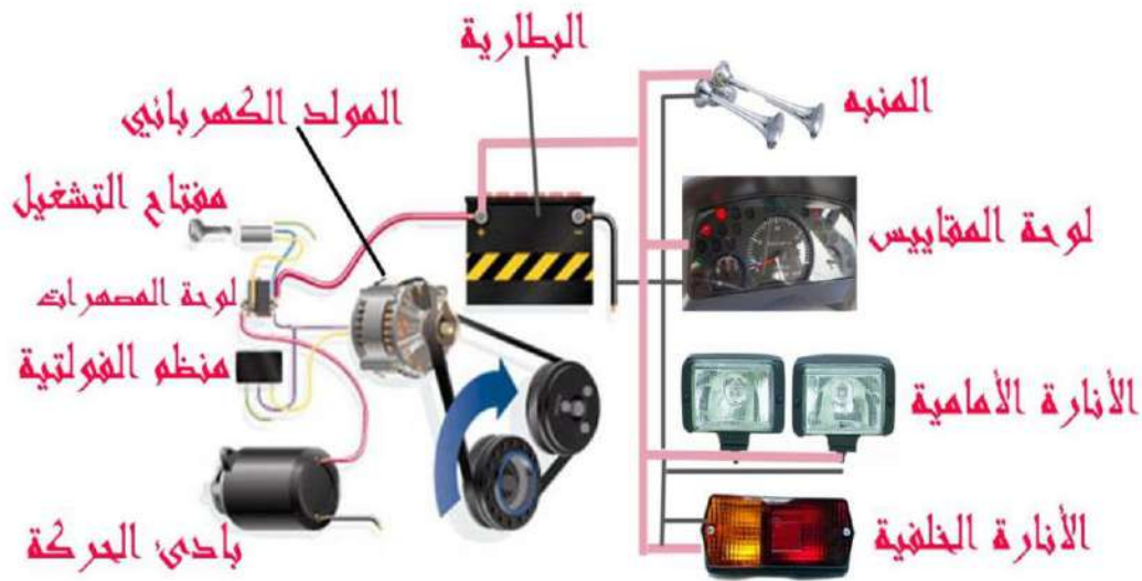
الشكل ( 3-38 ) رسم تخطيطي للمنظومة الكهربائية في الساحبة الزراعية
