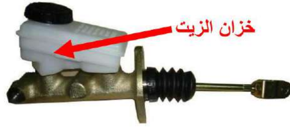
الشكل (4-30) خزان زيت منظومة الموقف
