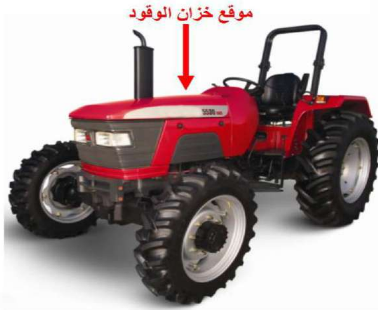
الشكل (2-3) خزان الوقود فوق المحرك
