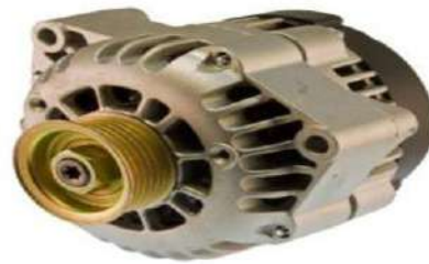
الشكل (40-3) المولد الكهربائي
