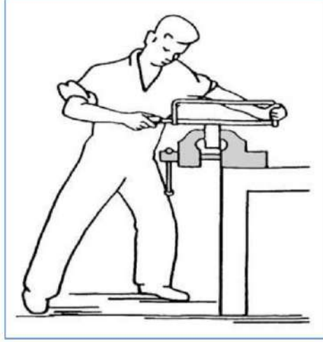
شكل ( 2 - 41) الطريقة الصحيحة لعملية النشر
