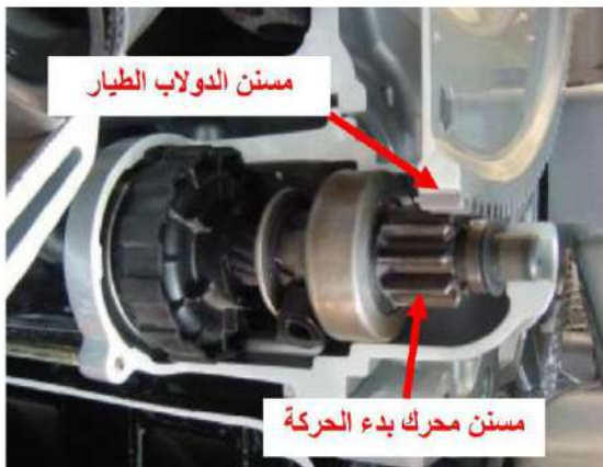
الشكل (9-3) تعشيق مسنن الدولاب الطيار مع مسنن محرك بدء الحركة
