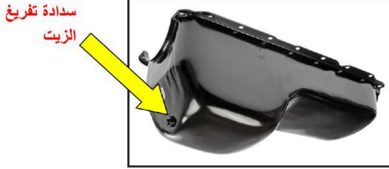
الشكل (3-16) وعاء الزيت وسدادة التفريغ
