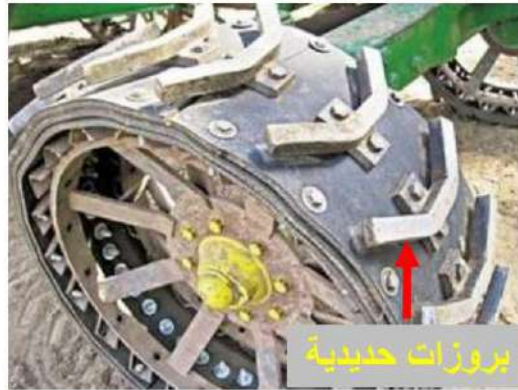
الشكل ( 4-17 ) عجلة حديدية ذات بروزات حديدية
