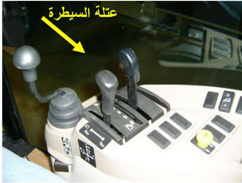
الشكل (36-3) عتلة السيطرة على رفع وخفض الأذرع الهيدروليكية
