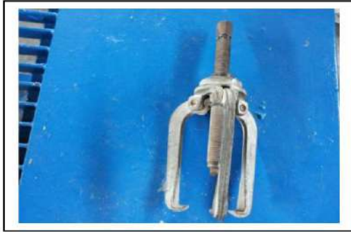
شكل (2-35) قالعة كرسي التحميل بثلاث اذرع
