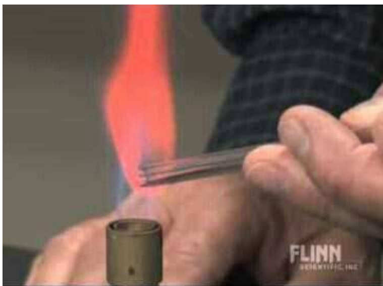
شكل 25-1 طريقة تهذيب نهاية الانبوب الزجاجي
