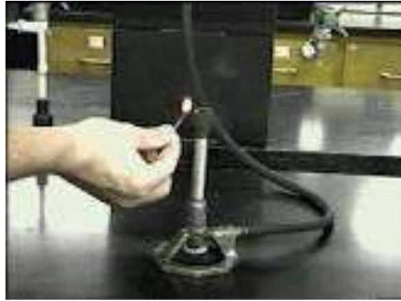
شكل 16-1 طريقة تشغيل مصباح بنزن
