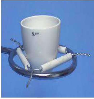
الشكل 8-1 استعمال الجفنة في عملية الحرق بمصباح بنزن
