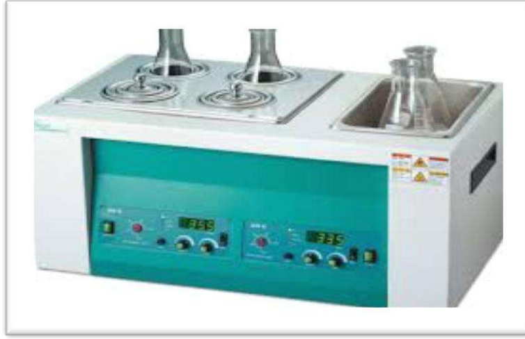
شكل 1-20 وضع الدوارق المخروطية في الحمام المائي
