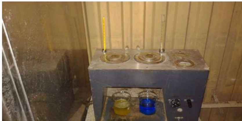
شكل 2-15 جهاز انكلر لقياس اللزوجة
