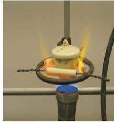
الشكل 8-1 استعمال الجفنة في عملية الحرق بمصباح بنزن
