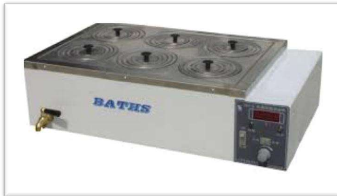
شكل 19-1 الشكل العام للحمام المائي
