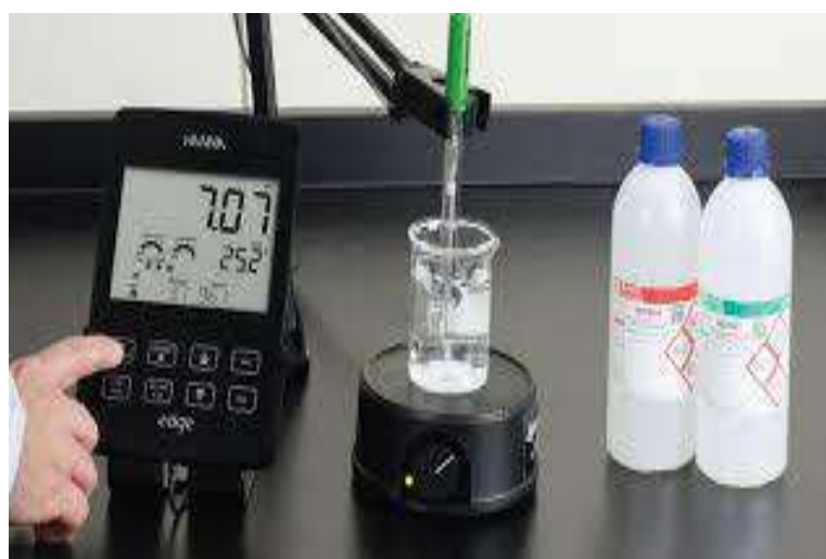
شكل (3-5) قياس محلول البفر (القياسي)
