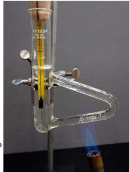
شكل (22-2) جهاز ثيل لقياس نقطة الانصهار
