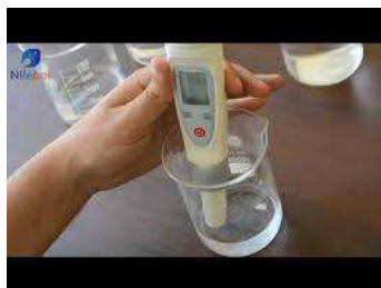
شكل (3-7) طريقة قياس الحامضية يدويا
