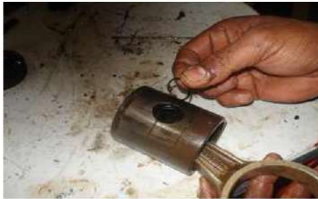
4- خروج الحلقة الذي يثبت المحور بذراع التوصيل
