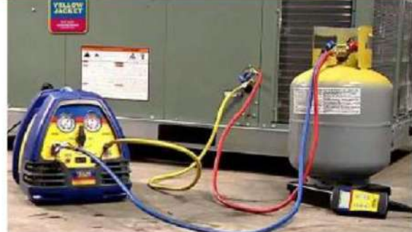
1- ربط مجموعة استرجاع مائع التثليج بمنظومة التثليج
