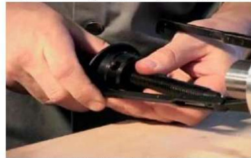
3- تجميع الأجزاء الثلاثة بلولب السحب
