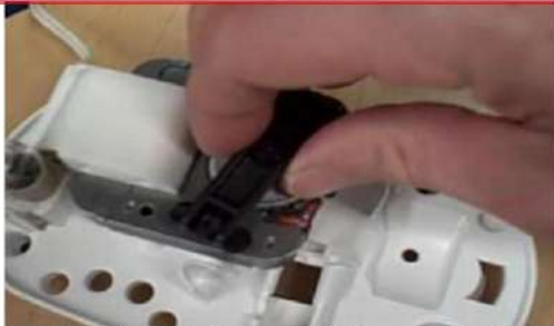
2- رفع العارضة التي تربط المحرك بالقاعدة
