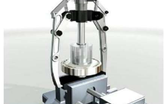
7- البدء بلف لولب الدفع ودفع الكرسي تدريجياً
