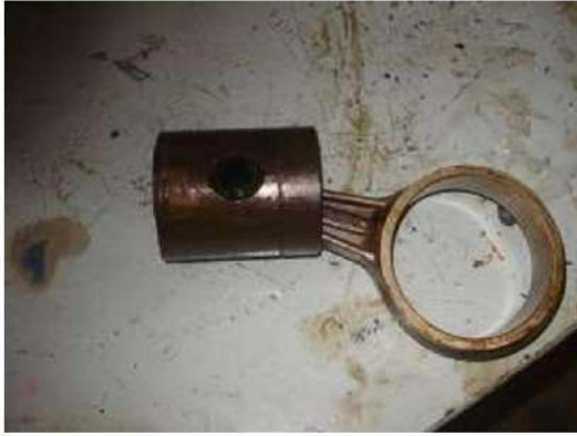
26- إخراج الجزء الدوار وتحرير ذراع التوصيل للمكبس
