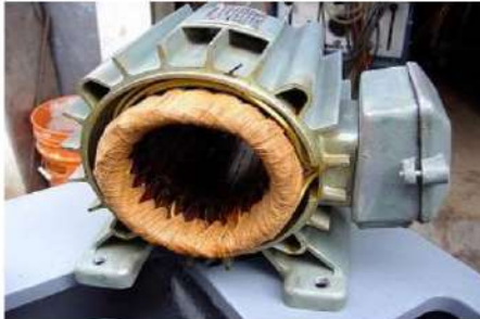
4- الملف الكهربائي للمحرك
