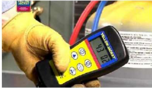
4- يتم مراقبة شاشة الميزان فعند ثبوت القراءة يعني هذا انتهاء عملية الاسترجاع
