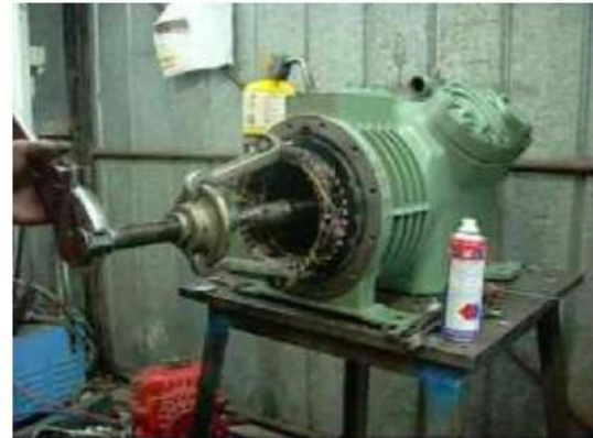
19- استخدام أداة السحب مع استمرار التسخين
