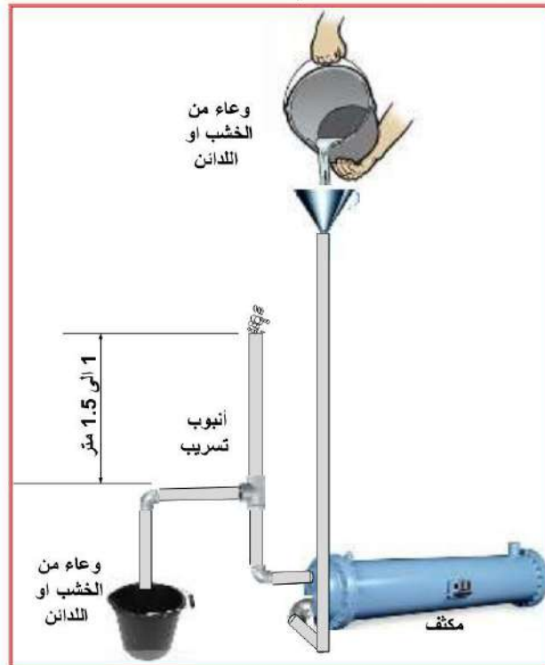
شكل 19-3 شبكة الأنابيب لتنظيف المكثف المبرد بالماء بطريقة الجريان الحر لمحلول التنظيف
