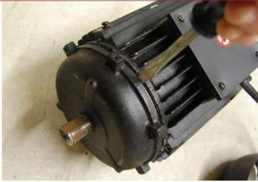
2- استخدم مفك اللولب لرفع الغطاء الأمامي للمحرك.
