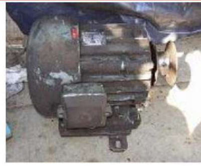
1- المحرك الكهربائي قبل التنظيف
