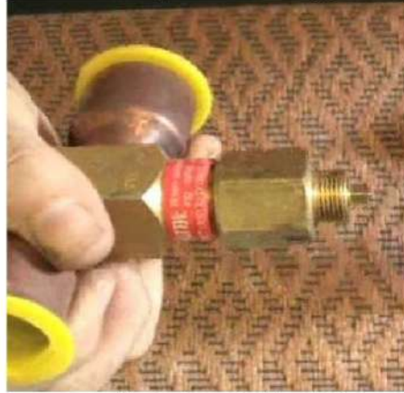
5- لولب التحكم بمقدار التخميص
