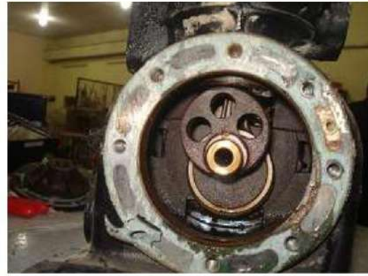
15- حذافة العمود المرفقي والتي تستخدم في تزييت الضاغط
