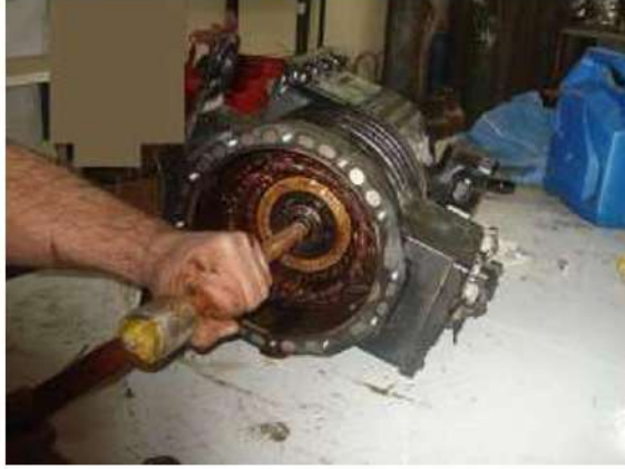
20- صامولة تثبيت الجزء الدوار بالعمود المرفقي
