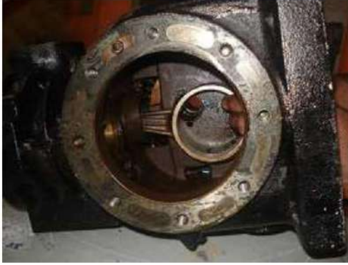
26- إخراج الجزء الدوار وتحرير ذراع التوصيل للمكبس
