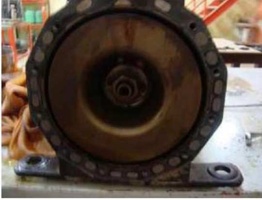
20- صامولة تثبيت الجزء الدوار بالعمود المرفقي
