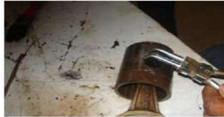
3- إستخدم المفتاح لإزالة حلقة حاكم التثبيت
