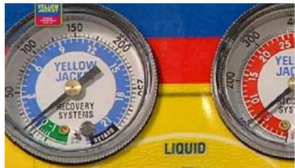
15- عند وصول ضغط مقياس السحب إلى الصفر فهذا يدل على انتهاء عملية استرجاع مائع التثليج
