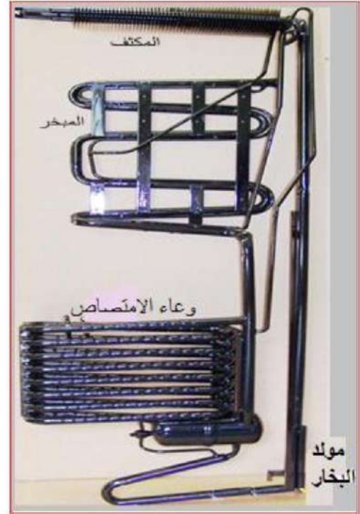
شكل 7-1 الدائرة الميكانيكية للثلاجة الامتصاصية
