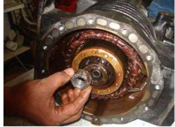
21- إفتح الصامولة التي تثبت الجزء الدوار بالعمود المرفقي
