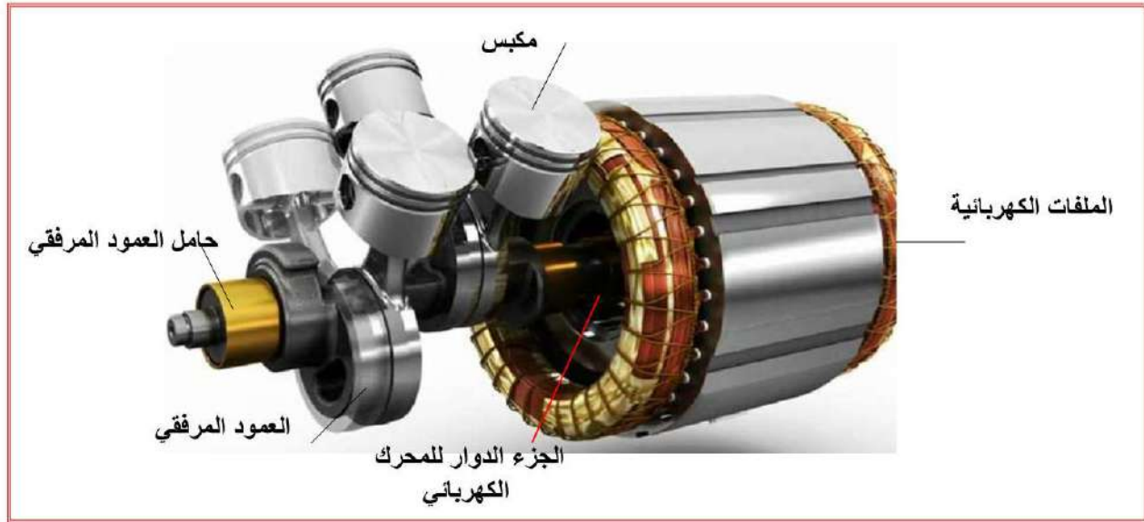
شكل 2-3 ربط العمود المرفقي بالجزء الدوار للمحرك الكهربائي
