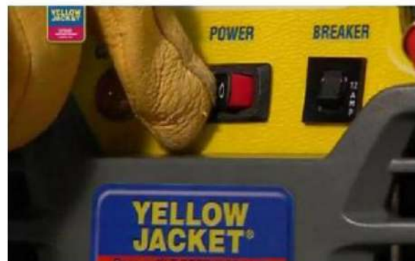
11- صل التيار الكهربائي لمجموعة استرجاع مائع التثليج
