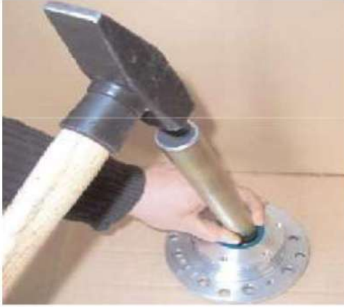
2- في حال عدم إمكانية رفعه باليد تستخدم المطرقة
