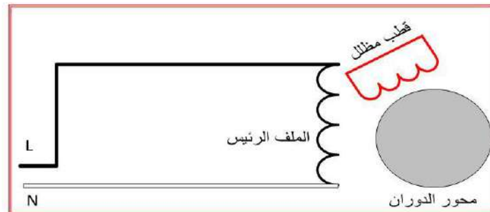
شكل 9-8 الدائرة الكهربائية لمحرك كهربائي ذي قطب مظلل سرعة واحدة
