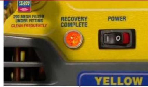
9- توهج المصباح إيذاناً بانتهاء عملية الاسترجاع
