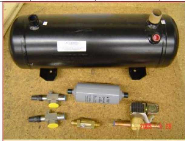
شكل 9-5 المكثف المبرد بالماء مع ملحقاته الضرورية
