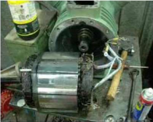
20- إخراج الملف الكهربائي
