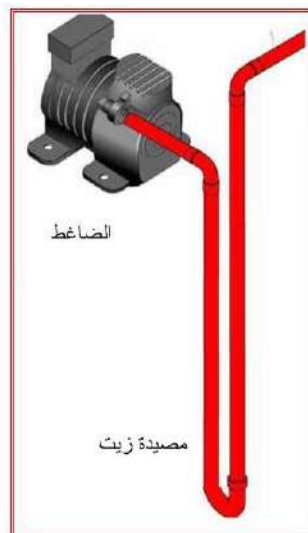
شكل 2-5 مصبدة الزيت التي تنصب قبل خط السحب للضاغط
