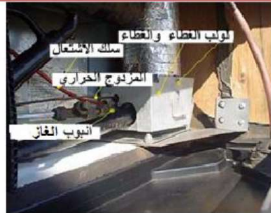
1- منظومة الاشتعال للثلاجة الامتصاصية التي تعمل بالغاز المسال
