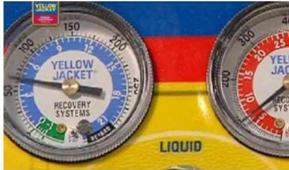
14- لاحظ مقياس الضغط الواطئ سيبدأ بالهبوط بشدة
