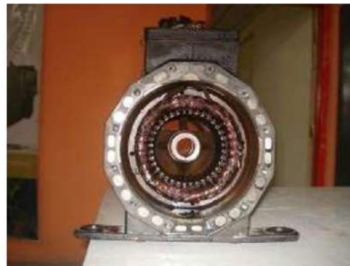
29- الضاغط بعد سحب الجزء الدوار والعمود المرفقي
