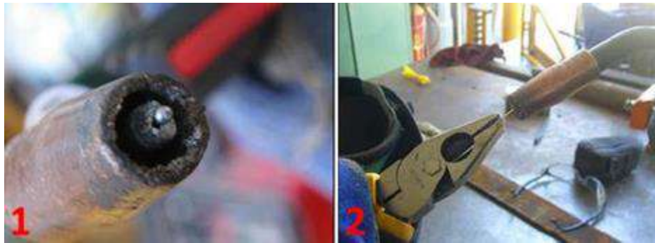
الشكل (١-٤٠) يوضح نهاية سلك اللحام ١. نهاية منكورة لاتصلح للحام ٢. يتم سحب السلك بواسطة الكماشة لطول مناسب
