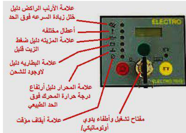
الشكل (٣-٧) العلامات الدالة والمنبه لوجود خلل في أحد أجزاء المولدة لمسيطر أوتوماتيكي
