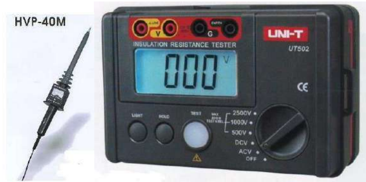
الشكل (٢-٥٥) جهاز قياس العازلية وعصا فاحص ومقياس جهد عال KV ٤٠
