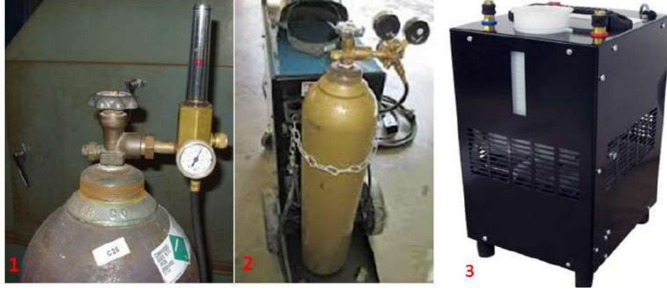
الشكل (١-٣٨) يوضح ١. صمام غلق قنينة الغاز ومنظم الضغط ومقياس معدل تدفق الغاز ٢. موضع القنينة مع مجهز القدرة ٣. منظومة ماء التبريد
