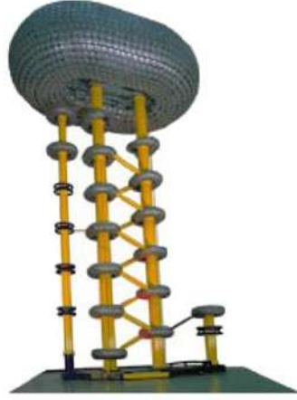
الشكل (٢-٤٥) وحدات من محولات تيار متناوب متوالية بشكل رأسي لتوفير الأمان
