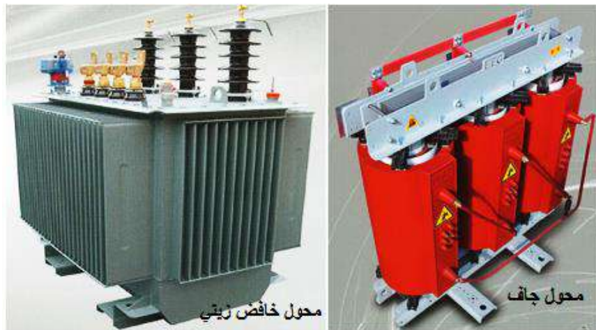
الشكل (٤-٦) محول توزيع بنسبة تحويل ١١kv/٤١٦v أو ٣٣KV/٤١٦v تبريد زيت ONAN سعة ١٠٠٠KVA توصيل DYN١١ ونوع آخر جاف
