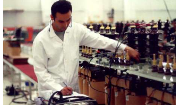
الشكل (٤-١٥) فحص العازلية للمحولة بأستخدام أجهزة توليد الجهد العالي (الميجر)
