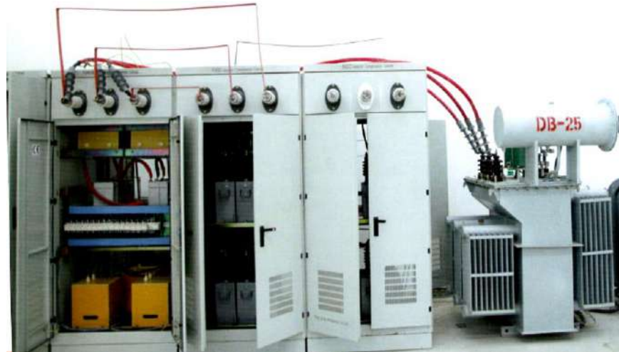
الشكل (٤-٢٠) مختبر فحص محولات القدرة باستخدام جهاز العاكس الثلاثي الأطوار
