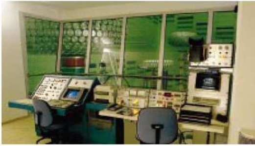
الشكل (٢-٤٦) مختبر ضغط عال يستخدم جهود بمعدل 750 \text{ KVAC} ، 800 \text{ KVDC}
