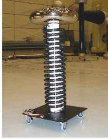
الشكل (٢-٥٢) تقنية قياس الجهد العالي بأستخدام مقاومات وفولتميتر ذات ممانعة عالية
