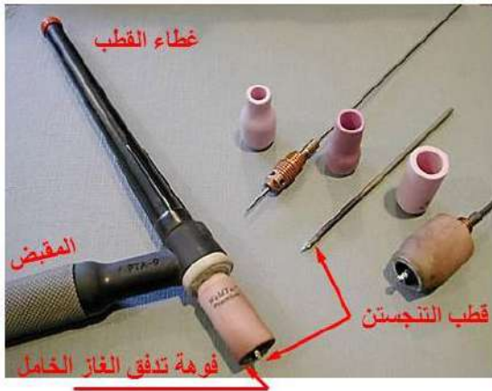
الشكل (٢٦-١) يوضح أنواع وأجزاء مسدس اللحام
