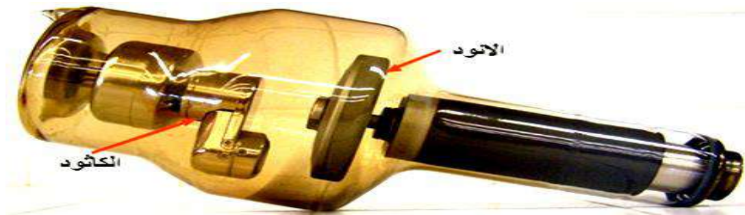
شكل 2-1 الغلاف الزجاجي لأنبوبة الأشعة السينية
