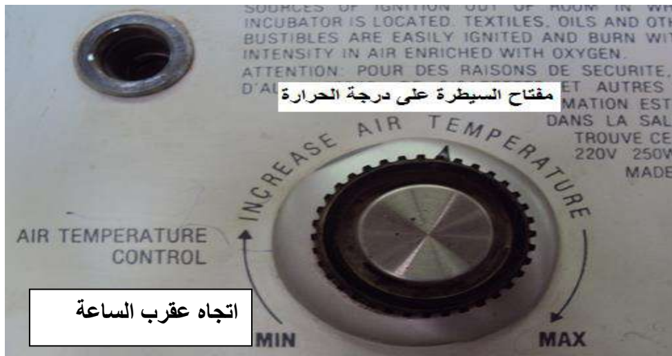
شكل 15-6 , a نحر ك مسيطر الحرارة باتجاه عقرب الساعة
