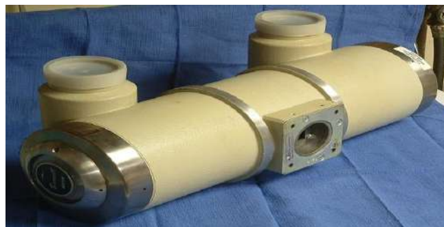
شكل 4-1 الغلاف المعدني لأنبوبة الأشعة السينية (المظهر الخارجي)
