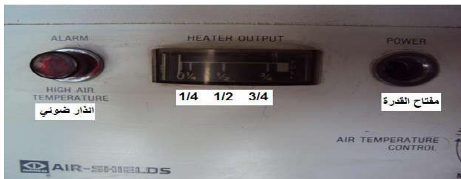
شكل 15-6 , b حرك مفتاح السيطرة عكس اتجاه عقرب الساعه على 1/2
