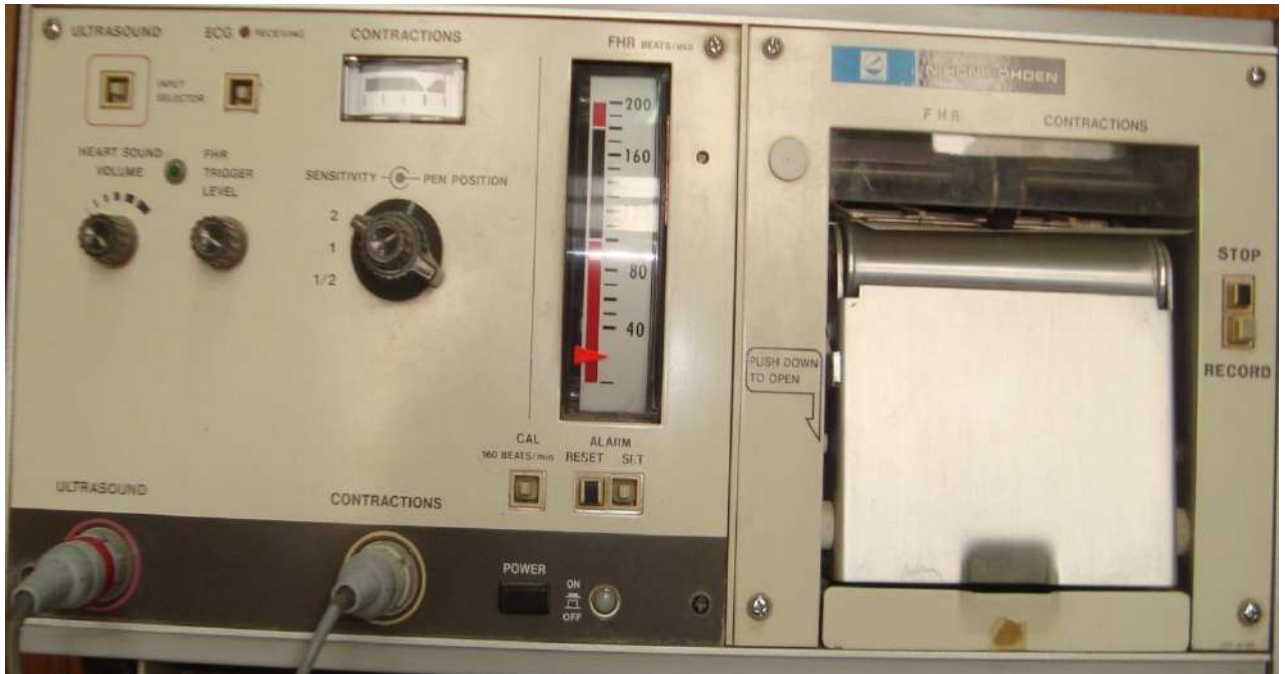
الشكل (2-8) الواجهة الامامية لجهاز مراقبة الولادة مع جميع مفاتيح التشغيل والتنظيم
