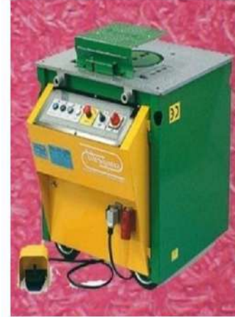
الشكل (7-6) مقص يدوي لقص حديد التسليح وثنائية كهربائية
