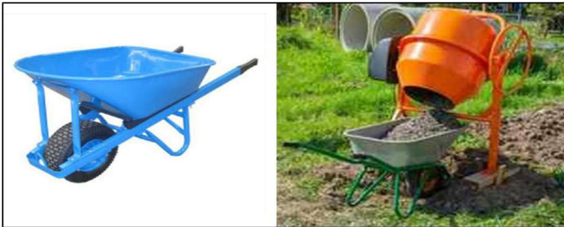
الشكل ( 2-2 ) طريقة عمل الخباطة وعملية تفريغ الخرسانة في العربة اليدوية
