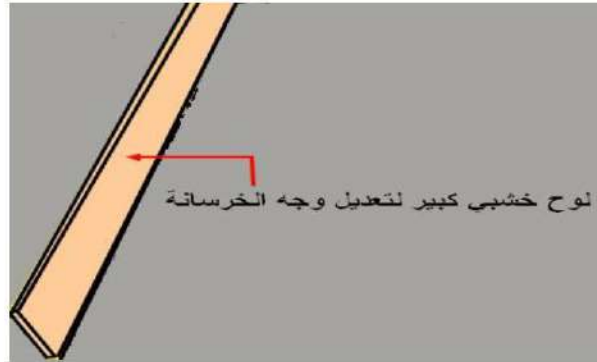
الشكل (6-12) مالج من الخشب للتسوية وجهاز الهزاز
