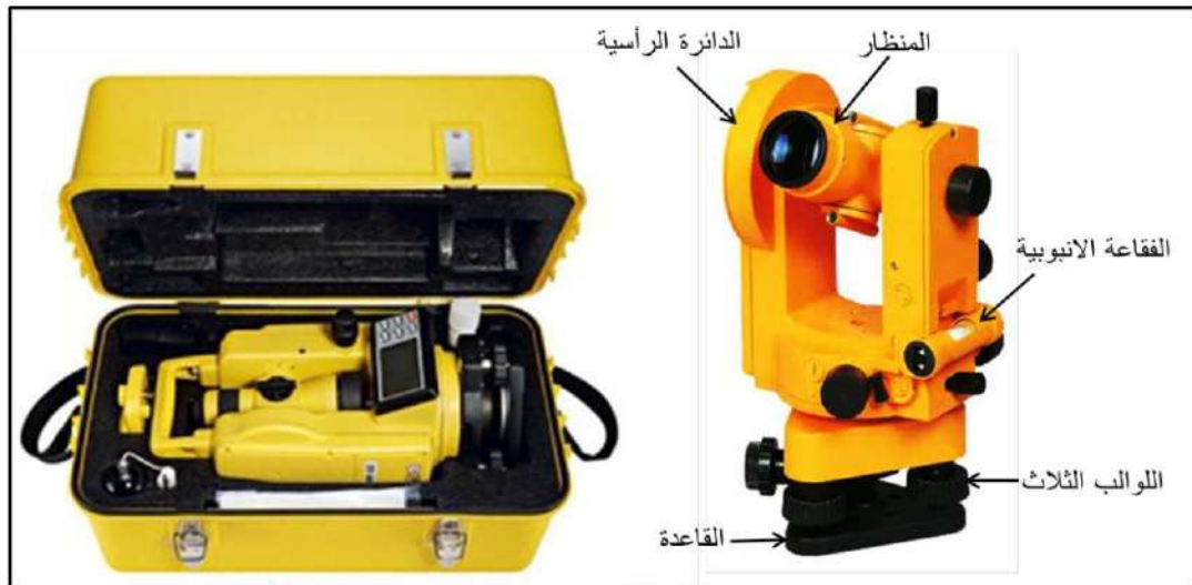
(12-1) يوضح احد انواع اجهزة الثيودولايت والجهاز داخل الحقيبة لحفظه من الكسر
