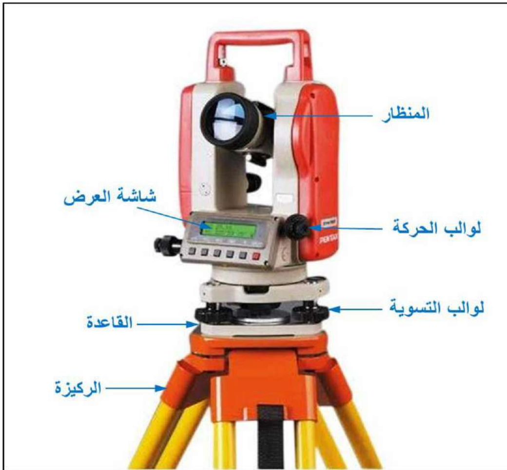
الشكل (10-1) يوضح جهاز الثيودولايت وأجزائه الرئيسية
