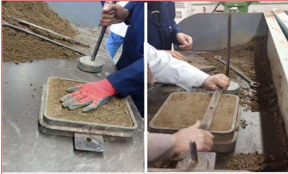
الشكل (6-14) دك الرمل في القالب وتسويته باستخدام المدكات والمسطرة
