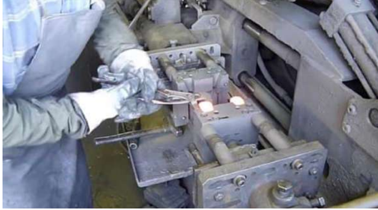
الشكل (3-7 i) رفع أداة الربط
