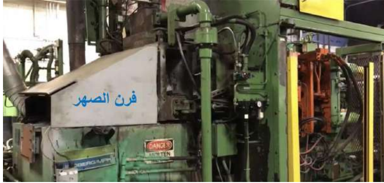
الشكل (c12-3) عملية حقن المعدن داخل القالب
