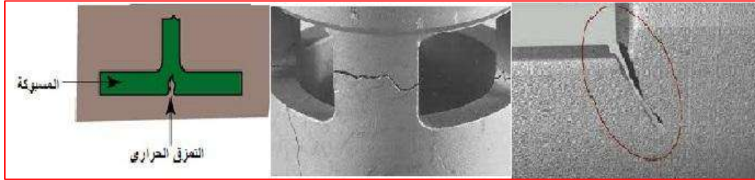
الشكل (8-6) عيوب التشقق الحراري للمسبوكات
