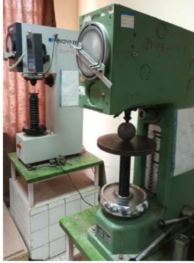
الشكل (6-40) فحص الكرة الحديدية بجهاز قياس الصلادة
