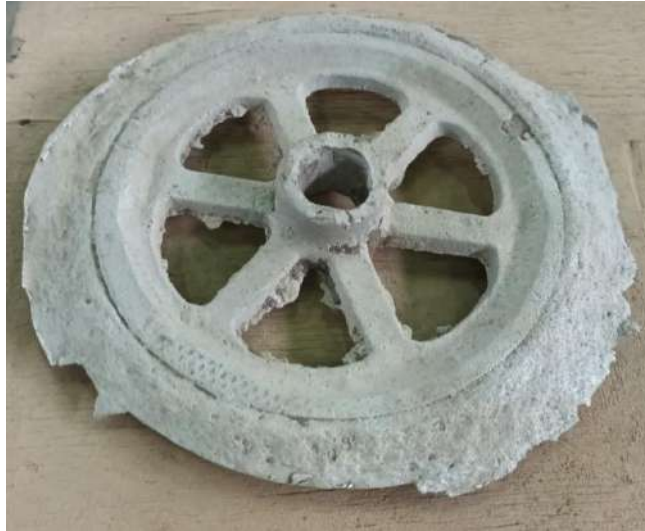
الشكل (6-17) المسبوكة بعد إزالة القالب والرمل
