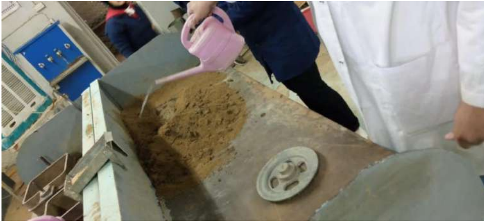
الشكل (6-12) عملية غربلة الرمل مع رشه بالماء قبل عملية البدء بعملية السباكة
