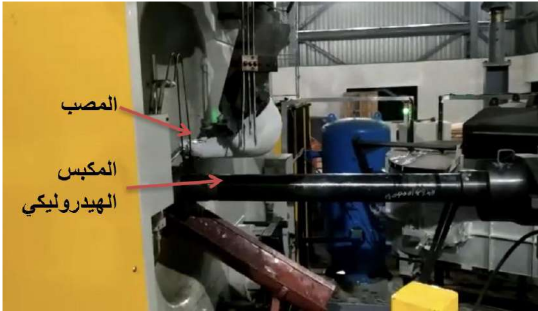
الشكل (c15-3) تدفق السبيكة داخل القالب بواسطة نظام المصب
