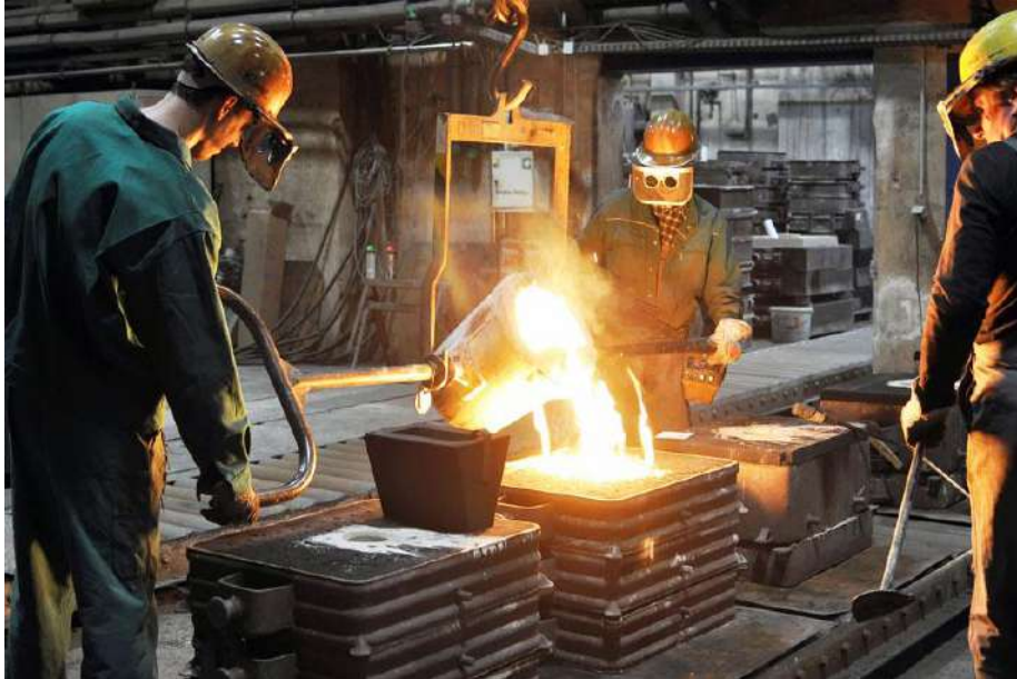
الشكل (2-19) صب منصهر الفولاذ من البودقة بمعدات مناولة ونقل جيدة
