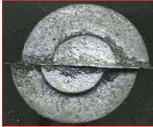
الشكل (1-6) عيب عدم تطابق المسبوكة
