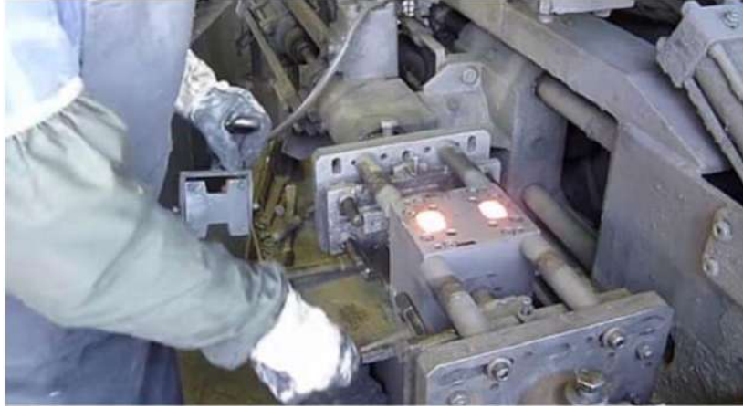
الشكل (g 7-3) إنهاء عملية الصب
