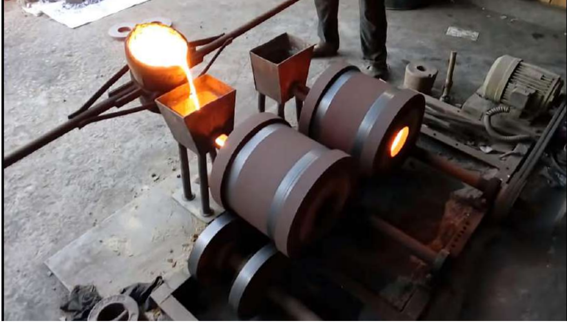
الشكل (5-5) ماكينة الطرد المركزي الأفقية أثناء صب منصهر المعدن في حوض الصب
