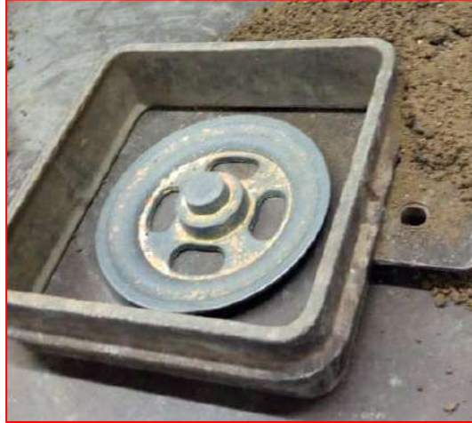
الشكل (6-13) وضع نصف النموذج الأول في الجزء السفلي لصندوق المقلبة
