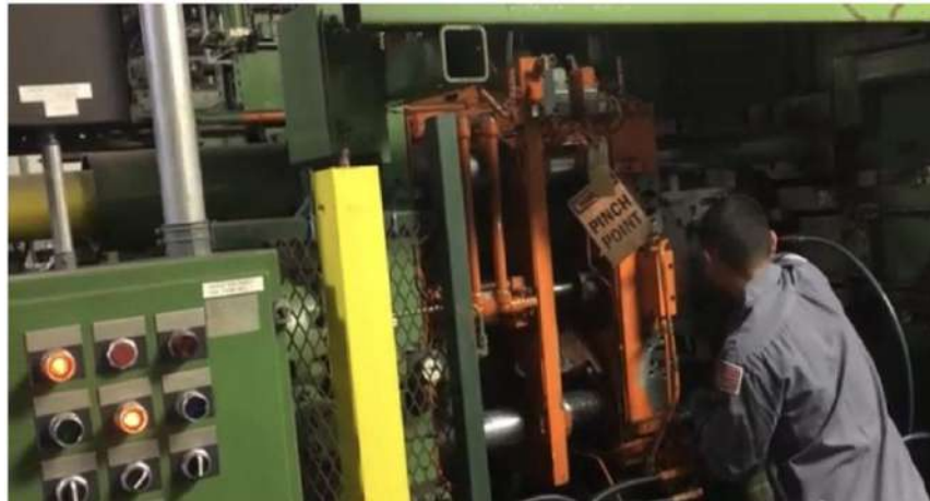
الشكل (b12-3) تنظيف القالب وعملية التزيت
