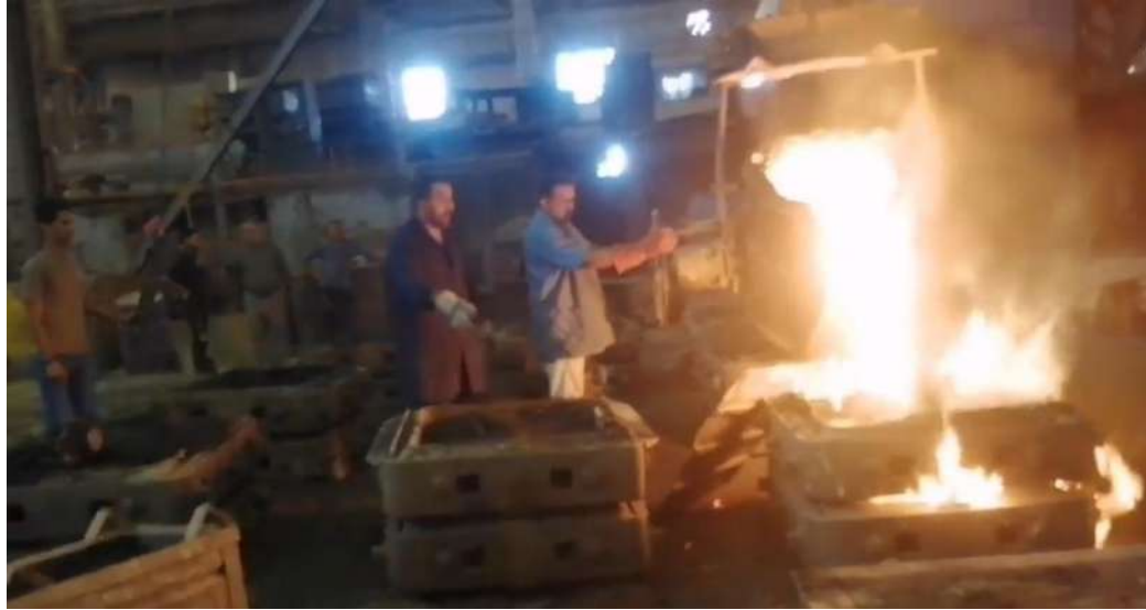
الشكل (34-6) تحضير منصهر المعدن للصب في القوالب
