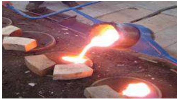
الشكل (11-2) صب منصهر المعدن
