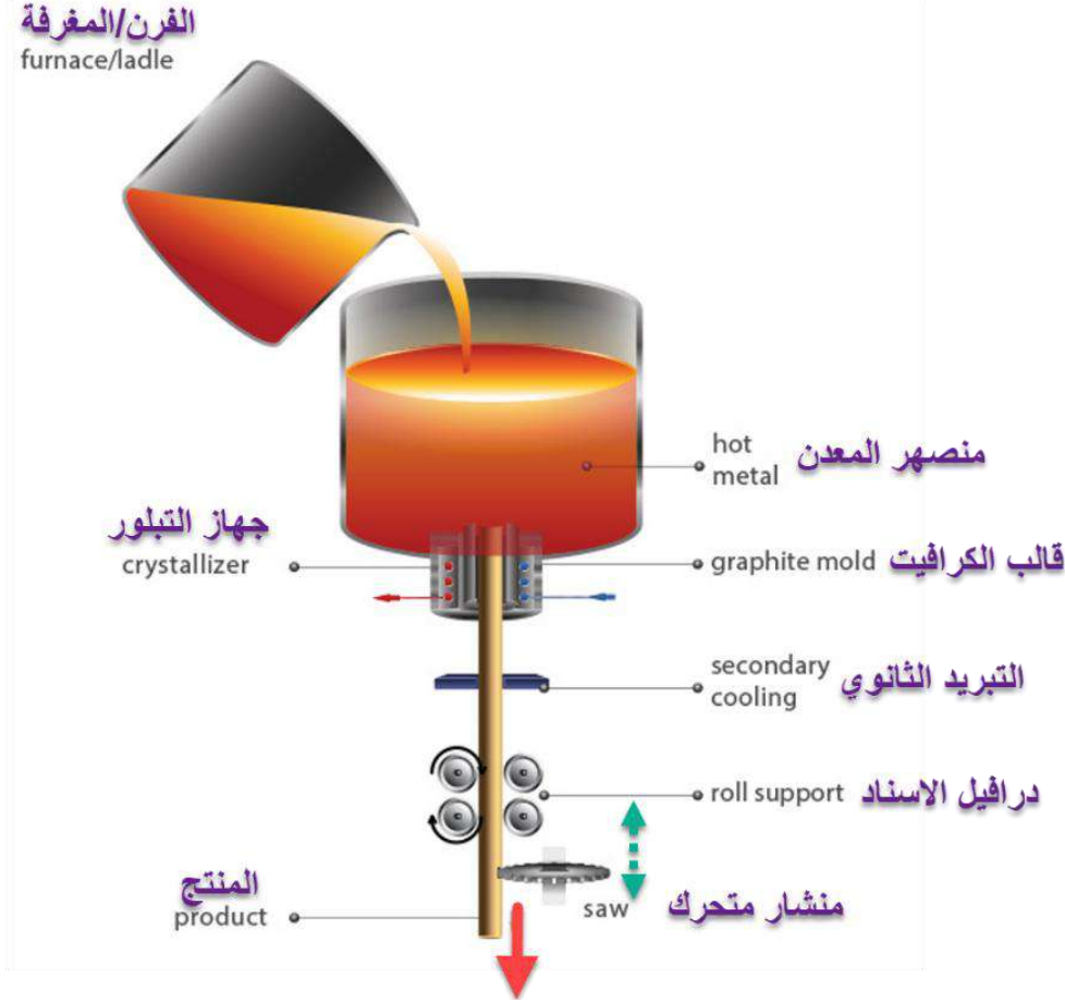
الشكل (18-4) رسم تخطيطي لماكينة السبابة المستمرة العمودية ذات المصب النازل
