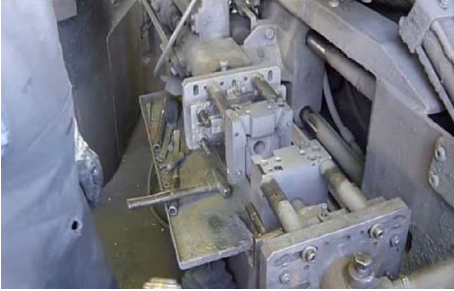
الشكل (a 7-3) تهيئة القالب
