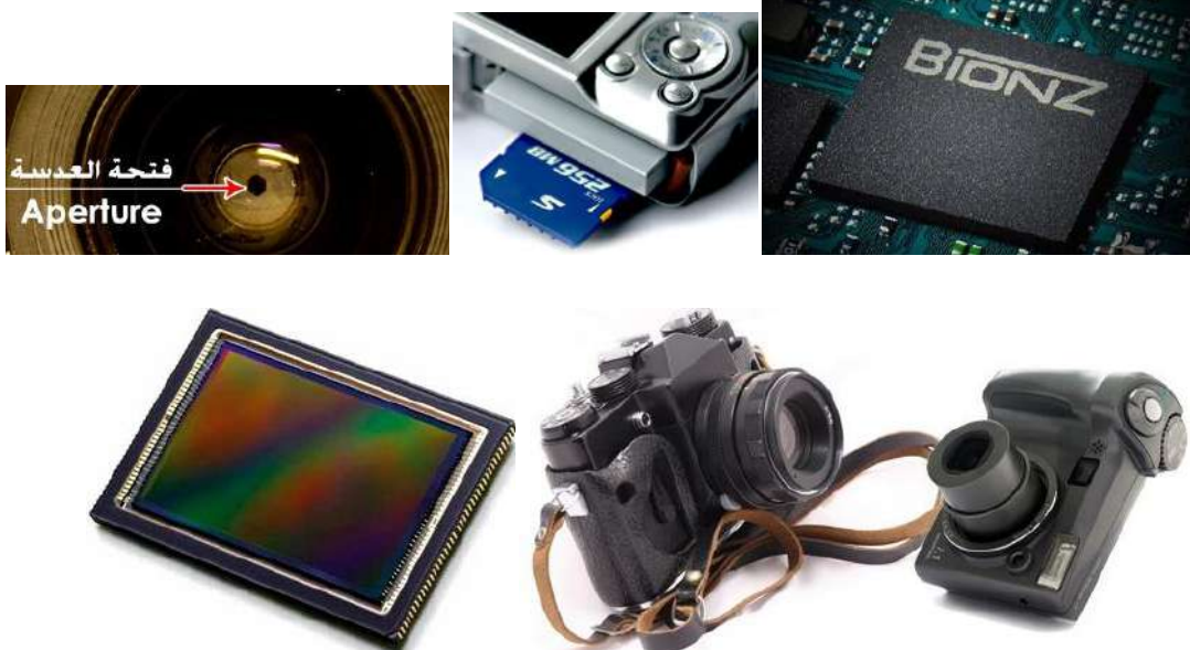
الشكل ( 5 - 20 ) مكونات الكاميرا الرقمية
