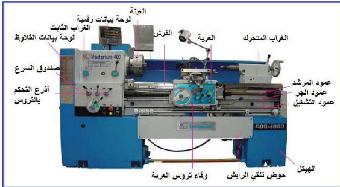
الشكل (٢-١) ماكينة الخراطة وأجزائها
