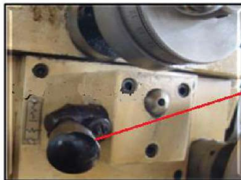
الشكل (1-4) الخراطة الطولية باستخدام الحركة الآلية للعربة.
