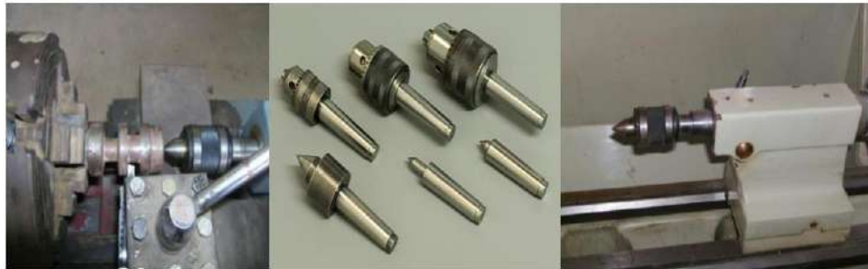
الشكل (١-٧) أجزاء الغراب المتحرك وطريقة الإسناد
