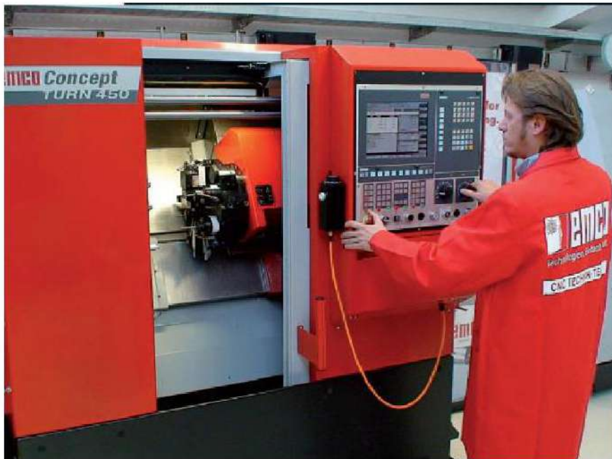
الشكل (5-11) ماكينة الخراطة المبرمجة نوع EMCO موديل TURN 450
