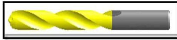
الشكل (5. 3) المثقاب الحلزوني (البريمة)
