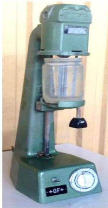
الشكل ( 4 - 5 ) غاسلة الرمال طراز ( PWB )
