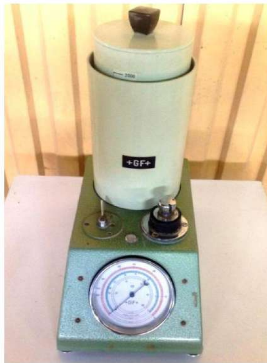
الشكل ( 4 - 6 ) جهاز اختبار نفاذية الغازات طراز ( PDU )
