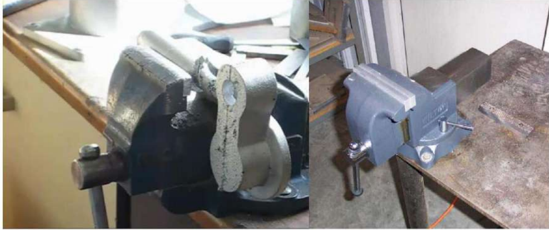
شكل (8-3) تثبيت المسبوكة بواسطة الملزمة
