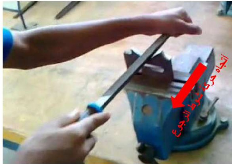
شكل(4-3) شوط الرجوع بالمبرد
