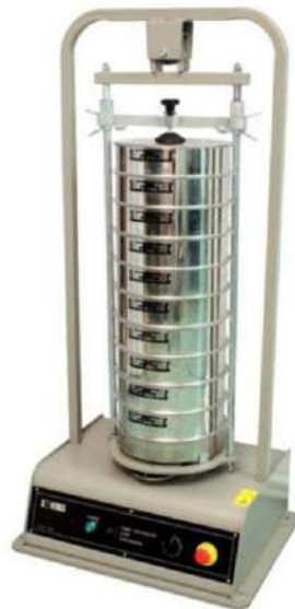
الشكل ( 4 - 2 ) جهاز الغربلة الهزاز
