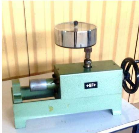
الشكل ( 4 - 8 ) جهاز اختبار المتانة العام طراز ( PFG )
