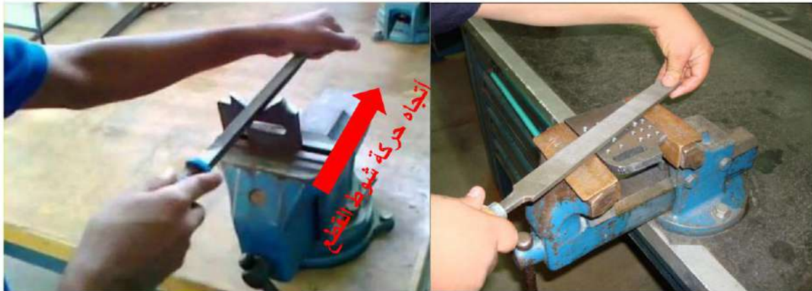
شكل رقم (2-3) مبدأ عمل المبرد
