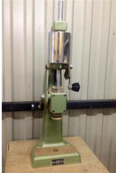
الشكل ( 4 - 3 ) جهاز دك الرمال طراز ( PRA )
