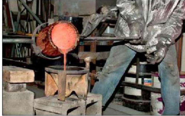
الشكل (14-1) بودقة أثناء الصب
