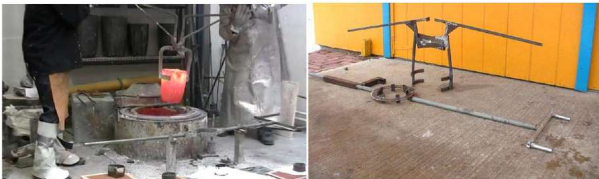
شكل ( 5-17 ) الصب بالبواق المحمولة يدوياً
