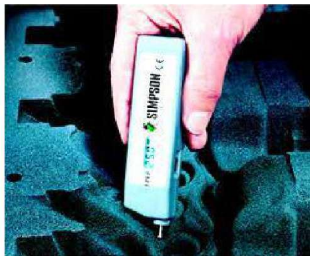
الشكل ( 4 - 9 ) جهاز اختبار صلادة القالب الرمي
