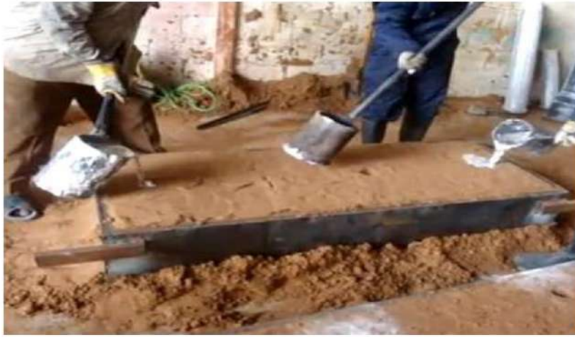
الشكل ( 7 - 3 ) الصب في ارضية المسبك
