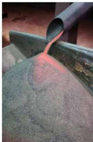
الشكل 4-8 يبين طريقة تفتيت القوالب الرملية بعد الصب
