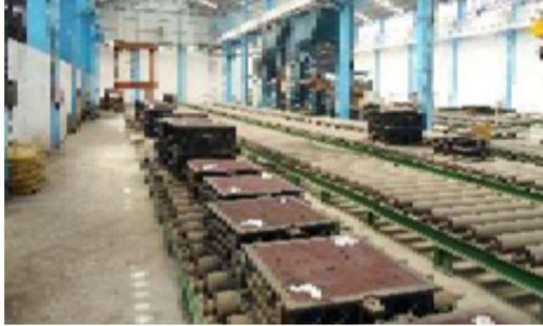
الشكل 4-5 يبين طريقة نقل القوالب الرملية آليا
