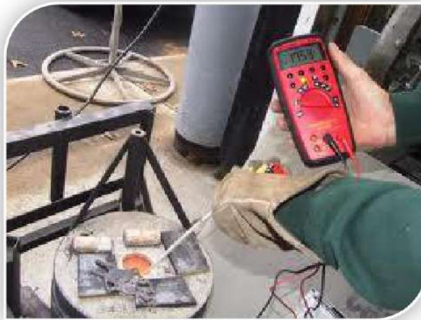
الشكل 2-2 جهاز قياس درجة الحرارة بالمقاومة الكهربائية
