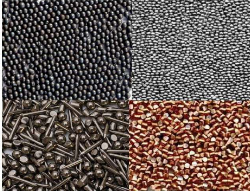
الشكل ( 5-31 ) يوضح المواد المعدنية المستعملة بطريقة العصف
