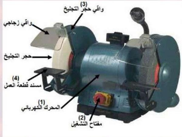
الشكل (4-9) أجزاء ماكينة التجليخ الثابتة
