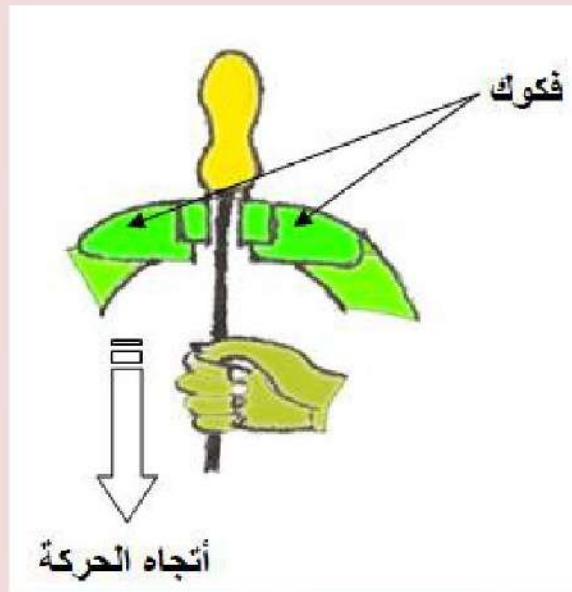
الشكل ( 14-7 ) طريقة خلع المبرد من القبضة .
