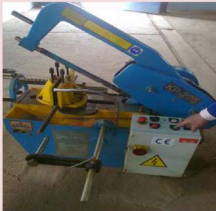
الشكل (6-6) أجزاء المنشار الترددي
