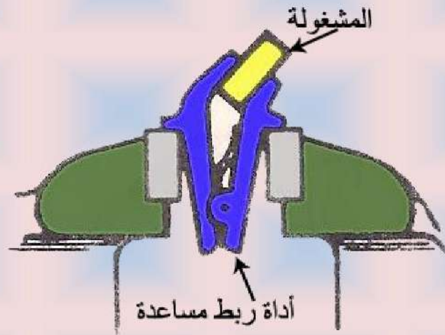
الشكل (7-18) عمل السطح المائل باستخدام أدوات مساعدة.
