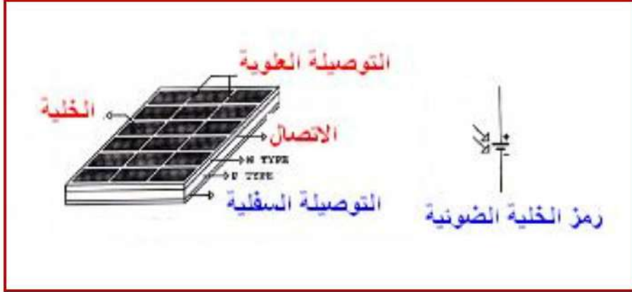
الشكل ( 1 – 2 ) تركيب الخلية الكهروضوئية ورمزها
