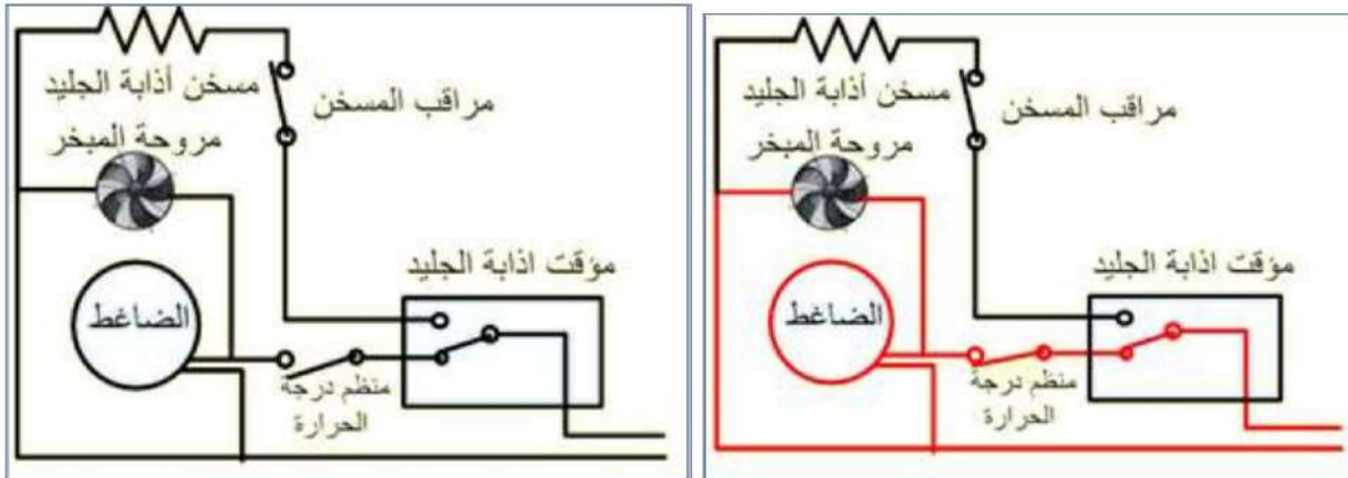
شكل 8-15 عمل الضاغط ومروحة المبخر ومؤقت إذابة الجليد
