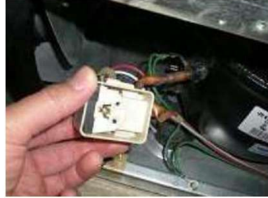
ت- ارفع المنظومة الكهربائية الصلبة
