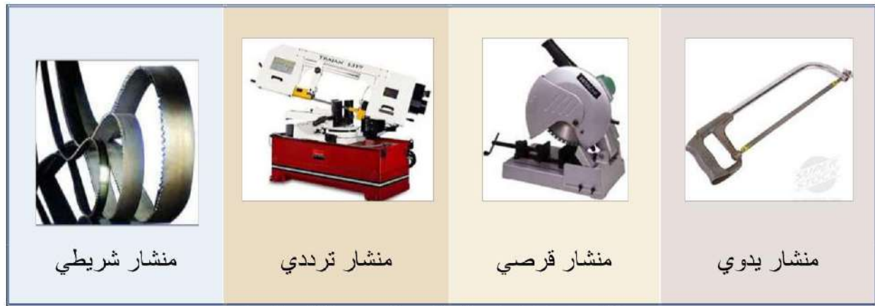
شكل 1-22 أنواع المناشير المستعملة في الورش
