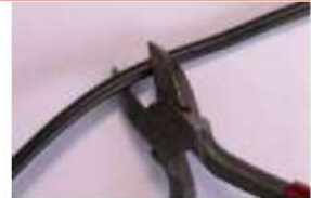
أ- اقطع السلك الكهربائي
