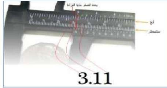
شكل 9-1 طريقة قياس الأقطار الخارجية
