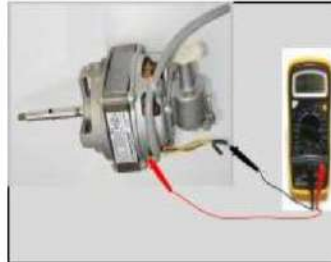
ح- افحص طرفي الملف خ- افحص أحد أطراف السلك مع الجسم د- افحص الطرف الثاني مع الجسم شكل 8-24 عملية فتح وفحص مروحة مكثف مبرد بالهواء القسري
