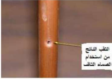
ج- لف عتلة الصمام باتجاه عقرب الساعة ح- الثقب الناتج من تركيب الصمام الثاقب شكل 7-25 عملية تركيب صمام ثاقب على أنبوب نحاسي ( ج , ح )
