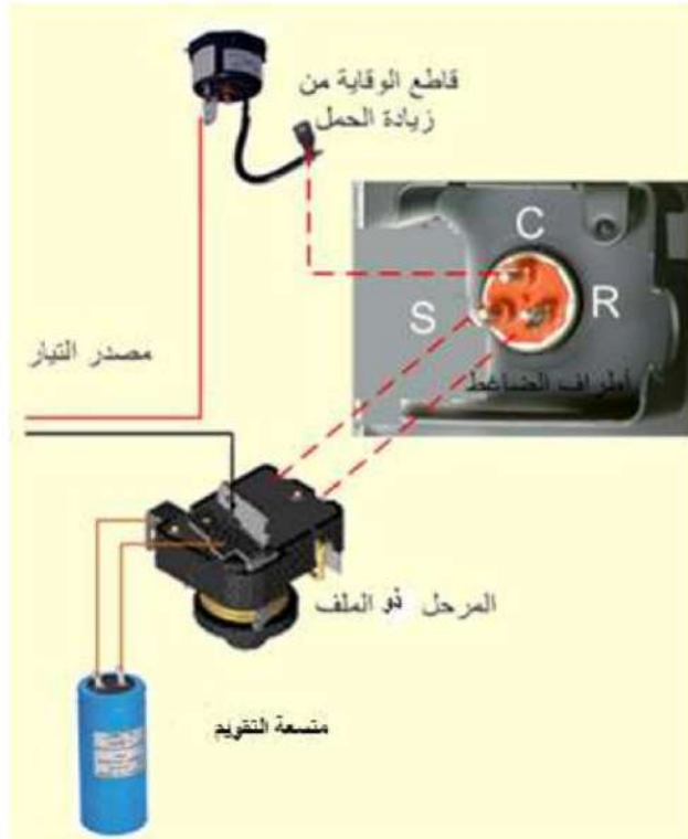
شكل 8-10 الربط الكهربائي لمتسعة التقويم في الضاغط المغلق
