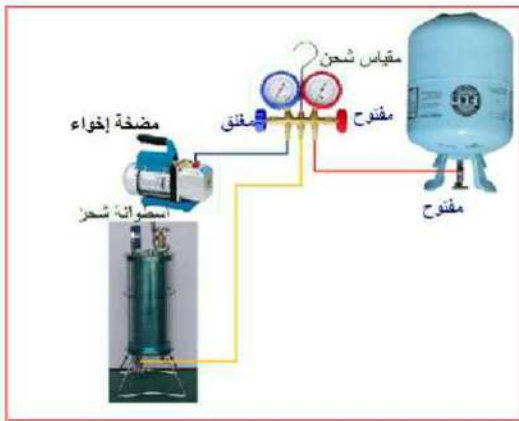
شكل 7-37 طريقة شحن أسطوانة الشحن
