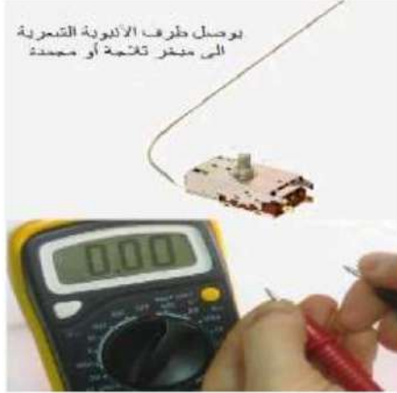
ح- استعمال المقياس متعدد الأغراض للفحص
