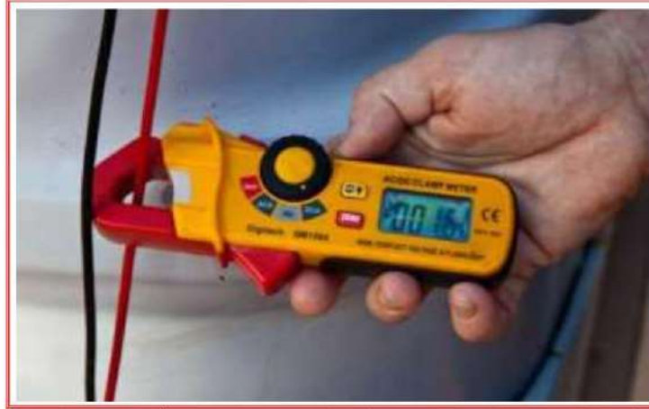
شكل 6-12 طريقة قياس التيار باستعمال المقياس متعدد الأغراض ذي الفك المتحرك
