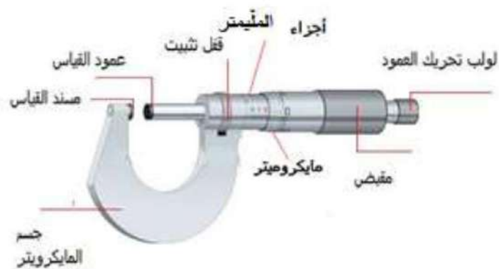
شكل 1-14 مكونات المايكروميتر
