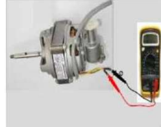
ح- افحص طرفي الملف خ- افحص أحد أطراف السلك مع الجسم د- افحص الطرف الثاني مع الجسم شكل 8-24 عملية فتح وفحص مروحة مكثف مبرد بالهواء القسري
