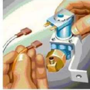
تسزغ الأسلاك الكهربائية
