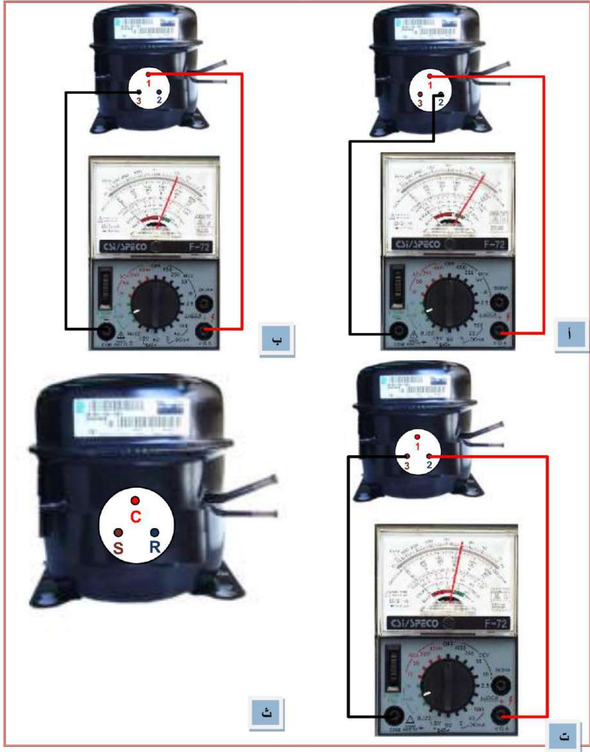
شكل 7-7 طريقة تحديد أطراف ضاغط الثلاجة
