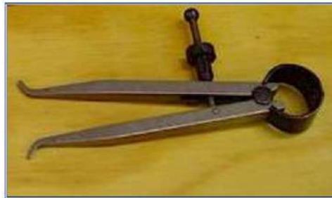
شكل 1-5 الفرجال الداخلي، يستعمل لنقل الإبعاد الداخلية
