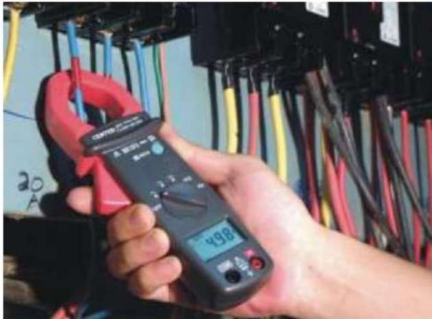
شكل 6-13 طريقة قياس التيار باستعمال المقياس متعدد الأغراض ذي الفك المتحرك
