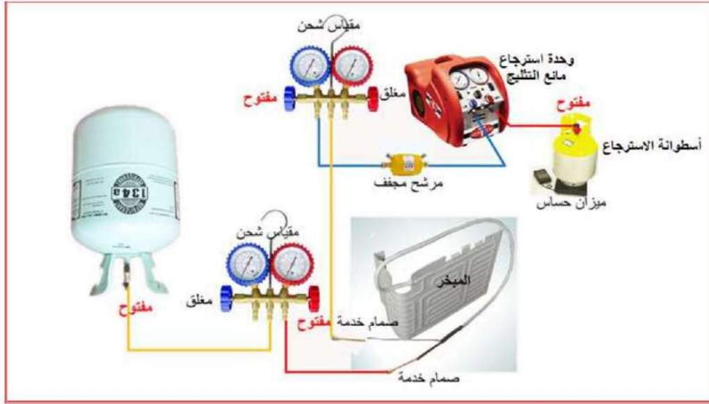
شكل 7-20 طريقة ربط المبخر بأسطوانة مائع التثليج ووحدة إعادة واستصلاح الموائع لإجراء عملية التنظيف
