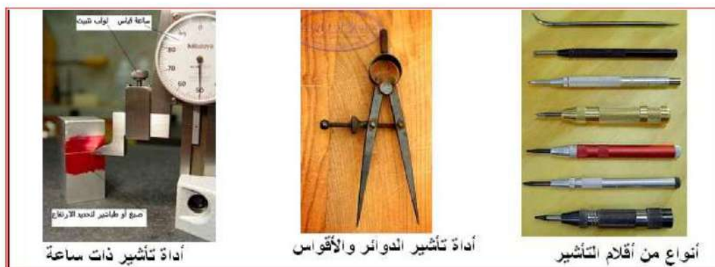
شكل 19-1 بعض العُدَد المستعملة في تأشير القطع المعدنية
