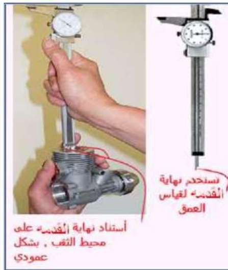
شكل 12-1 قياس العمق بواسطة القدمة
