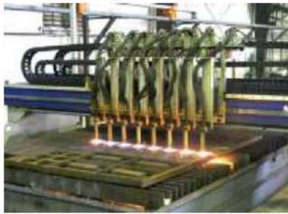
ث- عربة ميكانيكية تستعمل للقطع
