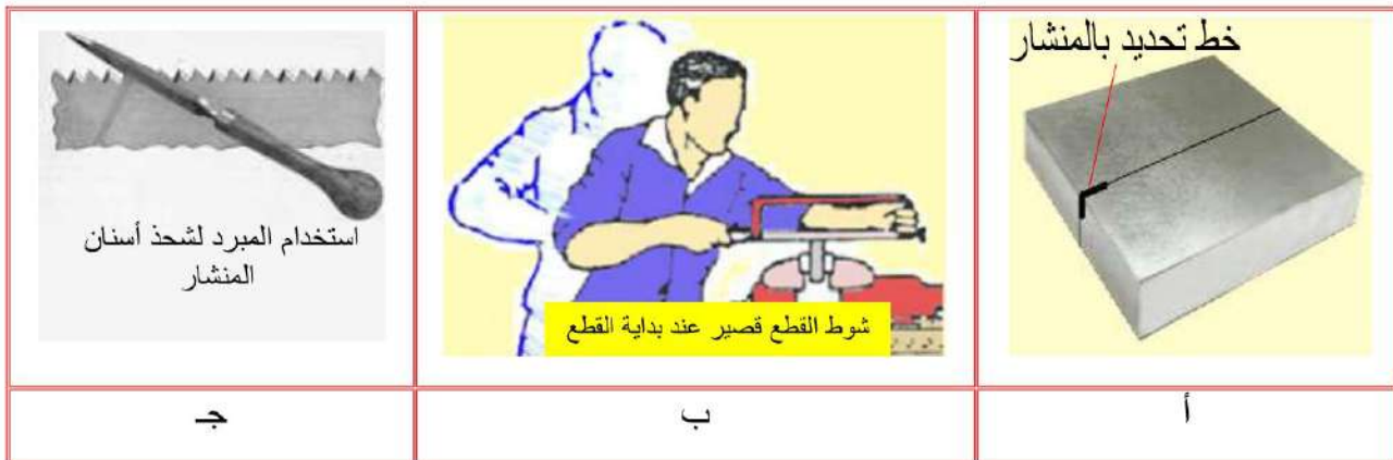
شكل 24-1 بداية عملية النشر وحد أسنان سلاح المنشار
