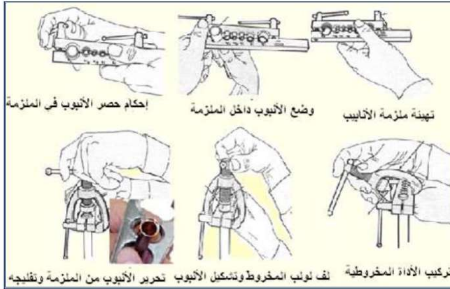
شكل 2-17 طريقة تفلج الأنابيب
