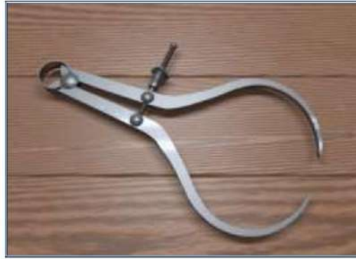
شكل 1-3 الفرجال الخارجي ، يستعمل لنقل الإبعاد الخارجية
