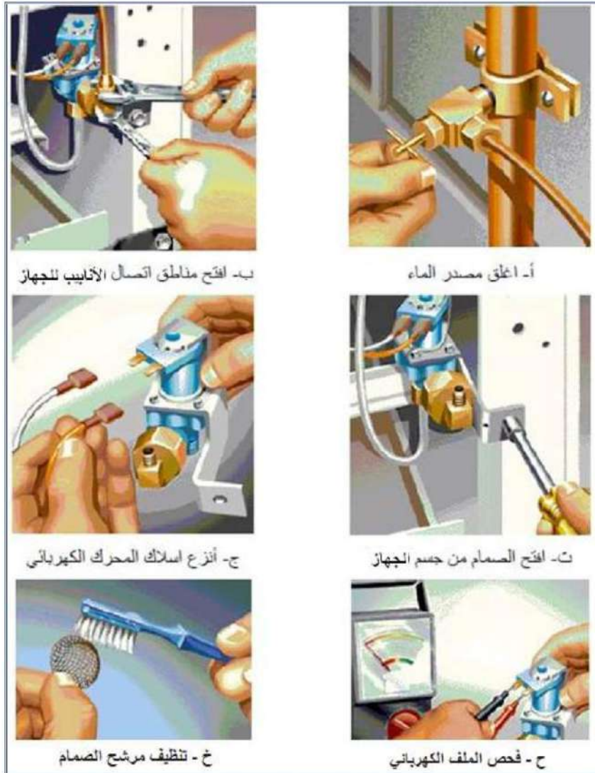
شكل 29-8 طريقة صيانة صمام ماء صناعة الثلج
