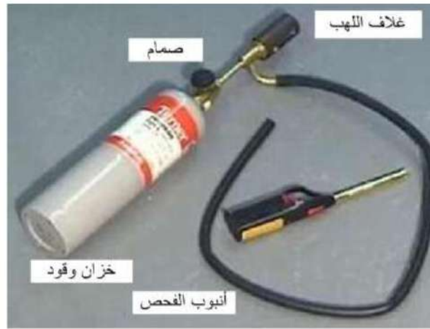
شكل 3-4 مشعل الهاليد لفحص تسرب موائع التثليج الهالوكاربونية
