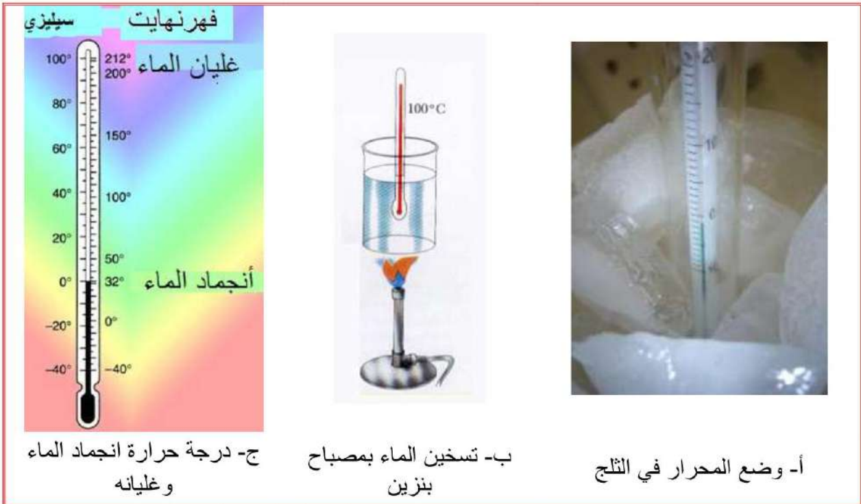
شكل 6-28 قياس درجتا حرارة انجماد الماء المقطر و غليانه
