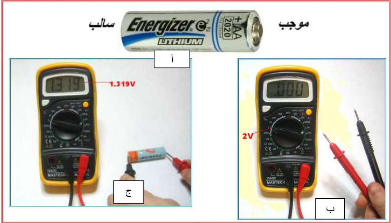
شكل 5-6 قياس بطارية سعة 1.5 فولت
