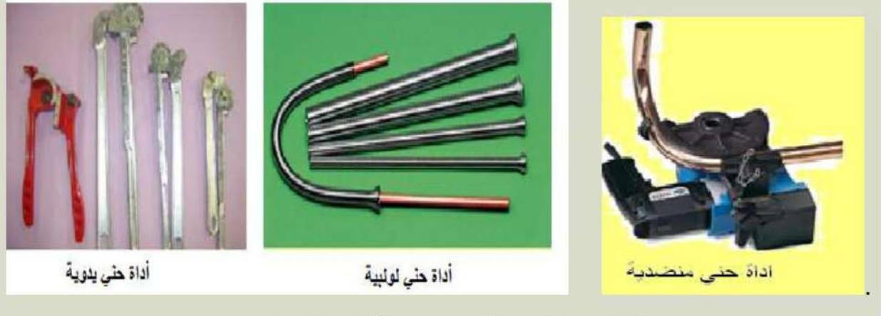
شكل 2-11 أنواع أدوات حني الأنابيب النحاسية
