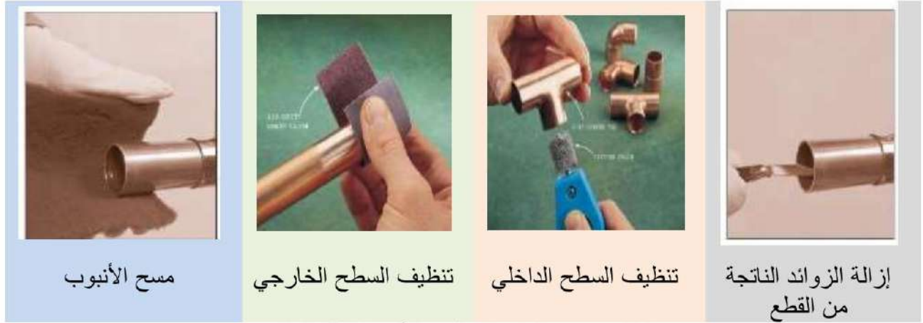
شكل 3-5 عمليات التنظيف الأربع للقطع الملحومة
