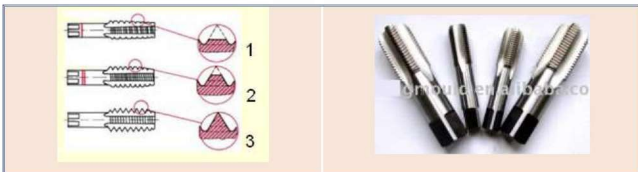
شكل 1-35 عدة أنواع من القلاووظ ويتضح فيه التدرج في استعمال القلاووظ
