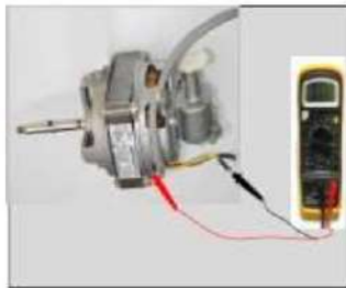
ح- افحص طرفي الملف خ- افحص أحد أطراف السلك مع الجسم د- افحص الطرف الثاني مع الجسم شكل 8-24 عملية فتح وفحص مروحة مكثف مبرد بالهواء القسري
