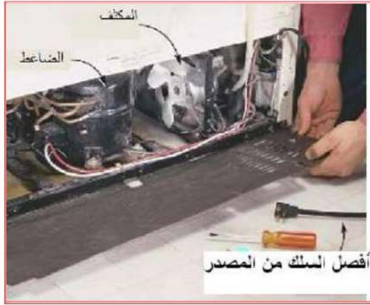
أ- فتح شباك التهوية في مقدمة الثلاجة ب - فتح الغطاء الخلفي للثلاجة شكل 7-14 تنظيف المكثف المبرد بالهواء القسري
