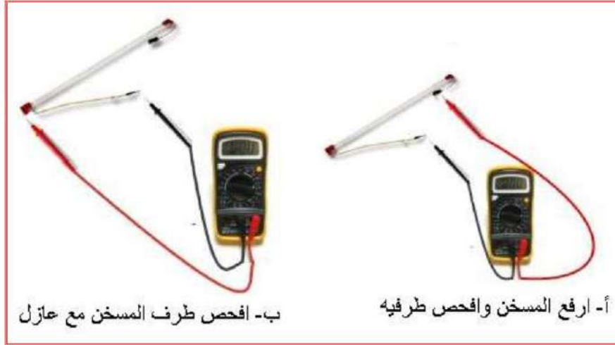
شكل 8-34 طريقة فحص المسخن الكهربائي لماكينة صنع الثلج
