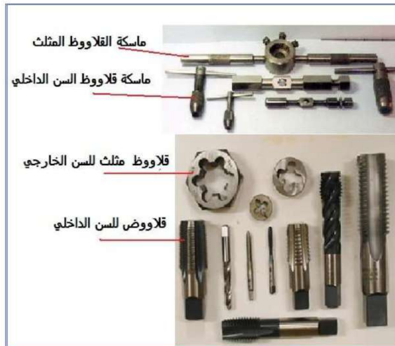
شكل 1-37 العُد المستعملة في التسنين الداخلي والخارجي.
