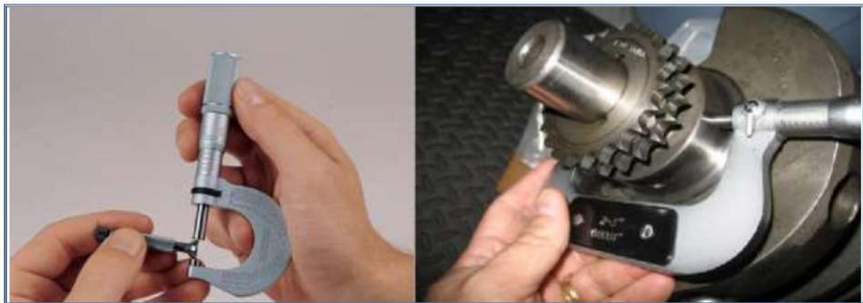
شكل 1-15 قياس الأقطار الكبيرة والصغيرة بواسطة المايكروميتر
