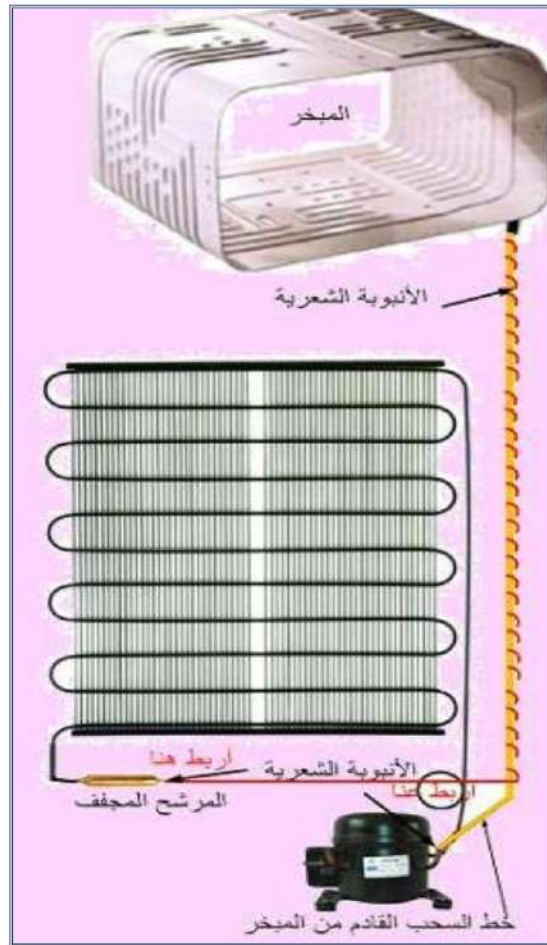
شكل 7-19 طريقة ربط أطراف المبخر بخط السحب للضاغط وطرف الأنبوبة الشعرية
