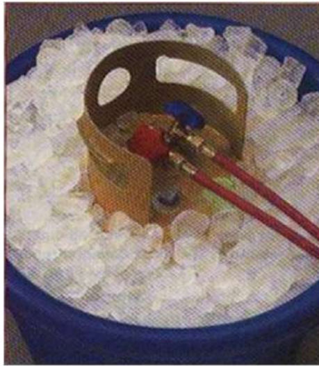
عملية إعادة تأهيل بخار مائع التثليج غمر أسطوانة إعادة تأهيل البخار في الثلج شكل 7- 27 طريقة إعادة تأهيل بخار مائع التثليج
