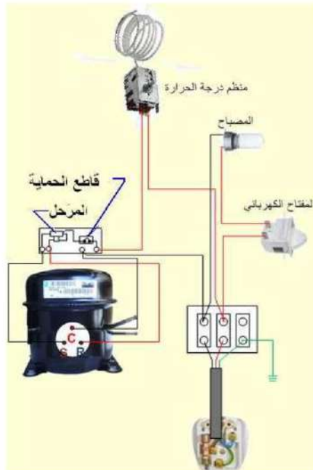
شكل 1-8 الدائرة الكهربائية للثلاجة المنزلية
