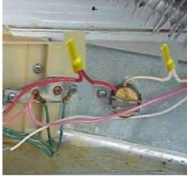
أ- فتح المسيطر ب- فحص المسيطر ج- ربط المسيطر بعد فحصه أو تبديله شكل 8-19 طريقة فحص المسيطر على مسخن إذابة الجليد وتبديله
