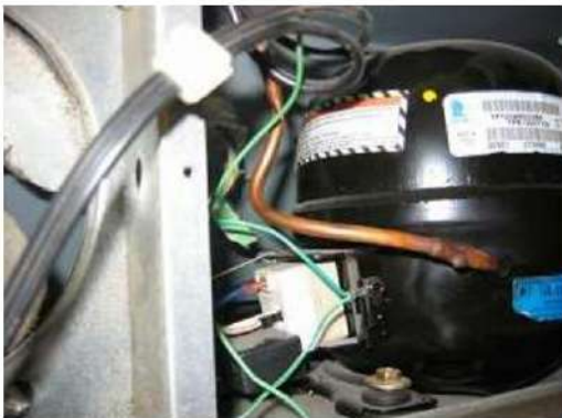
ب- ارفع غطاء اللوحة الكهربائية للضاغط
