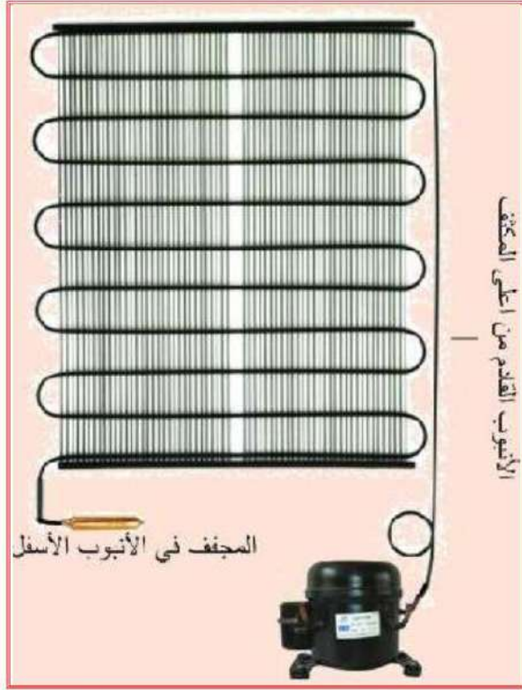
شكل 7-15 ب طريقة تثبيت المكثف الجديد في الثلاجة
