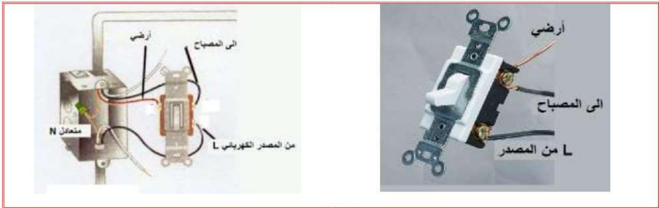
شكل 5-15 طريقة ربط مفتاح ذي ممر واحد
