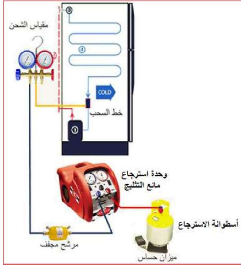
شكل 7- 26 ربط وحدة استرجاع بخار مائع التثليج
