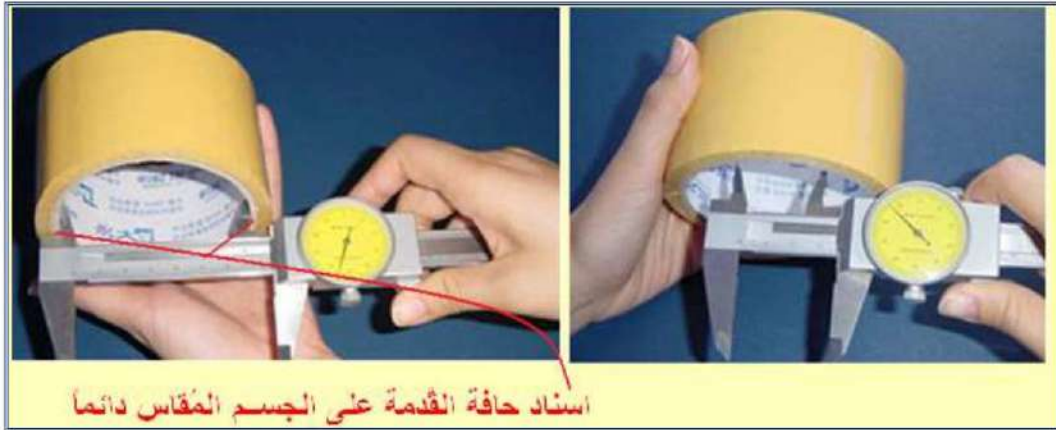
شكل 11-1 قياس الأقطار الداخلية بواسطة القدمة
