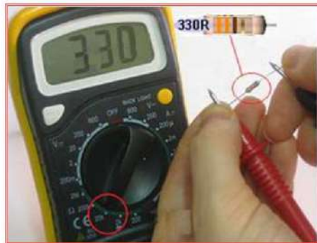
شكل 6-11 طريقة قياس المقاومة، لاحظ مؤشر المقياس
