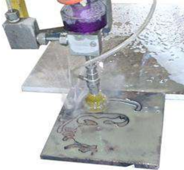
ماكينة قطع الزجاج بواسطة تيارات الماء النفاثة
