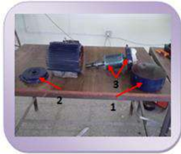
شكل (2-19) تفكيك محرك حتي ثلاثة أطوار
