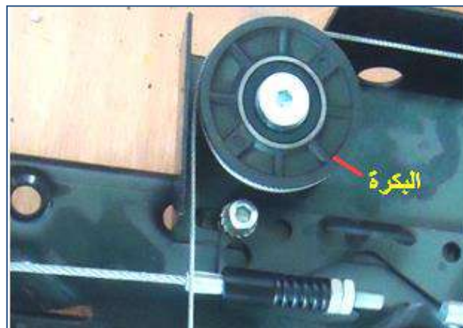
شكل (1 - 28) فحص صلاحية بكرة توجيه الحبل
