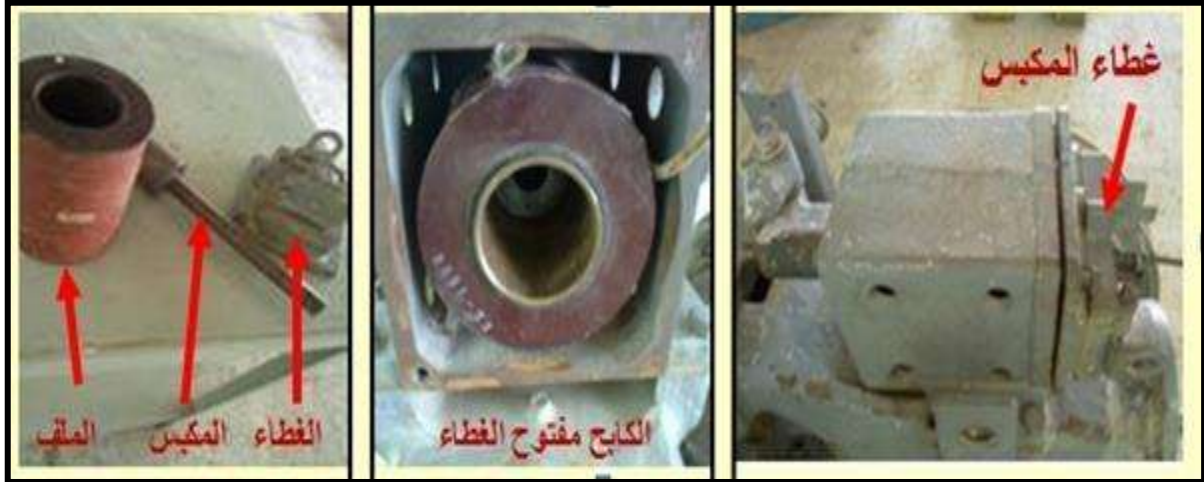
شكل (1 - 53) ج تفكيك أجزاء الكابح
