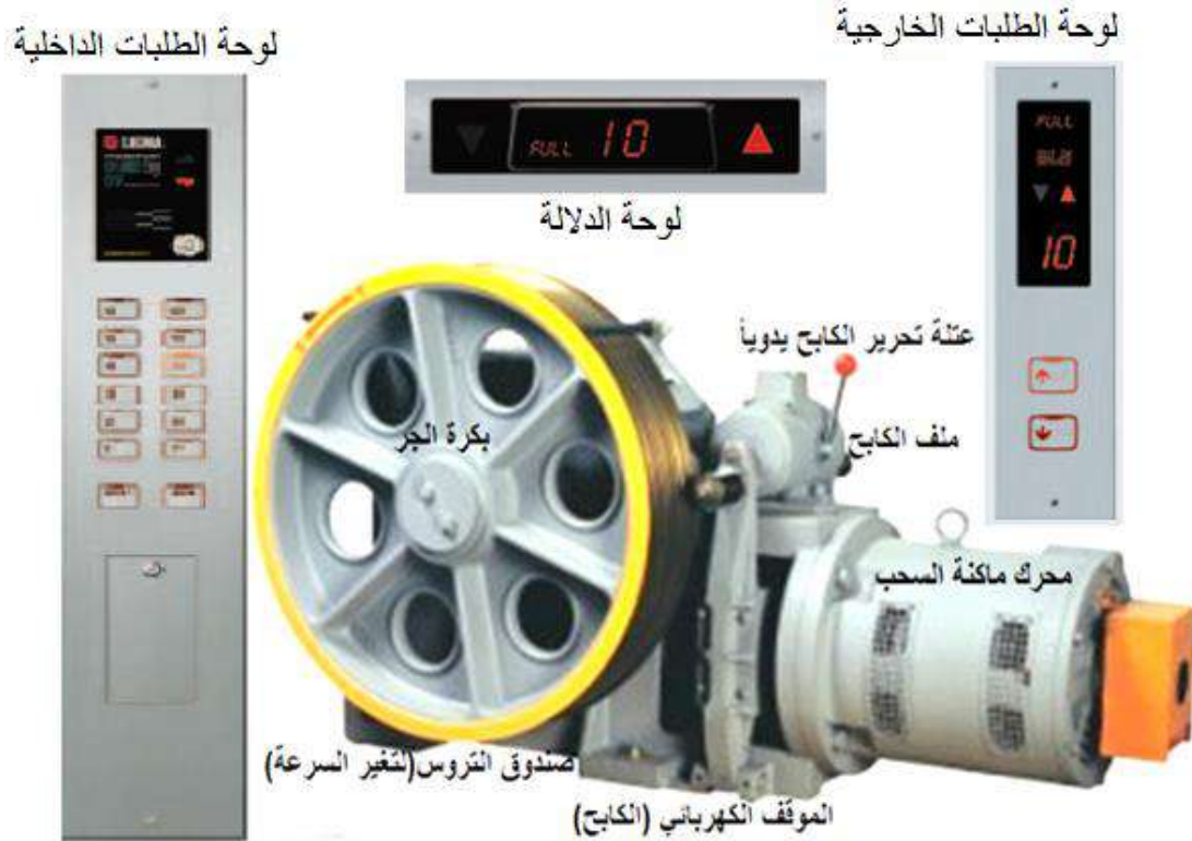
شكل (3-7) ماكينة السحب مع ملف الكابج ومفاتيح الصعود والنزول الخارجية والداخلية
