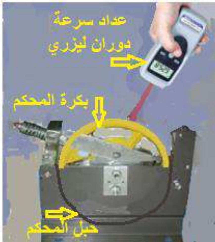
شكل (1 - 51) قياس عدد الدورات بكرة محكم السرعة
