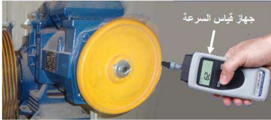
شكل (1 - 45) قياس سرعة دوران ماكينة السحب باستخدام جهاز قياس السرعة (Tachometer)
