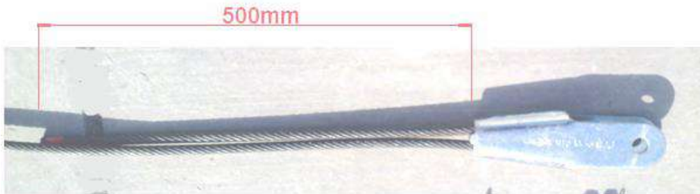
شكل (1 - 7) سحب جانبي الحبل بقوة لإدخال الحاصرة داخل الكشتبان
