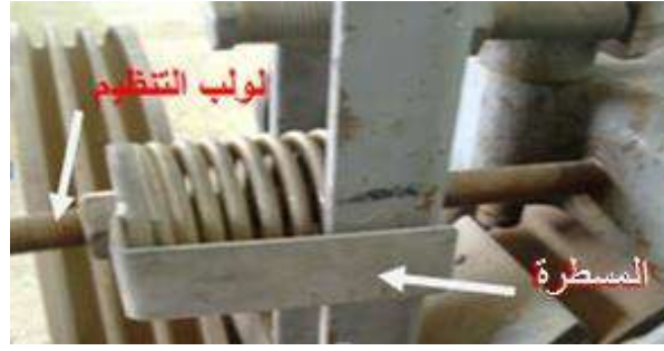
شكل (1 - 54) فتح لولب ومسطرة التنظيم للكابح
