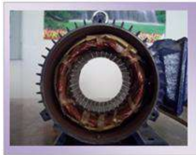
شكل (2-20) الجزء الثابت لمحرك ثلاثة أطوار
