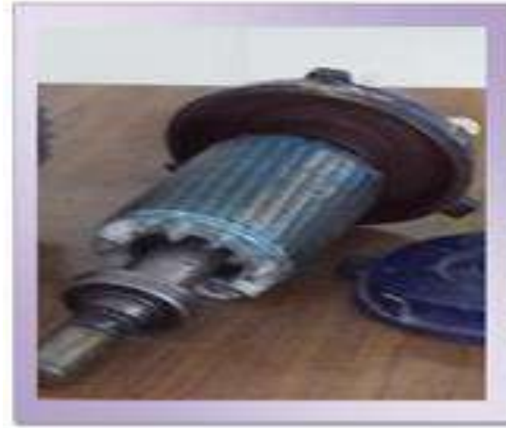
شكل (21-2) الجزء الدوار نوع قفص سنجابي
