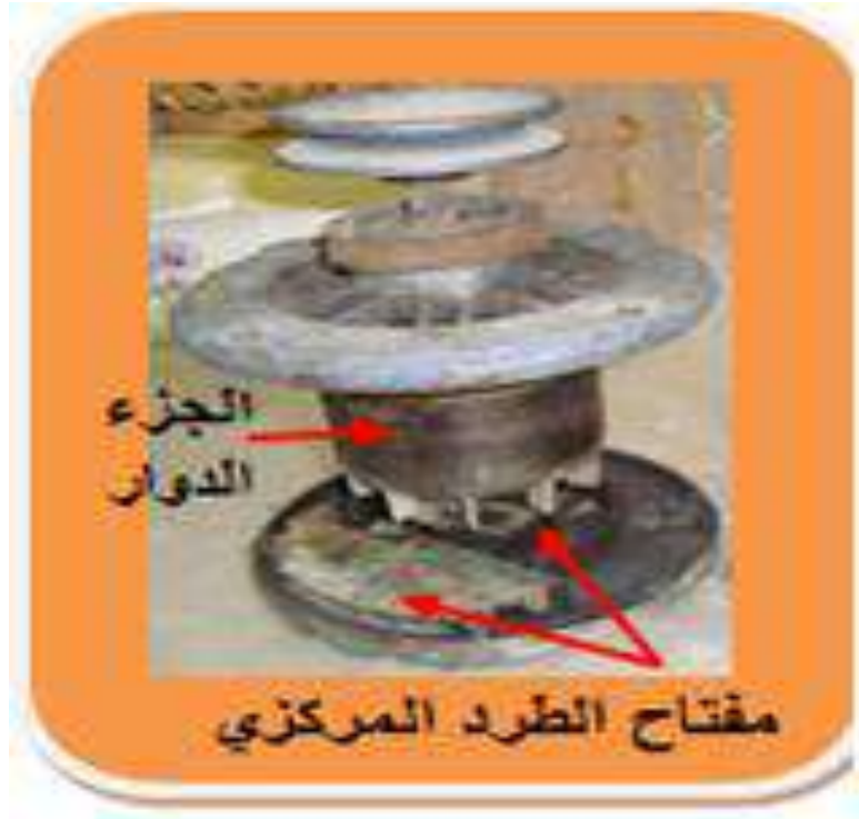
شكل (14-2) الجزء الدوار لمحرك حثي طور واحد
