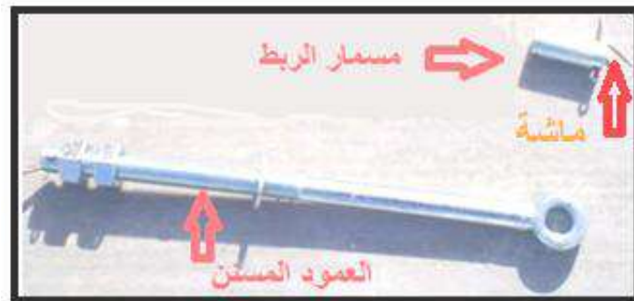
شكل (1 - 4) إخراج المسمار الرابط للعمود المسنن
