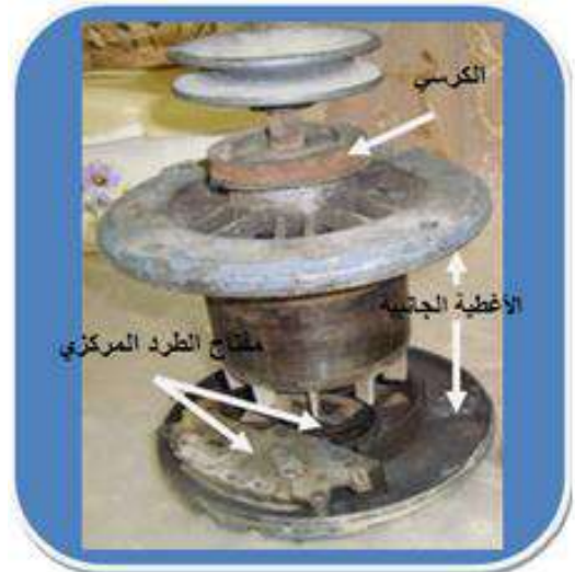
شكل (9-2) الأغشية الجانبية للجزء الدوار المقصور
