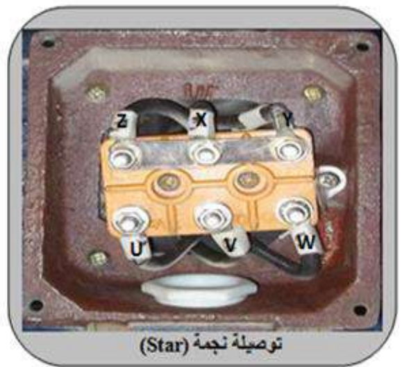
شكل (2-17) توصيل الأطراف النهائية للمحرك الثلاثي الأطوار (الحتي)
