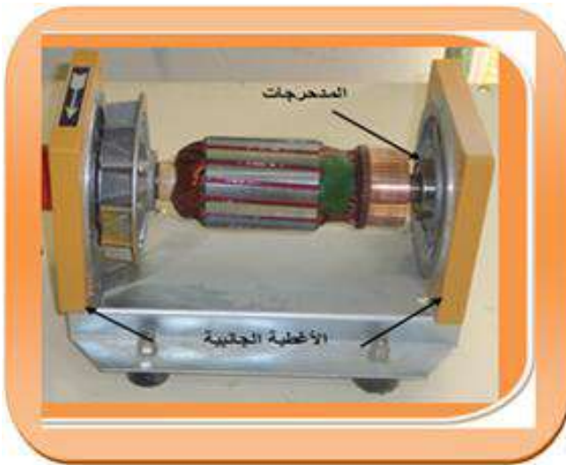
شكل (10-2) الأغشية الجانبية للجزء الدوار الملفوف
