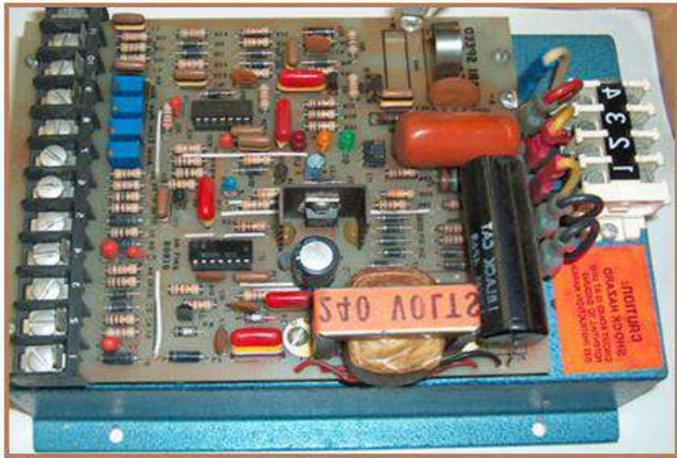
الشكل (5-1) عدد من عناصر الكترنيات القدرة في دائرة الكترونية لمحرك ماكينة إنتاجية
