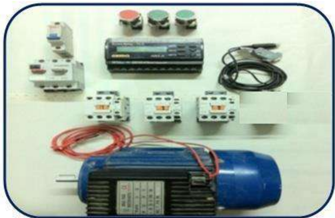
شكل (6-42) تثبيت عناصر الدائرة الكهربائية الخاصة بالتمرين
