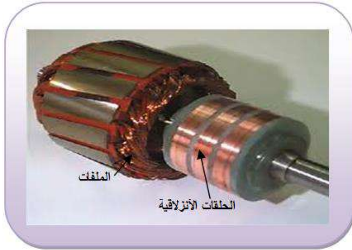
شكل (2-16) الجزء الدوار ذو الحلقات الأنزلاقية
