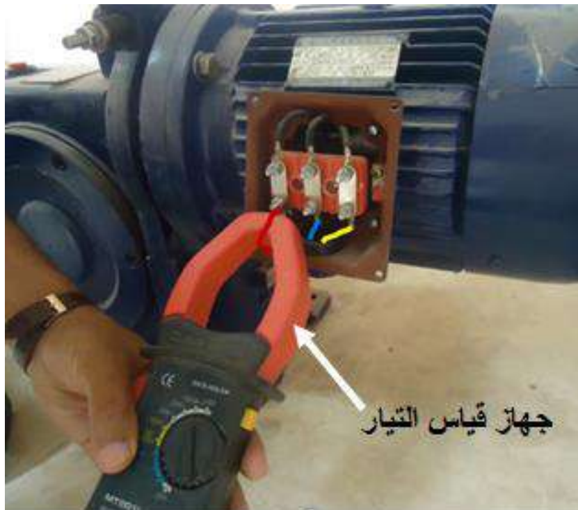
الشكل (1 - 43) ربط جهاز قياس التيار (Clamp meter) مع أحد الأطوار في دائرة المحرك
