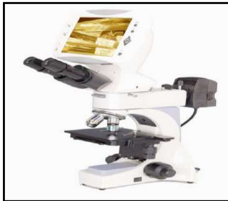
الشكل (18): يوضح المجهر الضوئي المستعمل لقياس قطر الثقب
