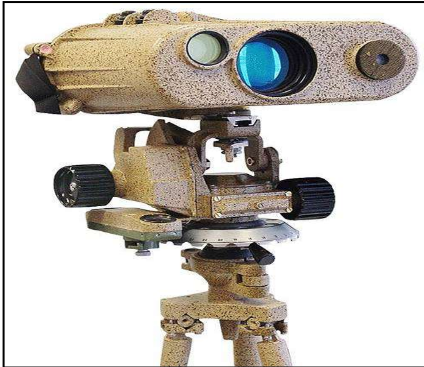
الشكل (28): جهاز مقدرة المدى الليزرية المستعمل في التطبيقات العسكري
