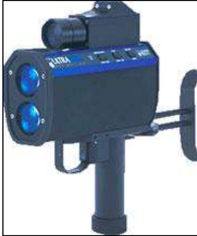
الشكل (35): الجهاز المستعمل لقياس سرعة السيارات بأشعة الليزر
