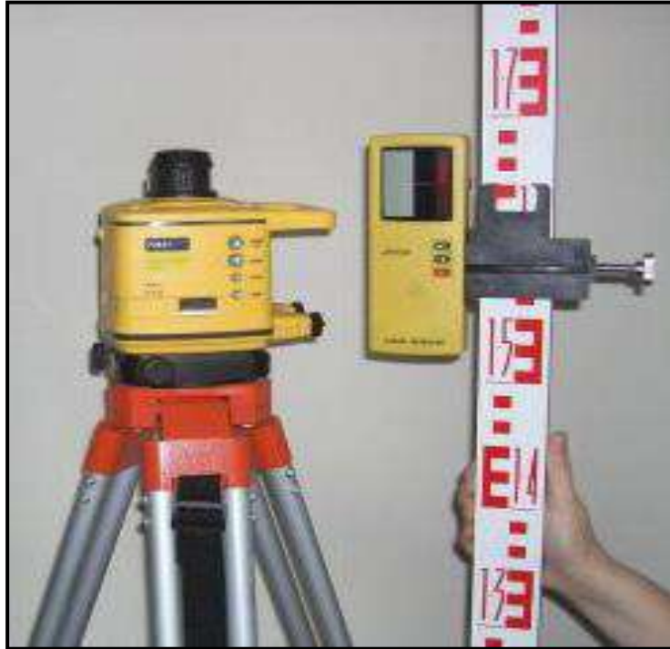
الشكل (34): جهاز يستخدم اشعة الليزر للكشف عن استوائية الاسطح
