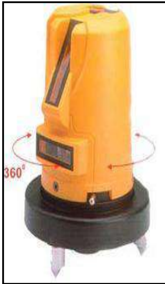
الشكل (31): جهاز كروس ليزر 6100 المستعمل في التجربة
