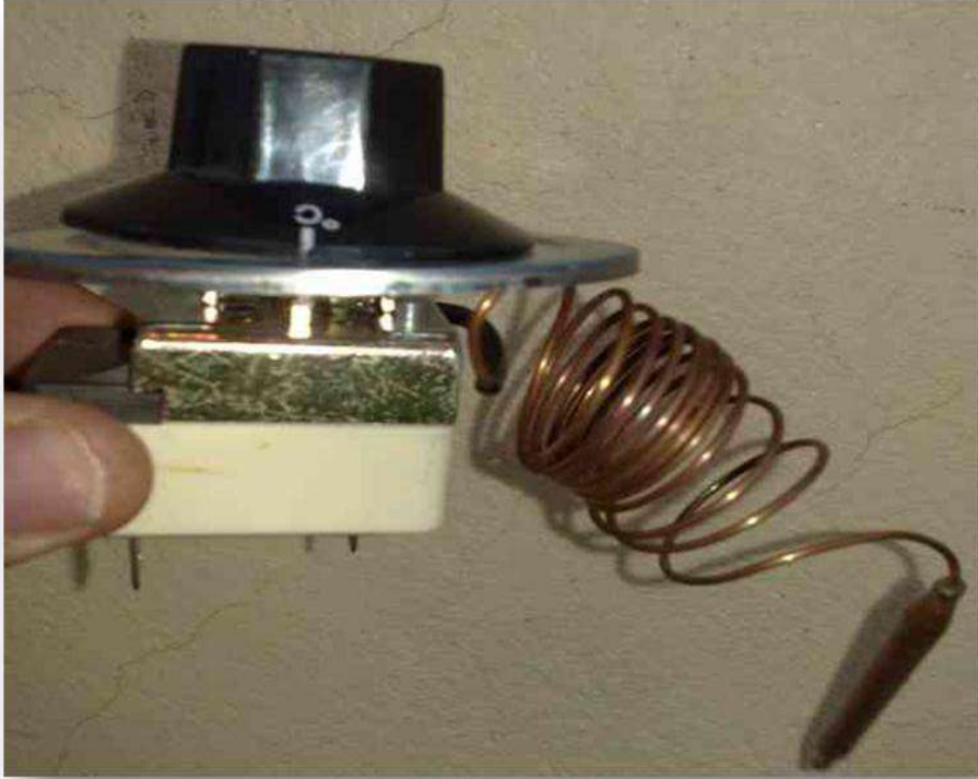
شكل رقم (3-3) يوضح شكل منظم الحرارة (الثرموستات) الميكانيكي
