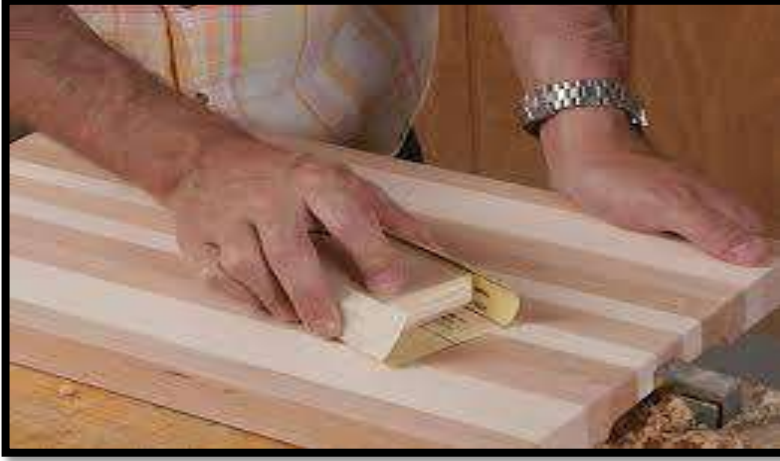
الشكل (1-62) يوضح بعض عملية السنفرة
