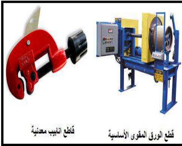
الشكل (8-5) أدوات التقطيع الآلية
