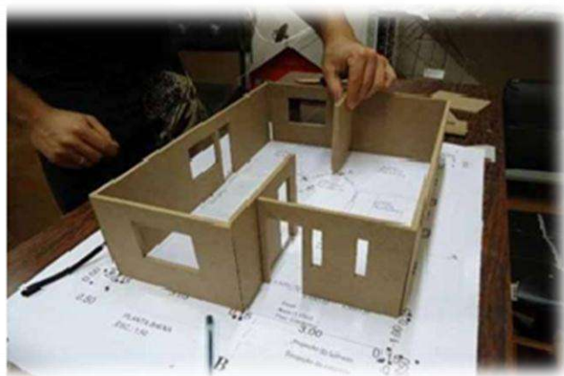
الشكل (5-34) استخدام المسامير الرفيعة في سند جوانب الجدران
