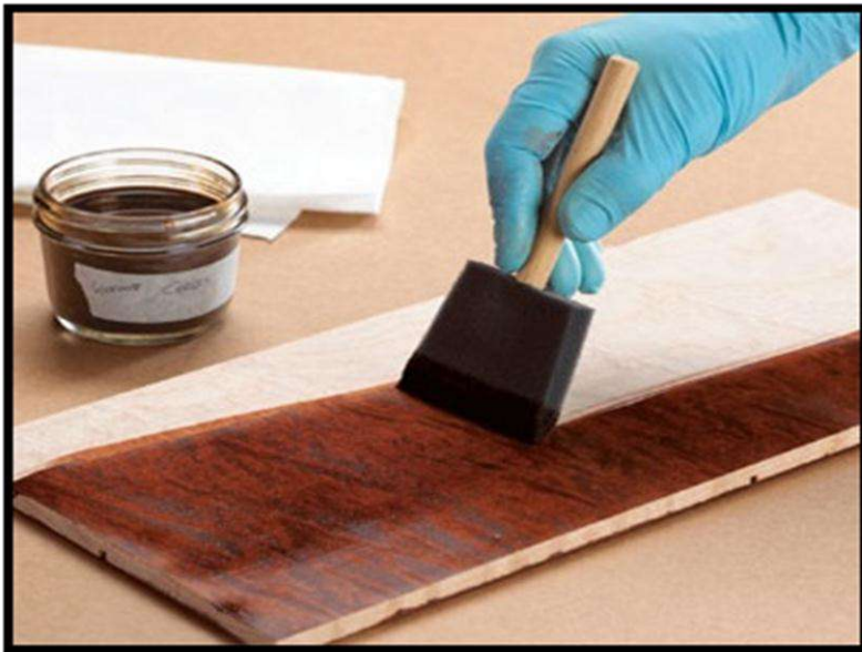
الشكل (1-66). عملية الطلاء بصبغة لونية من الدملوك المذاب بالكحول الصافي
