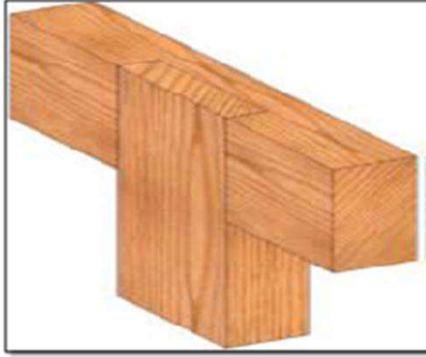
الشكل (37-1) وصلة تنصيف متعامدة
