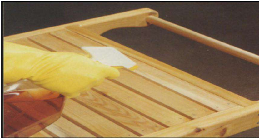
الشكل (1-69) عملية الطلاء بالورنيش
