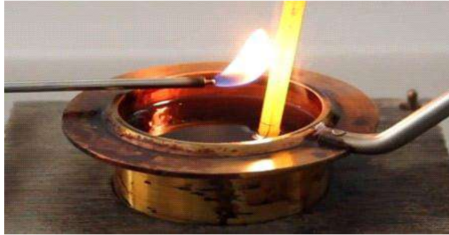
الشكل (20-3) اللهب في جهاز قياس نقطة الوميض
