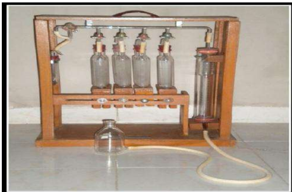
شكل ( 28-3 ) يبين جهاز أورسات وأجزاءه الرئيسية
