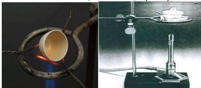
الشكل (3-16) جفنة خزفية (توضح عملية الاحتراق بالمثلث الخزفي)
