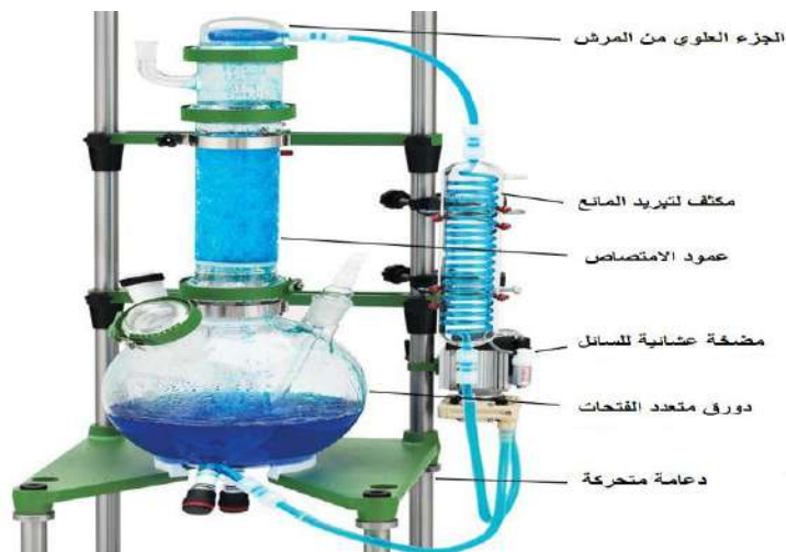
شكل (2-6) منظومة لعملية الامتصاص
