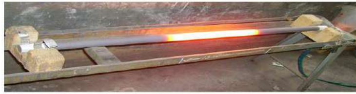
شكل (2-3) الأفران ذات أعمدة التسخين المصنعة من كربيد السيليكون
