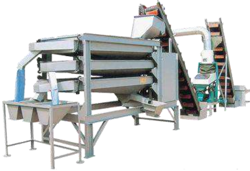
شكل ( 5-6 ) منظومة صناعية لنخل المساحيق
