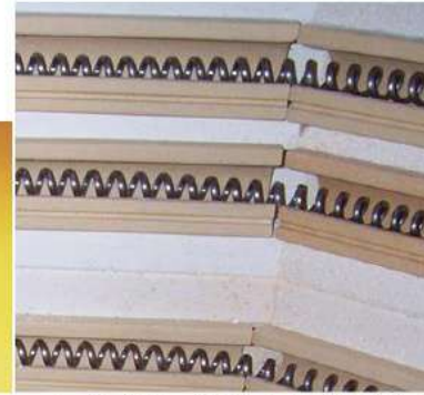
اسلاك التسخين الكنثال داخل الفرن
