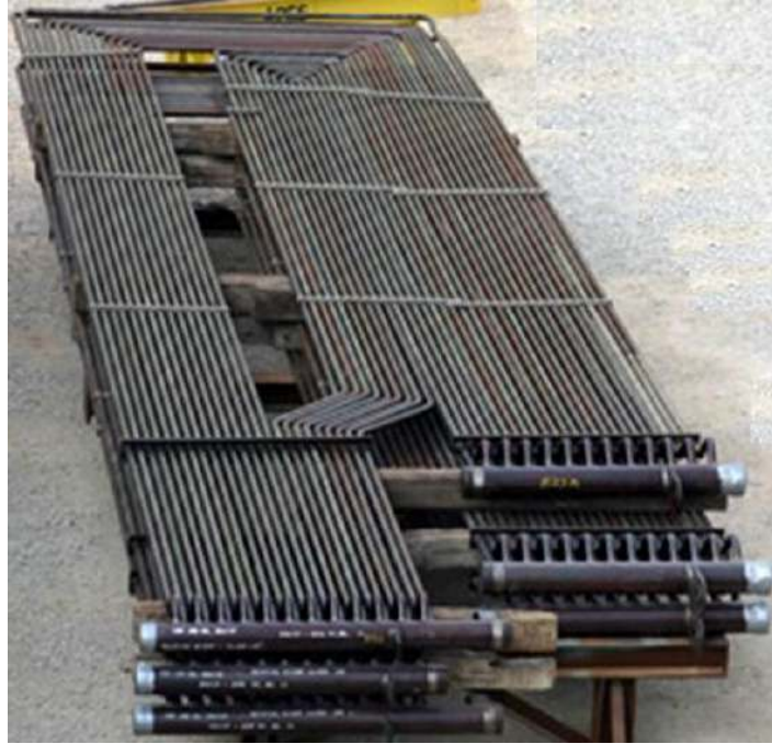
الشكل (13) يوضح مصفوفات أنابيب مهيئة لصنع محمصة بخار في مرجل أنابيب الماء
