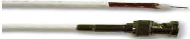
شكل (2 - 4) يوضح الموصلات المحورية الرقيقة المستخدمة في الربط الشبكي 10Base2 مع مقبس الربط BNC
