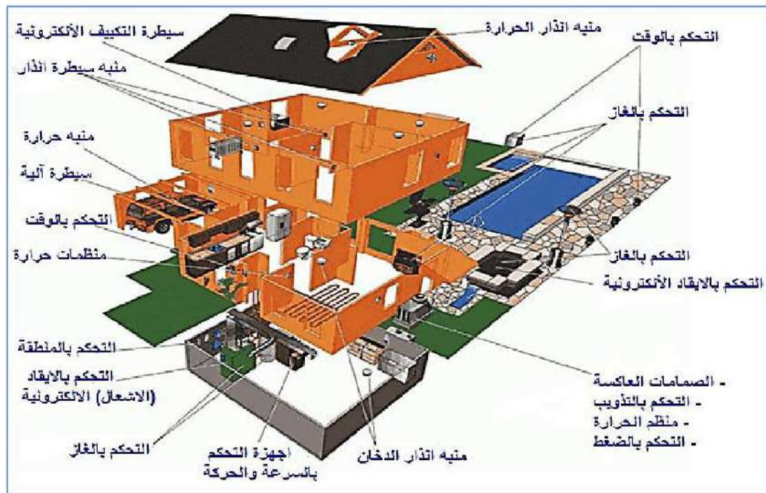
شكل 10-1 يوضح ربط الشبكات المتحسنة اللاسلكية بالأجهزة الكهربائية في البيت الذكي
