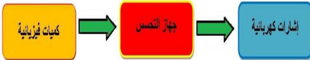
الشكل 1-2 يوضح مبدأ عمل جهاز التحسس
