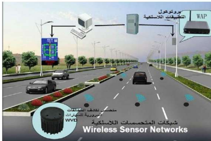
الشكل 4-1 تطبيق الشبكات المتحسنة لتحذير المبكر للسائقين في الطرق السريعة
