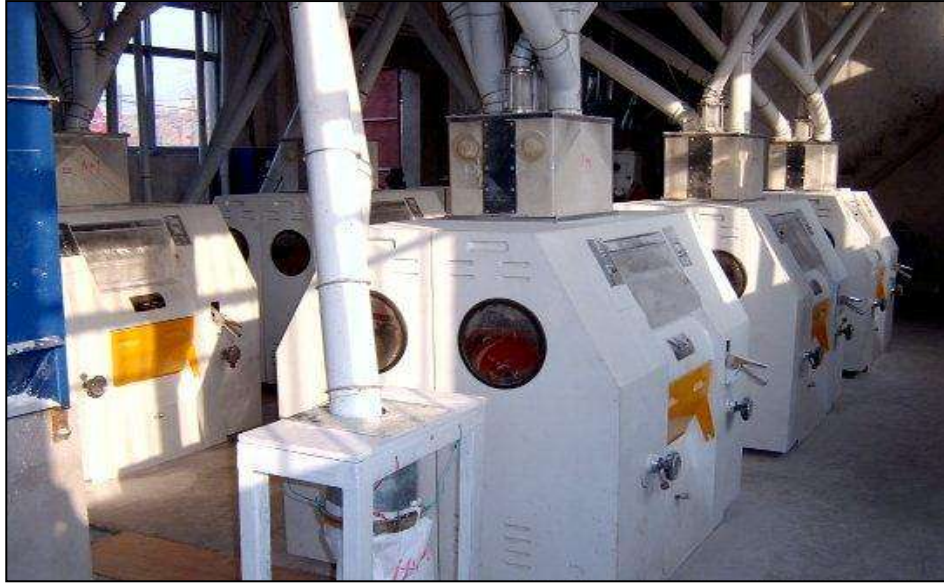
شكل ( 6-12 ) السلندرات داخل المطحن ويتضح وجود شبابيك جانبية لمراقبة عمل السلندرات من الداخل لتجنب أى مشاكل بها
