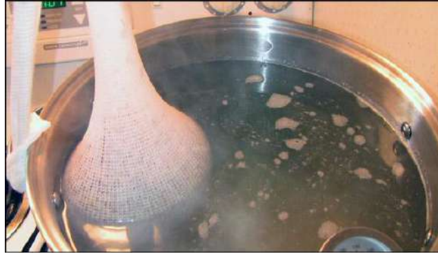
شكل (8-2) ترشيح العصير بواسطة أكياس القماش الناعم
