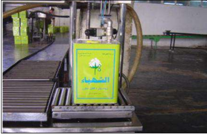
شكل (6-7) تعبئة الدهون المهدرجة في الصفائح المعدنية
