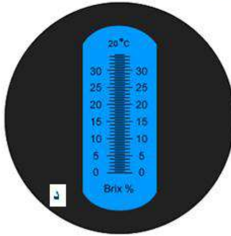
شكل (4-1) كيفية إستخدام الرافراكتوميتر
