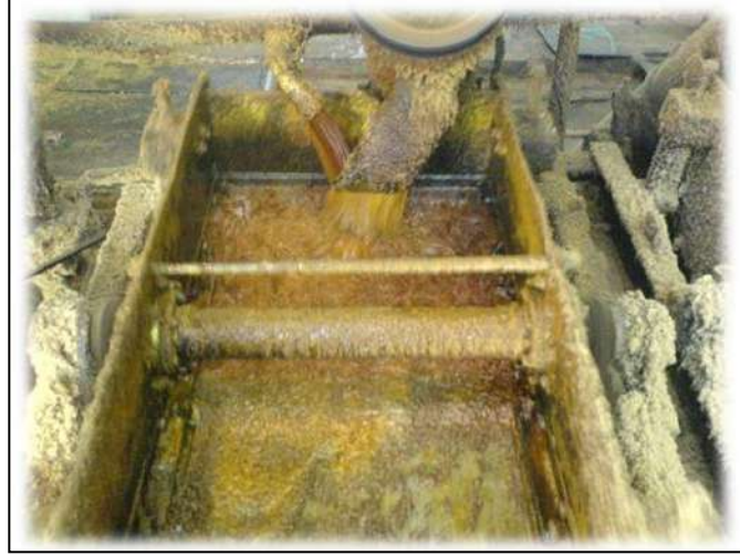
شكل ( 5-6 ) مرحلة تصفية وترشيح الزيت الخام
