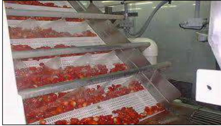
شكل ( 2-4 ) عملية غسل الثمار بواسطة رشاشات الماء
