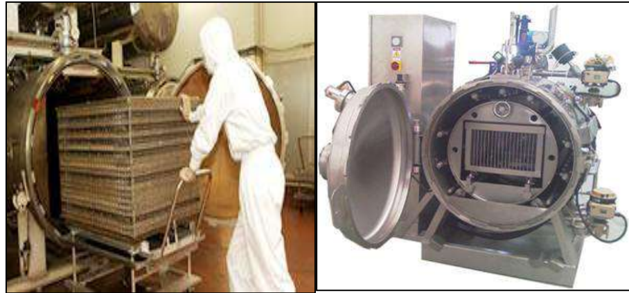
شكل (4-5) وضع الأقفاص الحاوية على الأغذية المعلبة في جهاز التعقيم Retort
