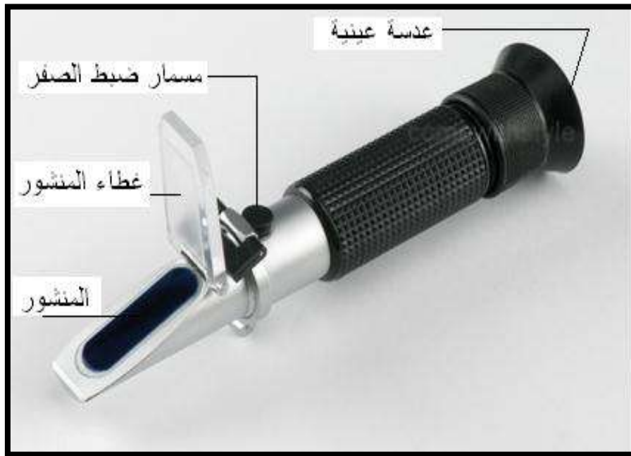
شكل ( 3-1 ) أجزاء الرفراكتوميتر اليدوي
