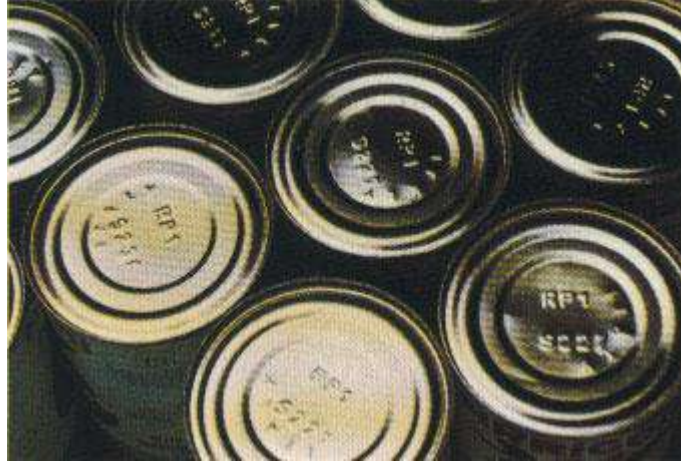
شكل ( 3-5 ) إكمال شكل العلب المعدنية بكبس الاغطية
