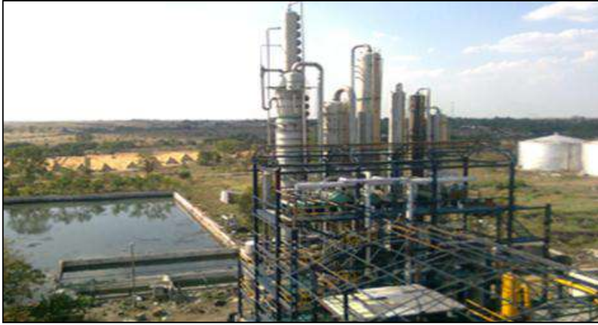
شكل ( 15-6 ) أعمدة تقطير الكحول في المصانع الكبيرة
