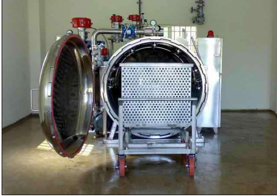
الشكل (4-8) جهاز الموصدة (الأتوكلاف) المستخدم في تعقيم الحليب بالزجاجات
