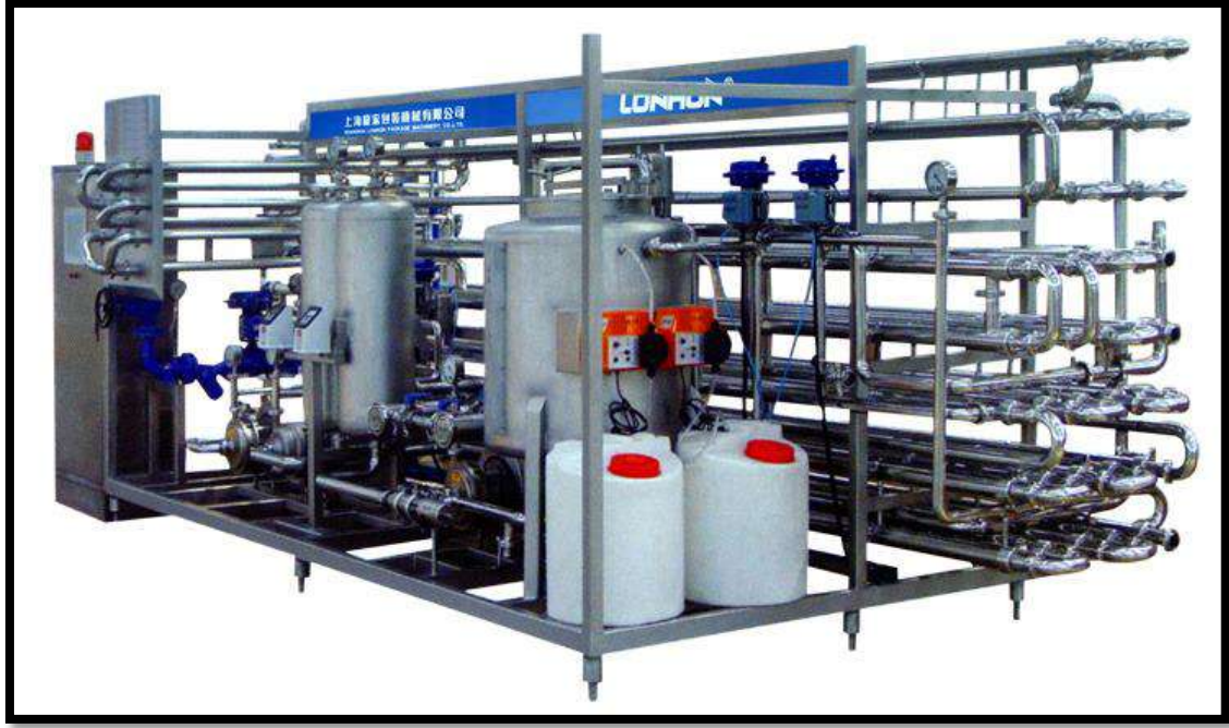
الشكل (6-8) جهاز التعقيم السريع بالحرارة فوق العالية
