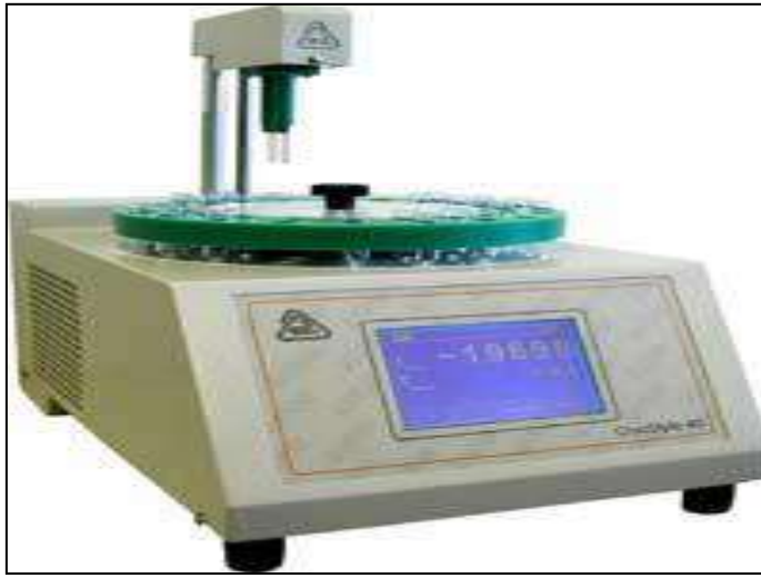
الشكل (1.2) جهاز الـ Fiske cryoscope المستخدم لقياس درجة إنجماد الحليب
