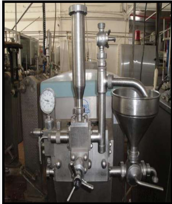
الشكل (6-7) جهاز تجنيس الحليب ومخطط لعملية التجنيس
