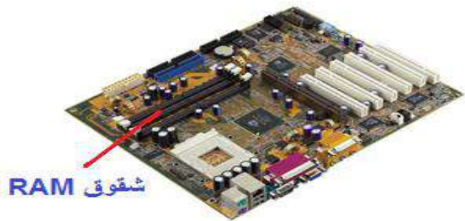
الشكل (6-1) شقوق ذاكرة الوصول العشوائي
