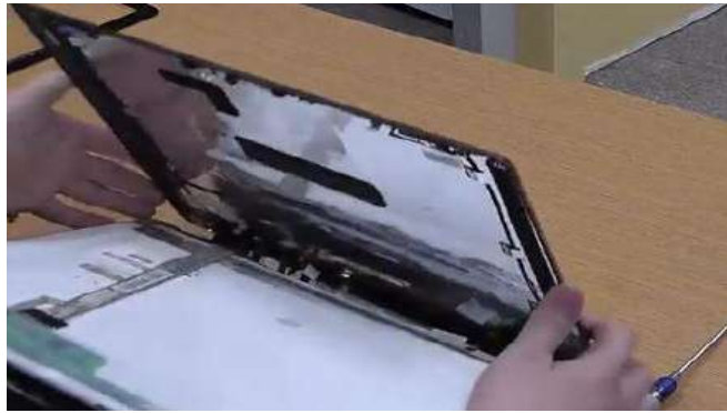
8- افصل كيبيل LCD كما موضح بالشكل الآتي:
