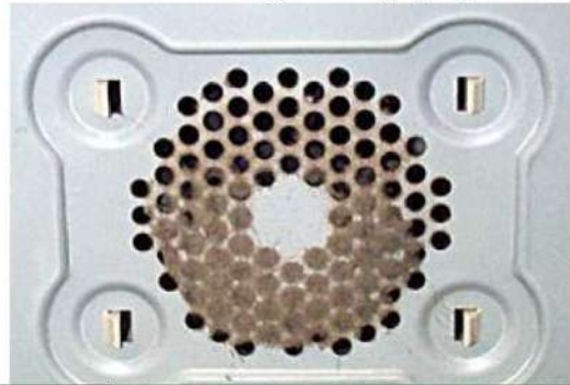
الشكل (24-5) تنظيف فتحات التهوية لمجهز القدرة
