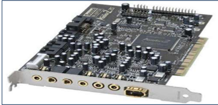
الشكل ( 2 - 2 ) يوضح بطاقة الصوت
