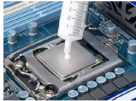
الشكل (7-3) العجينة الحرارية نوع سيلكون
