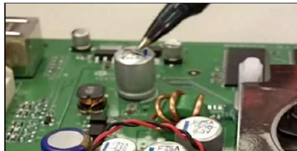
الشكل (4-2) شكل متسعة منتفخة
