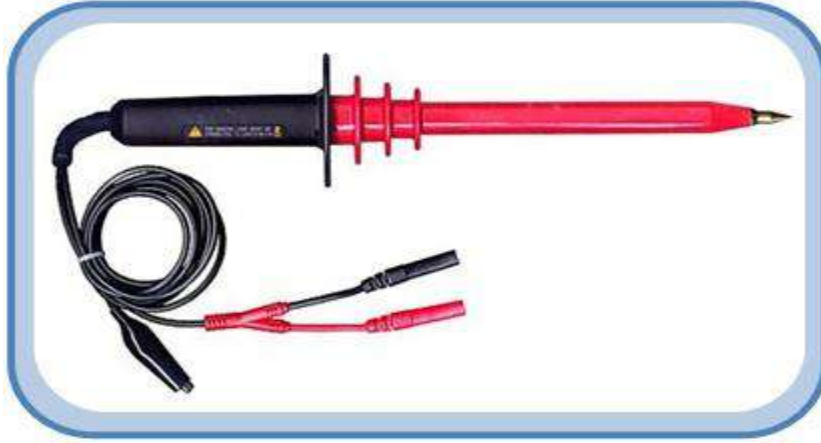
الشكل رقم (3 - 19) مسبار الفولتيات العالية
