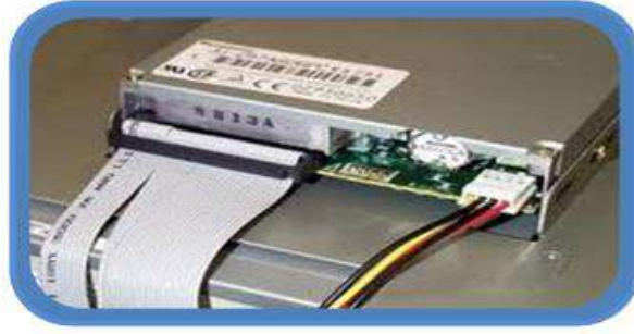
الشكل رقم (1 - 51) يوضح موصلات التغذية والبيانات
