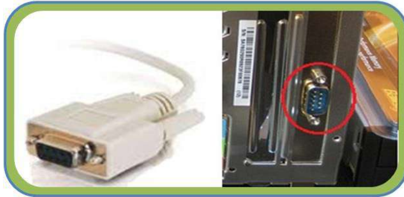
الشكل رقم (4 - 32) موصل من نوع (DB-9)
