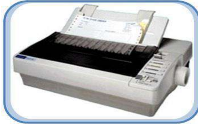
الشكل رقم (3 - 21) يوضح احدى أشكال الطابعة النقطية
