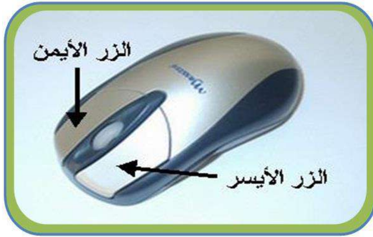
الشكل رقم (4 - 23) يوضح أزرار الفأرة الأيمن والأيسر
