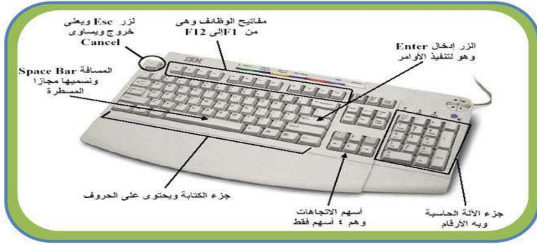
الشكل رقم (4 - 2) يوضح توزيع وظائف المفاتيح
