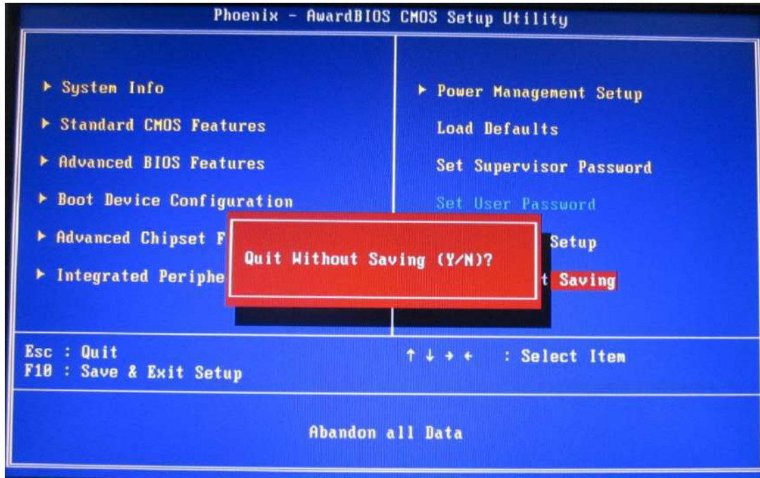
الشكل ( 5 - 100 ) يوضح عملية الخروج بدون حفظ التغييرات
