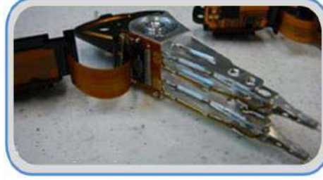
الشكل رقم (1 - 8) الذراع الحامل لرؤوس القراءة والكتابة
