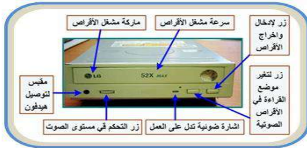
الشكل رقم (1 - 71) شرح تفصيلي عن واجهة سواقة القرص المدمج
