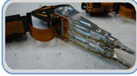
الشكل رقم (1 - 8) الذراع الحامل لرؤوس القراءة والكتابة
