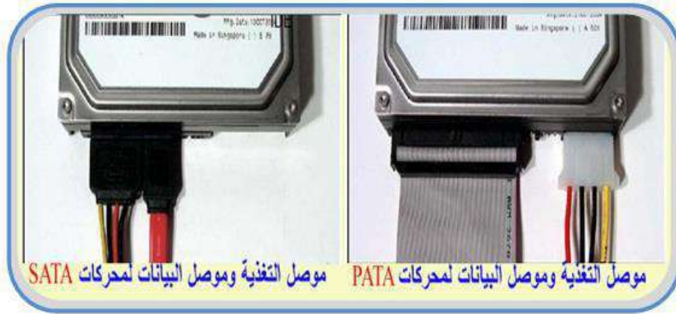
الشكل رقم (1 - 17) يوضح الفرق بين الموصلات (SATA, PATA)
