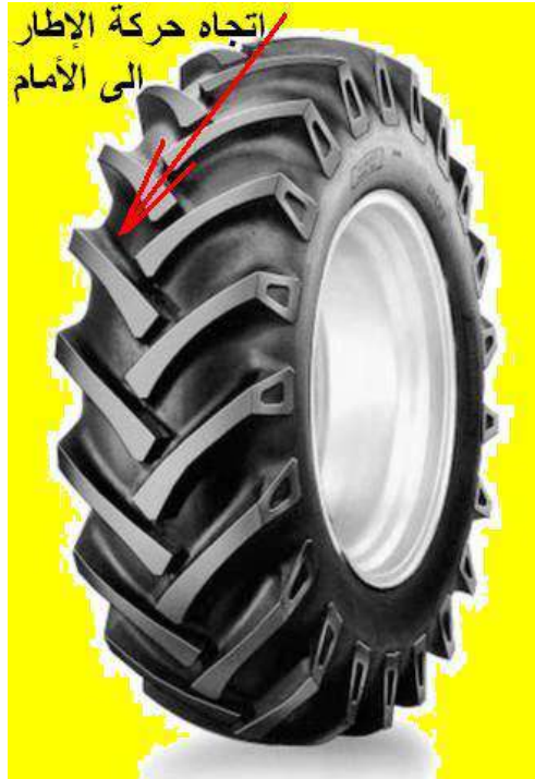
الشكل 5-37 : اتجاه أخاديد إطار السحب.
