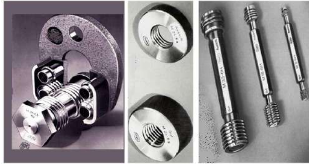
الشكل 16-1 : محددات قياس أسنان اللوالب (الداخلية والخارجية).
