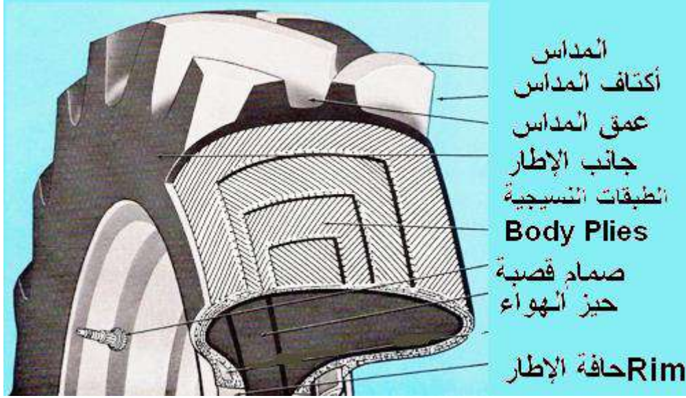
الشكل 5-33 : مقطع في الإطار القائد للساحة الزراعية.
