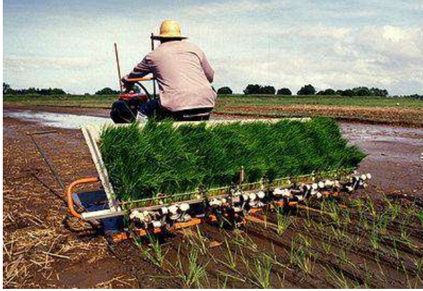
شكل 3-28 : آلات لزراعة شتلات الخضروات والرز.
