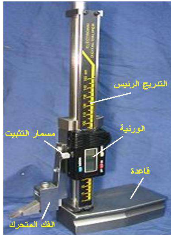
الشكل 8-1 : قدمة قياس الارتفاع.
