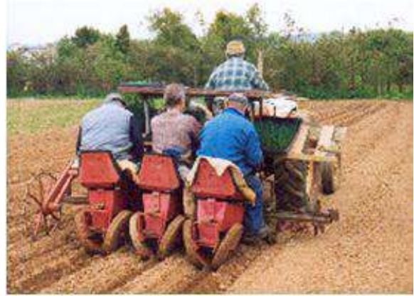
شكل 3-28 : آلات لزراعة شتلات الخضروات والرز.
