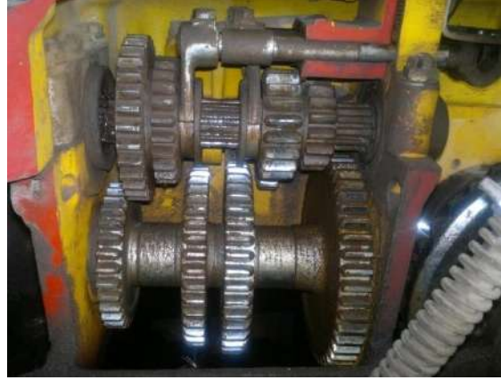
الشكل 5-16 : مكونات صندوق السرعات الانزلاقي.
