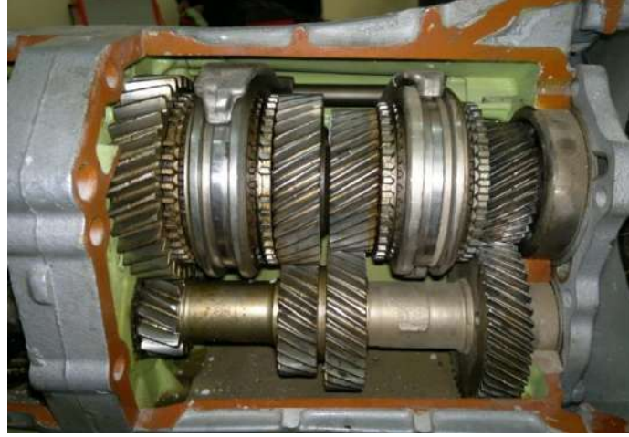
الشكل 5-17 : صندوق سرعات ذو التروس دائمة التعشيق.
