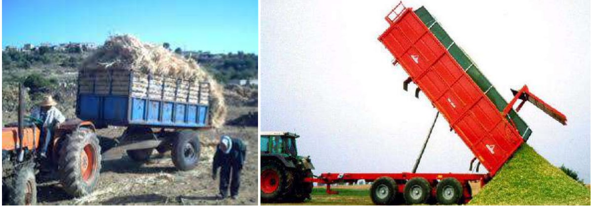
الشكل 3-42 : مقطورات النقل المسحوبة.
