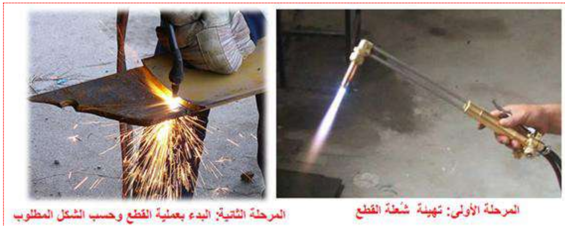
شكل 4-16 عملية قطع المعادن بالمشعل الغازي
