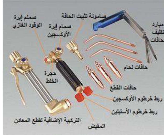
شكل 4-6 مشعل لحام الوقود الغازي وأجزائه
