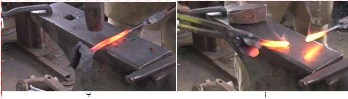
شكل 6-14 عملية لحام الحدادة للفولاذ، أ- تسخين قطع العمل للاحمرار، ب- لحام قطعتي العمل تراكيبياً
