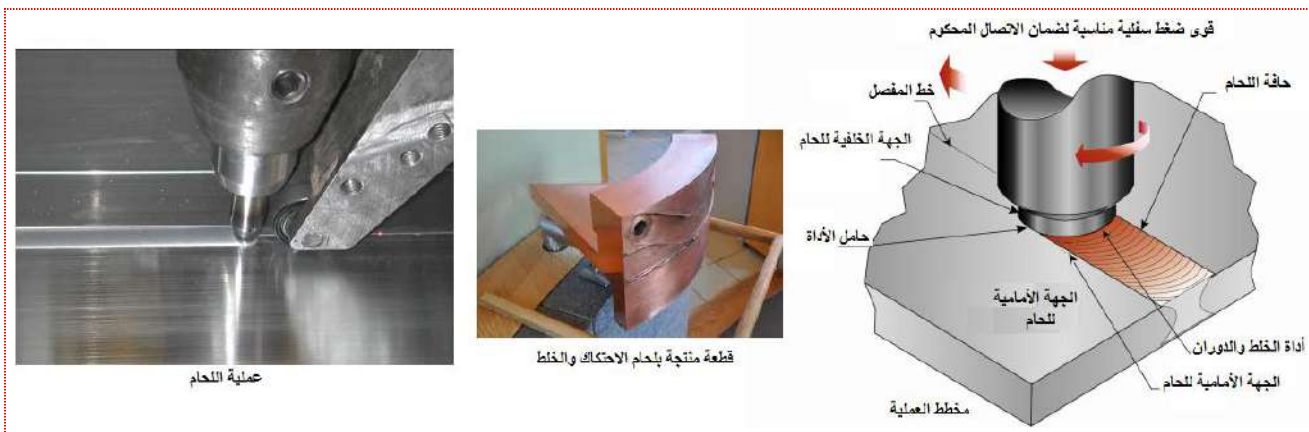
شكل 26-6 عملية اللحام بالاحتكاك والمزج بالحركة
