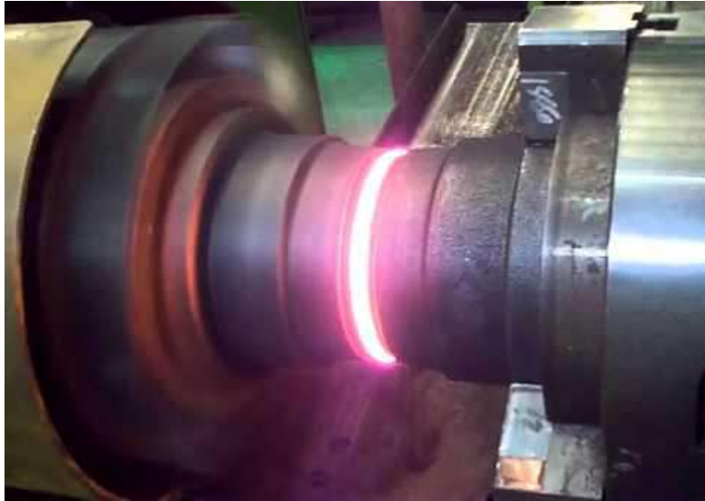
شكل 6-23 عملية لحام القصور الذاتي الاحتكاكي
