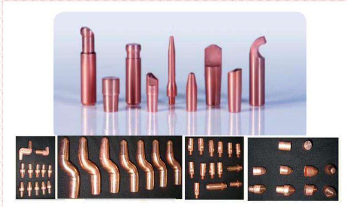
شكل 3-5 أقطاب تقليدية وأخرى غير تقليدية مستعملة في لحام المقاومة النقطي
