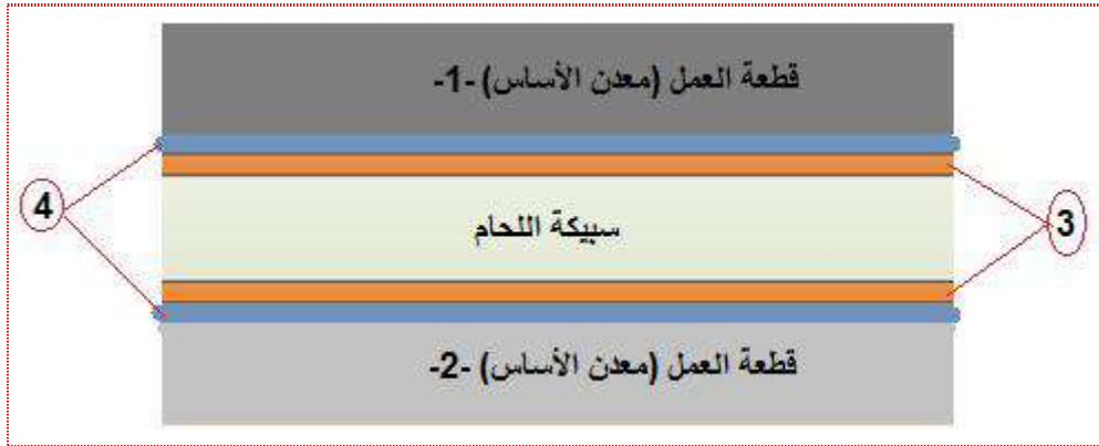
1 ، 2 قطعتا العمل (معدن الأساس)،
