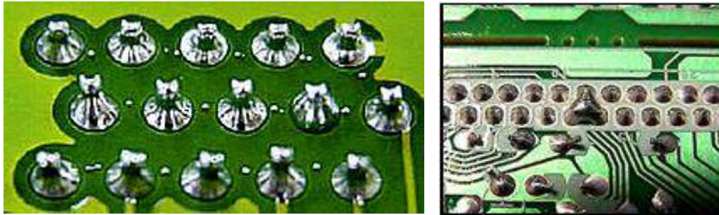
ب – شكل اللوحة بعد القصدة
