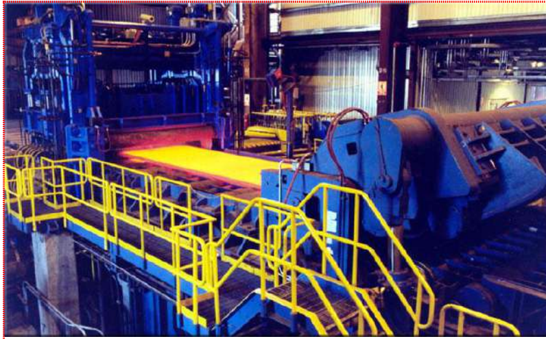
شكل 3-7 درفلة الكتل الكبيرة إلى مقاطع صغيرة على الساخن
