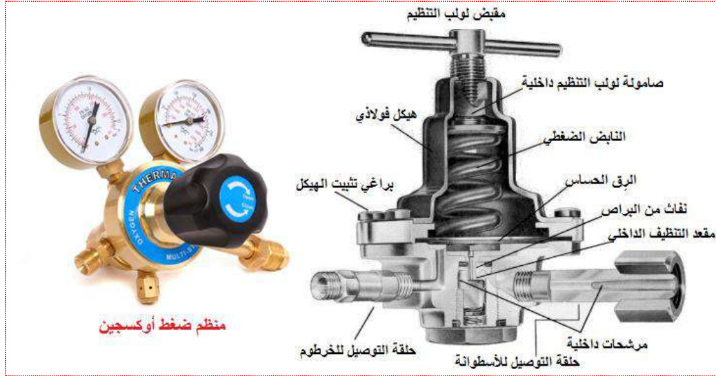
الشكل 4-7 منظم ضغط بقطع جزئي وصورة لمنظم يستعمل لغاز الأوكسجين
