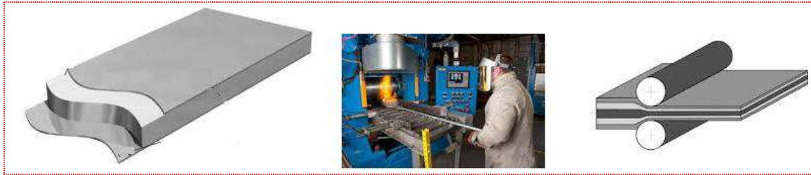
شكل 6-16 تغليف الصفائح بالدرافيل
