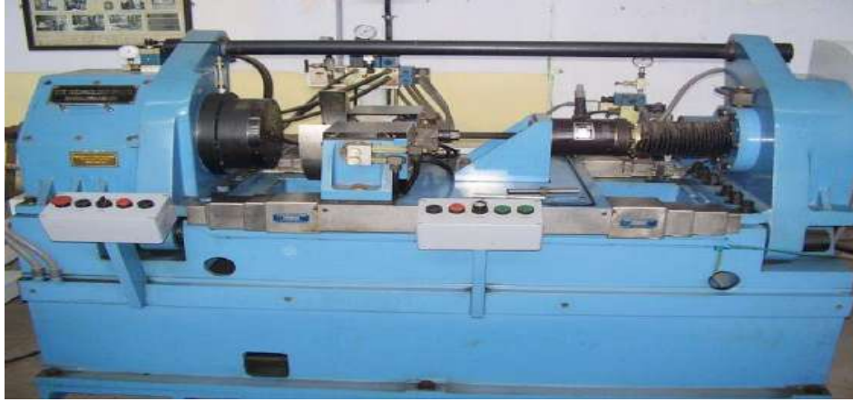
الشكل 6-24 ماكينة تستخدم في اللحام الاحتكاكي
