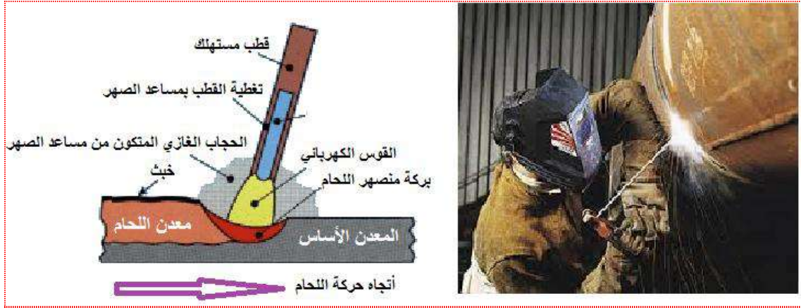
شكل 2-5 لحام القوس الكهربائي بالقطب المغلف، يمين: صورة لتنفيذ العمل، يسار: مخطط العملية
