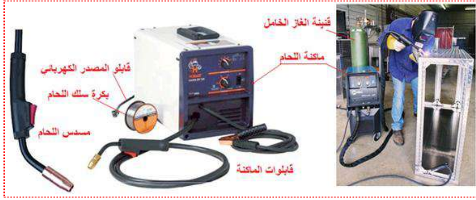
شكل 2-7 ماكينة لحام الأقطاب العارية المغمورة بالغاز الخامل مع مسدس اللحام
