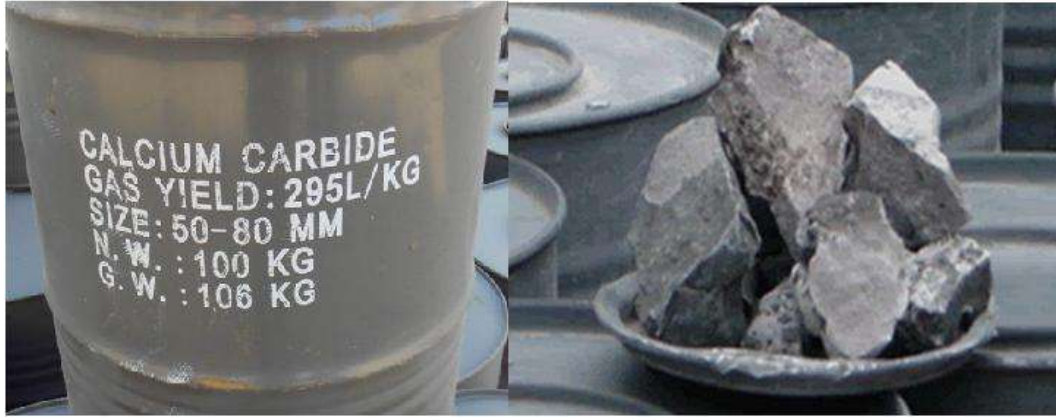
الشكل 4-11 حجر كربيد الكالسيوم وبرميل تعبئته
