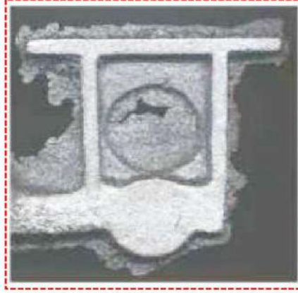
شكل رقم 6 - 3 زوائد المعدن في المسبوكة
