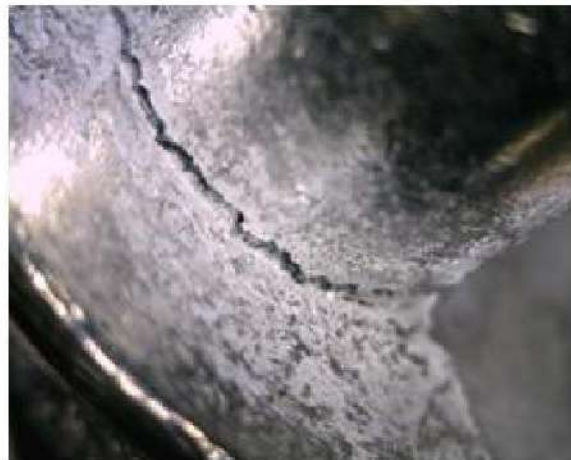
شكل رقم 6-14 تشققات وشروخ في المسبوكة عند الأركان
