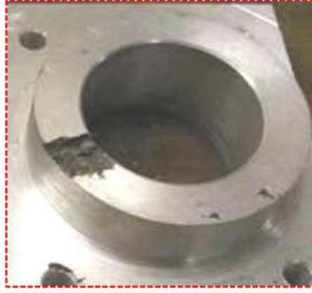
شكل رقم 6-18 الفجوات الرملية في المسبوكة
