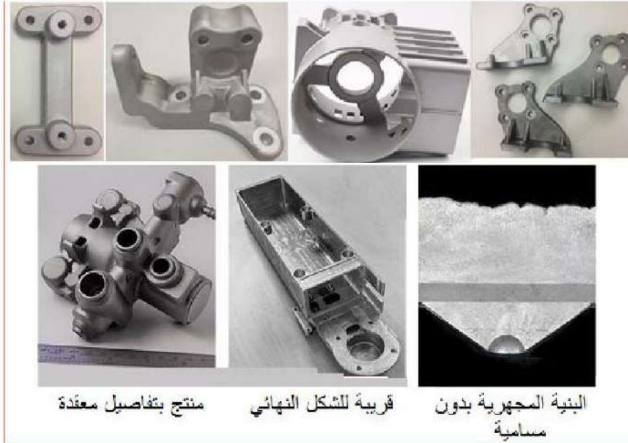
الشكل 5-19 بعض منتجات سباكة المعادن شبه الصلبة
