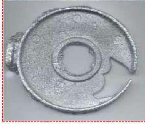
شكل رقم 16-6 عيب نقص المعدن
