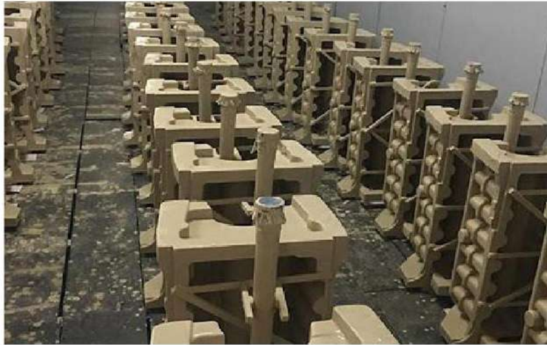
الشكل 2-5 إنتاج نماذج لمسبوكات بشكل كمي نمطي
