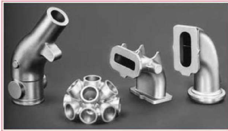
شكل رقم 3-8 أجزاء من سبائك التيتانيوم مصنعة بطريقة الشمع المفقود في المحرك التوربيني الغازي
