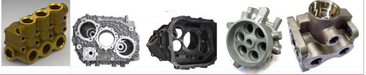
شكل 5-5 بعض مسبوكات تم سباكتها بطريقة الرغوة المفقودة
