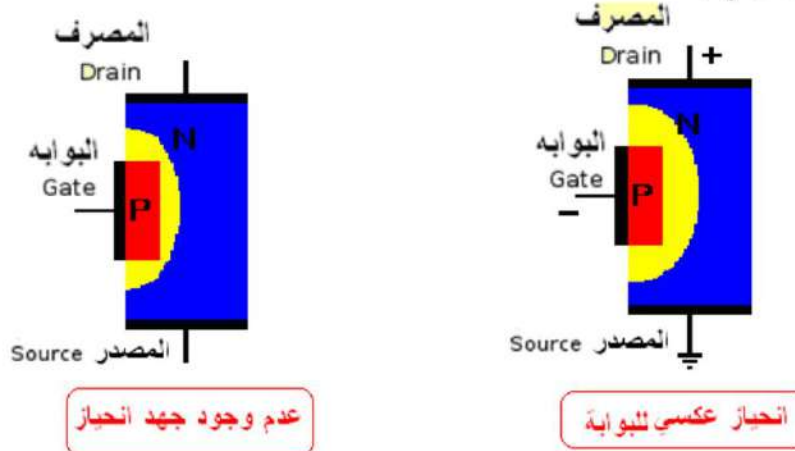
الشكل ( 4-6 ) الاتجاه الأمامي والاتجاه الخلفي لترانزستور الـ FET
