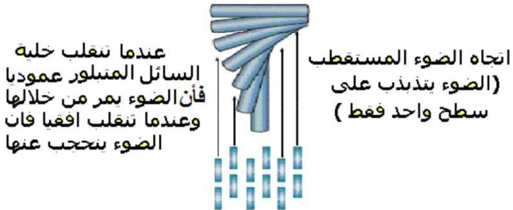
الشكل (5-60) الرسم التوضيحي عن الخلايا البلورية ضمن السائل البلوري
