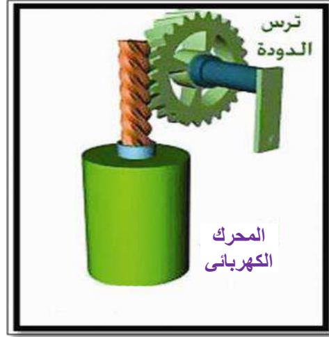
الشكل (3-8) تعشيق المحرك الكهربائي مع ترس الحلزوني
