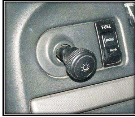
الشكل (2-7) مفتاح الانارة من النوع المنزلق
