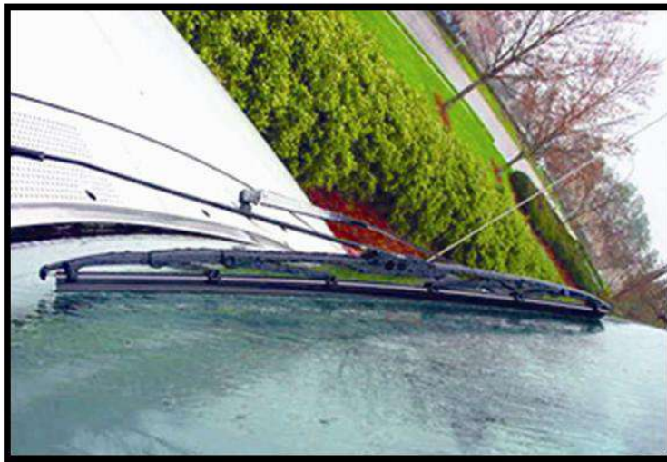
الشكل (5-8) القطعة المطاطية المثبتة على الماسحة
