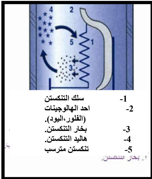
الشكل (7-8) أ. أجزاء المصباح الهالوجيني ب. مبدأ عمل المصباح الهالوجيني
