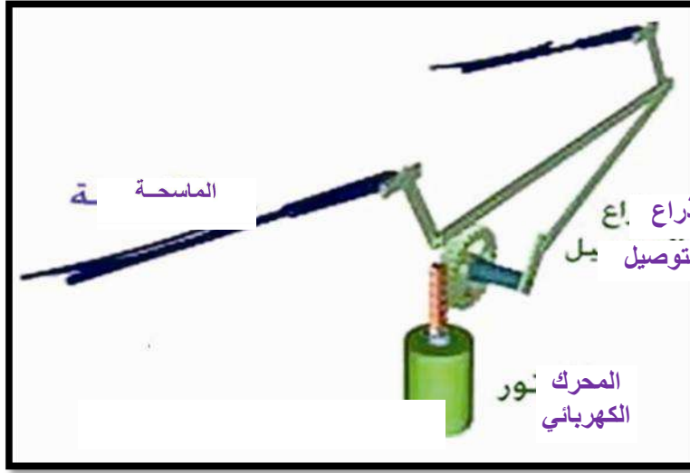
الشكل (4-8) ذراع التوصيل مع الماسحة
