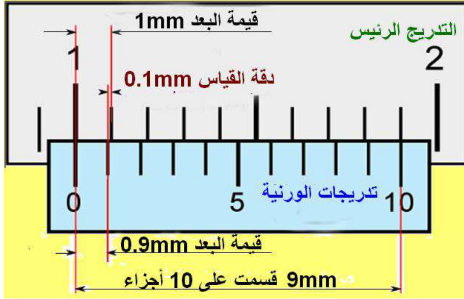
الشكل ( 4-12 ) القدمة ذات الدقة (0.1mm)
