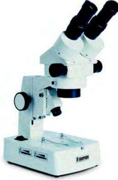
الشكل ( 5 – 4 ) مايكروسكوب لتحديد شكل حبيبات الرمل
