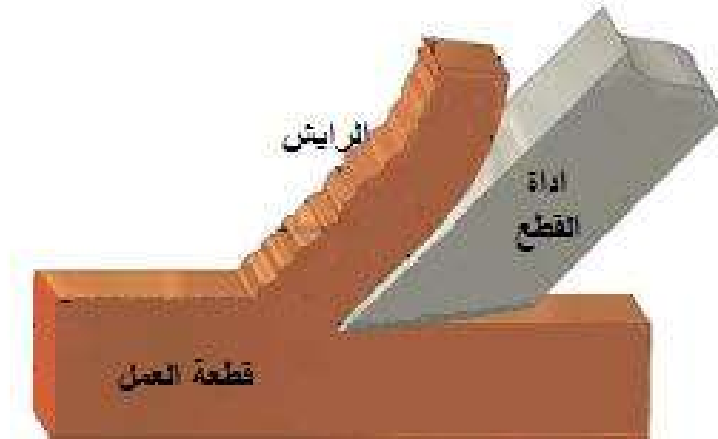
الشكل (13-2) مبدأ عملية قطع المعادن وإزالة الرايش
