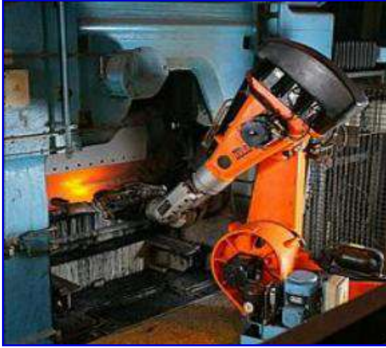
الشكل (2-3) الوسائط الأوتوماتيكية (الروبوت) في عمليات المناولة
