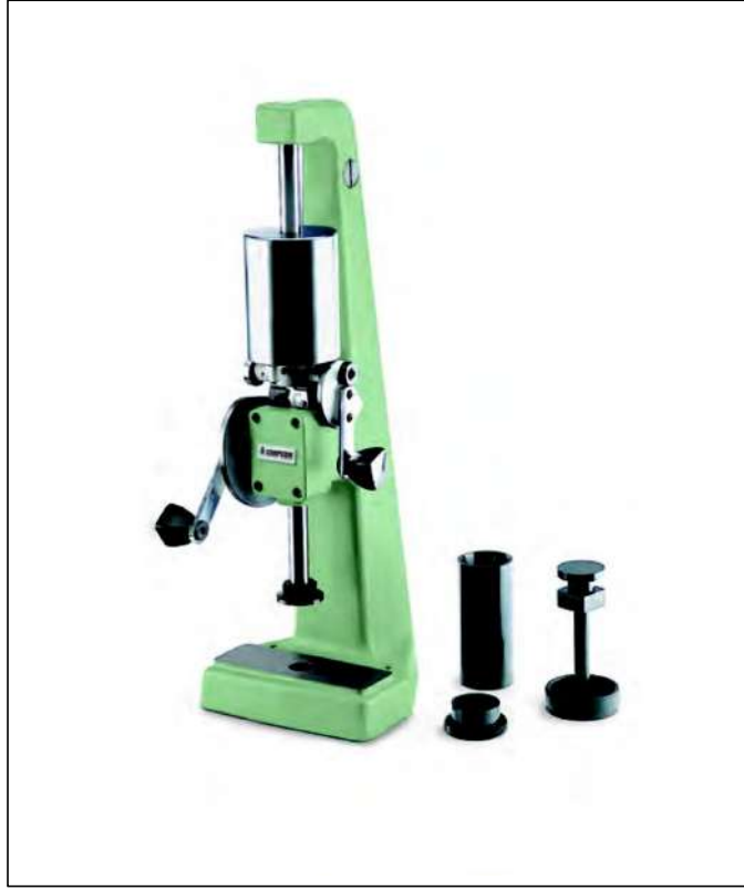
الشكل ( 5 - 2 ) جهاز دك عينات الاختبار الرملية
