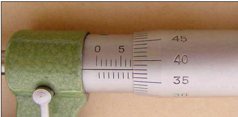
الشكل ( 4-23 ) قراءة قياس مايكروميتر الأبعاد الخارجية
