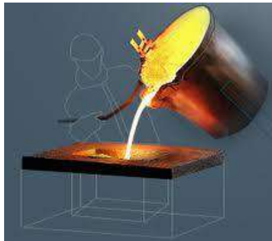
الشكل ( 6 – 28 ) يبين طريقة صب المعدن المنصهر في القالب باستخدام البودقة
