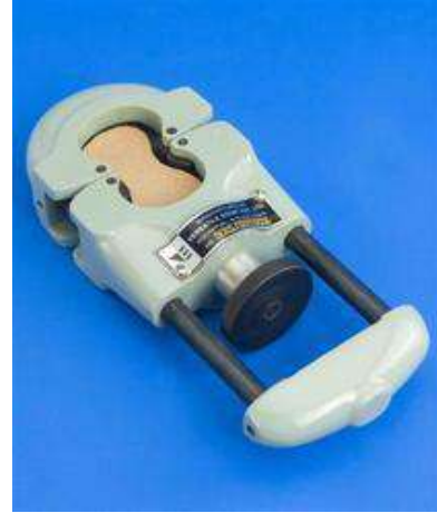
الشكل ( 5 - 11 ) أدوات عمل العينة الرملية لاختبار الشد
