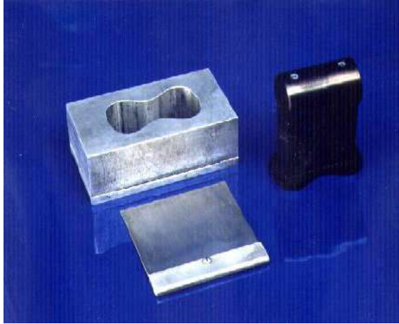
الشكل ( 5 - 11 ) أدوات عمل العينة الرملية لاختبار الشد
