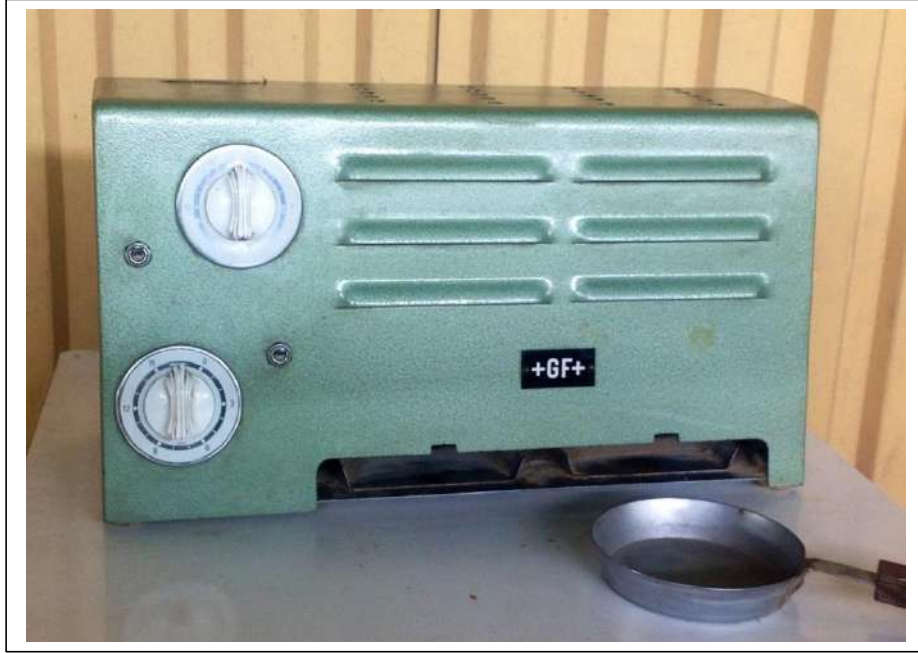
الشكل ( 5 - 8 ) جهاز تجفيف العينات الرملية
