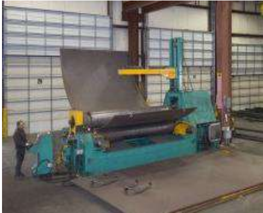
الشكل (2-5) عمليات درفلة لإنتاج شكل اسطواني
