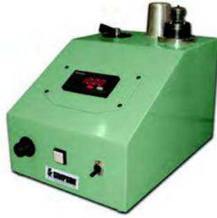
الشكل ( 5 – 9 ) جهاز اختبار نفاذية الرمل
