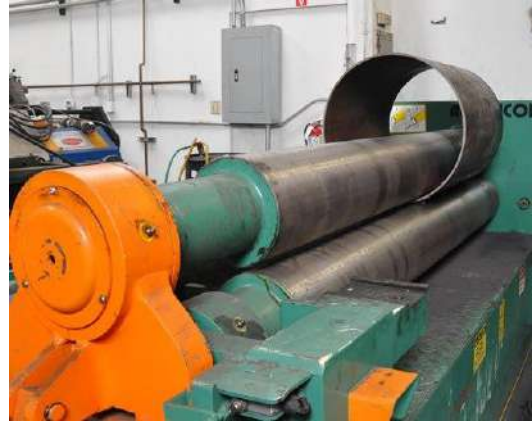
الشكل (2-5) عمليات درفلة لإنتاج شكل اسطواني
