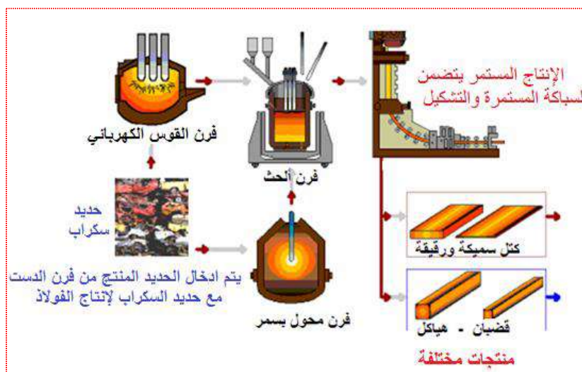
شكل 3-7 مراحل إنتاج الفولاذ
