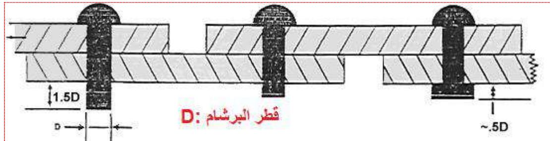
شكل 7-13 مقطع تجميعي الربط بالبرشام
