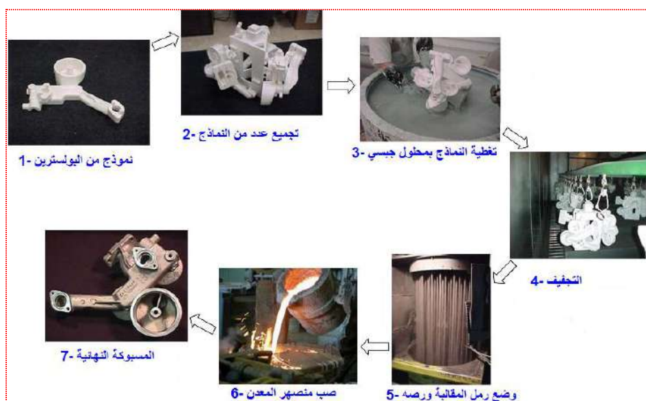
شكل 4-8 سباكة بنماذج الرغوة المفقودة (البولسترين)
