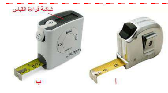
شكل 4-1 أشرطة قياس، أ- اعتيادي، ب- إلكتروني رقمي
