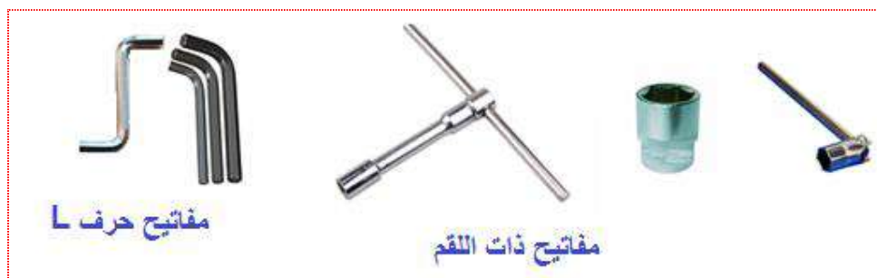
شكل 7-7 أنواع المفاتيح ذات اللقم ومفاتيح حرف L
