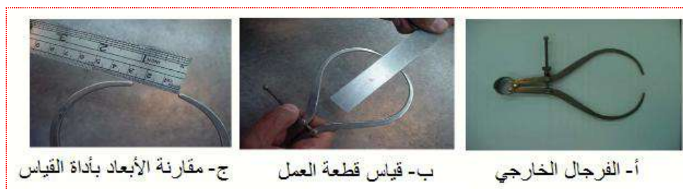
شكل 11-1 فرجال القياس الخارجي وطريقة استعماله
