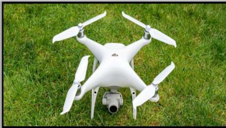
الشكل (2-2) طائرة مسيرة تستخدم في المسح التصويري في مراقبة المنشآت.
