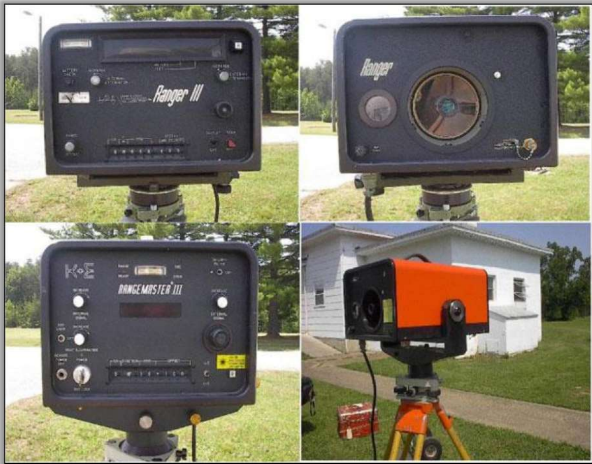
الشكل (5-15) جهاز قياس المسافات الالكتروني والمستعمل في فترة السبعينيات من القرن العشرين.
