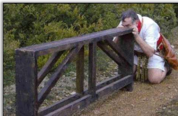
الشكل (2-1) جهاز الكوروبيتس (chorobates).
