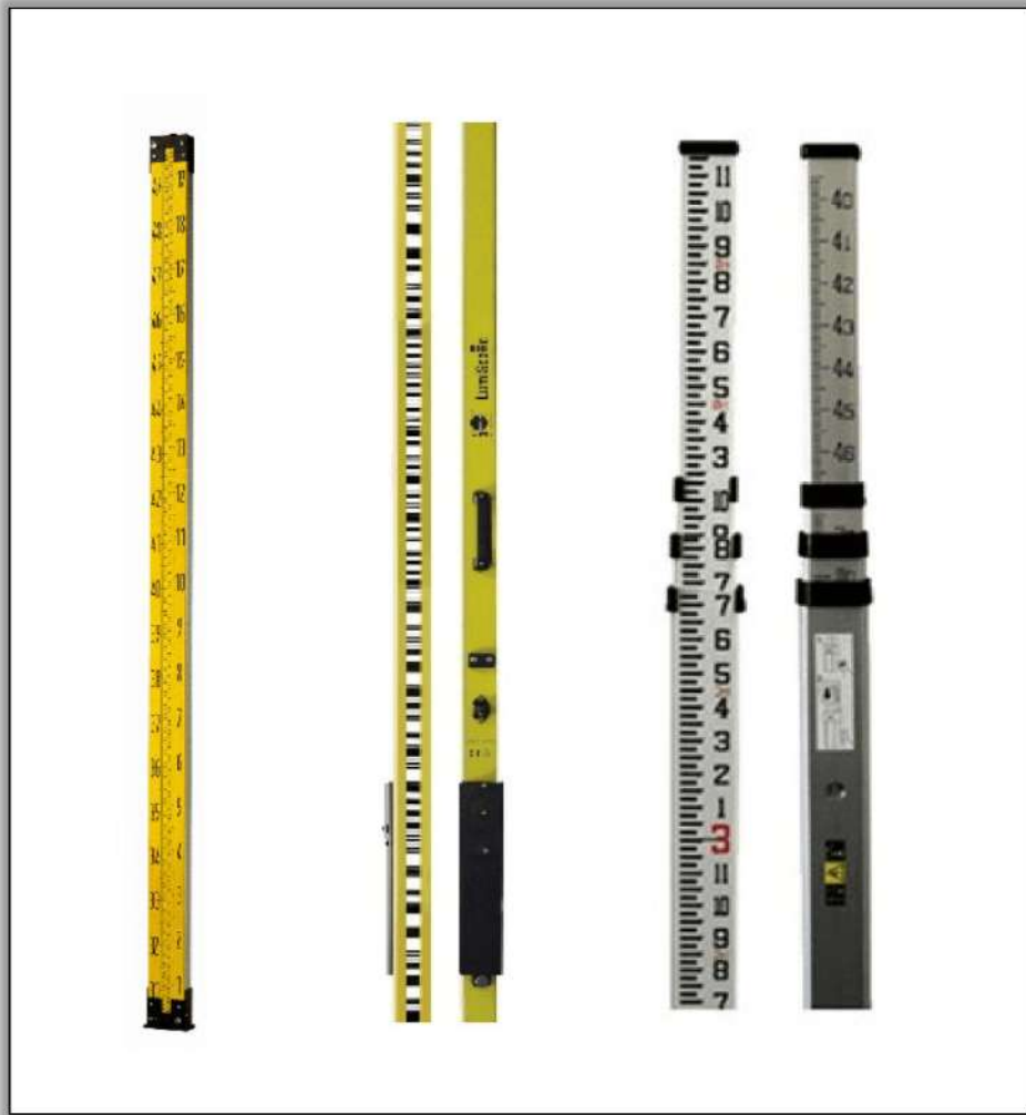
الشكل (5-10) أنواع مسطرة القياس المستعملة في جهاز الميزان.
