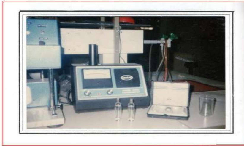
الشكل 9-2 جهاز تحديد كمية المخثرات المطلوب زيادتها لمعالجة عكارة المياه
