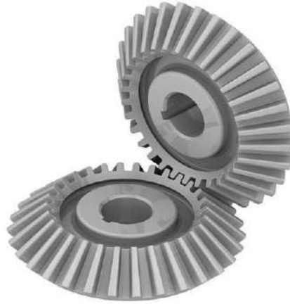
الشكل رقم (6-17) يوضح التروس المخروطية
