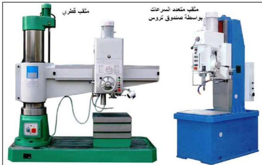
الشكل 4-31: مثقب متعدد السرعات بواسطة صندوق تروس ومثقب قطري.
