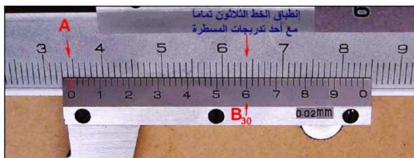
الشكل 15-1 : قراءة ورنية ذات دقة قياس (0.02mm).
