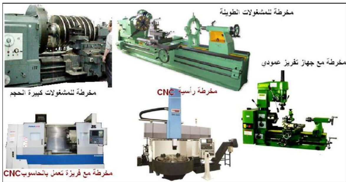
الشكل 4-45 : بعض أنواع ماكينات الخراطة.
