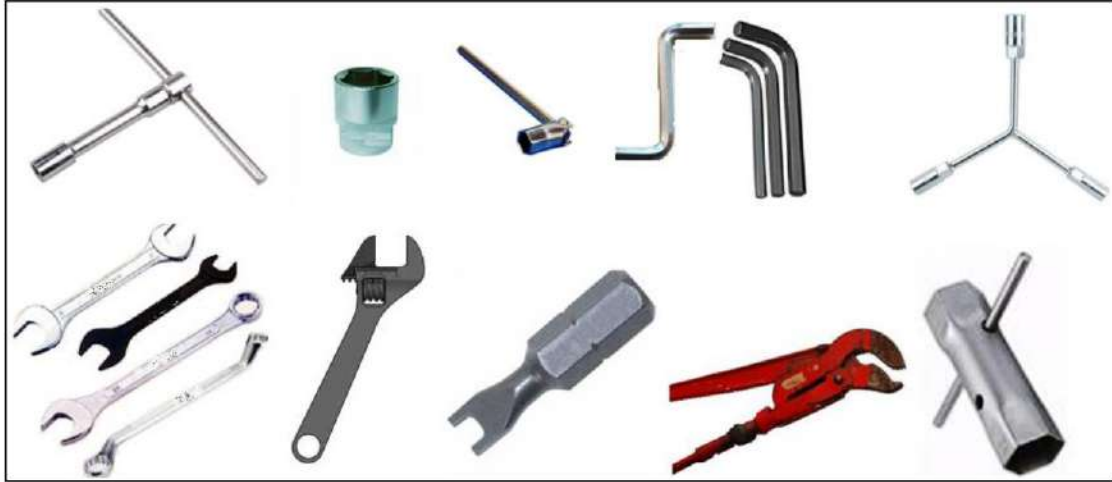
الشكل 5-5 : بعض أنواع مفاتيح الربط.
