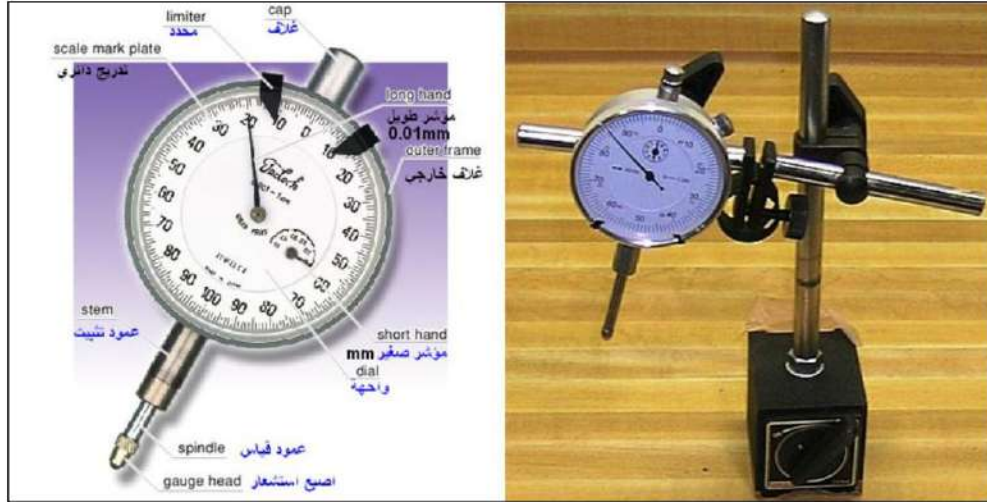
الشكل 1-32 : أجزاء ساعة القياس وطريقة التثبيت.
