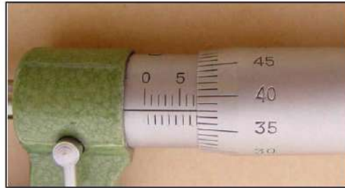
الشكل 1-23 : قراءة قياس ميكروميتر الأبعاد الخارجية.
