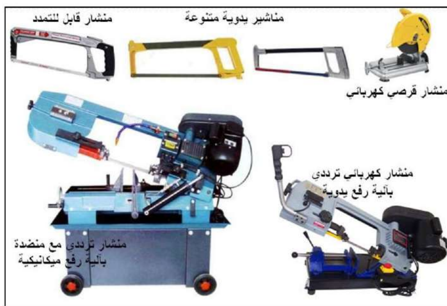
الشكل 4-12 : بعض أنواع عدد وآلات النشر اليدوي والكهربائي.
