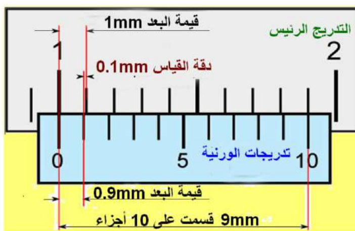
الشكل 1-12 : القدمة ذات الدقة (0.1mm).
