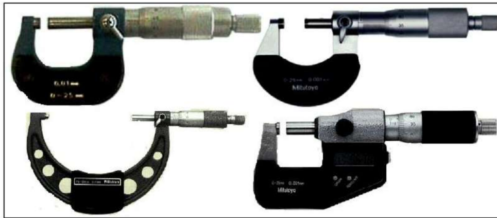
الشكل 18-1 : بعض أنواع ميكروميتر القياس الخارجي.
