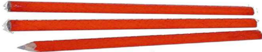
شكل (2-1) يوضح أقلام الرصاص المستعملة في النجارة
