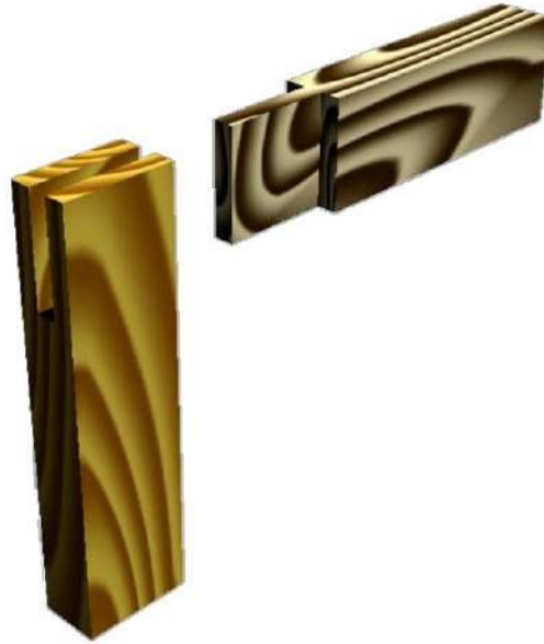
شكل (3 - 12) يوضح تعشيقة نقر ولسان جانبي نافذ
