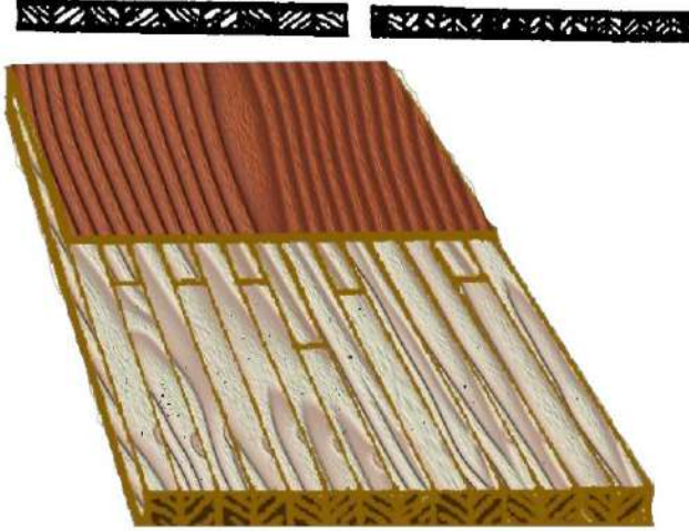
شكل رقم (1-63) يبين الأخشاب المسدبة
