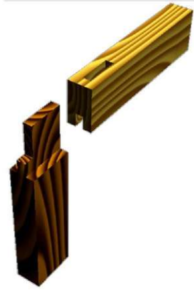
شكل (3 - 14) يوضح تعشيقة نقر ولسان نافذ بركبة
