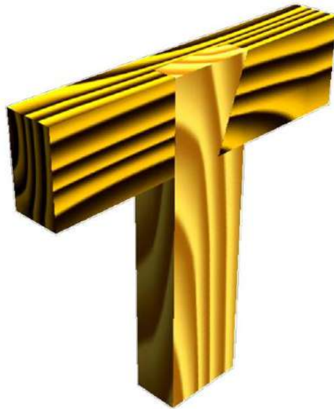
شكل (3-8) يوضح تعشيقة نصف على نصف غنفاري جهة واحدة
