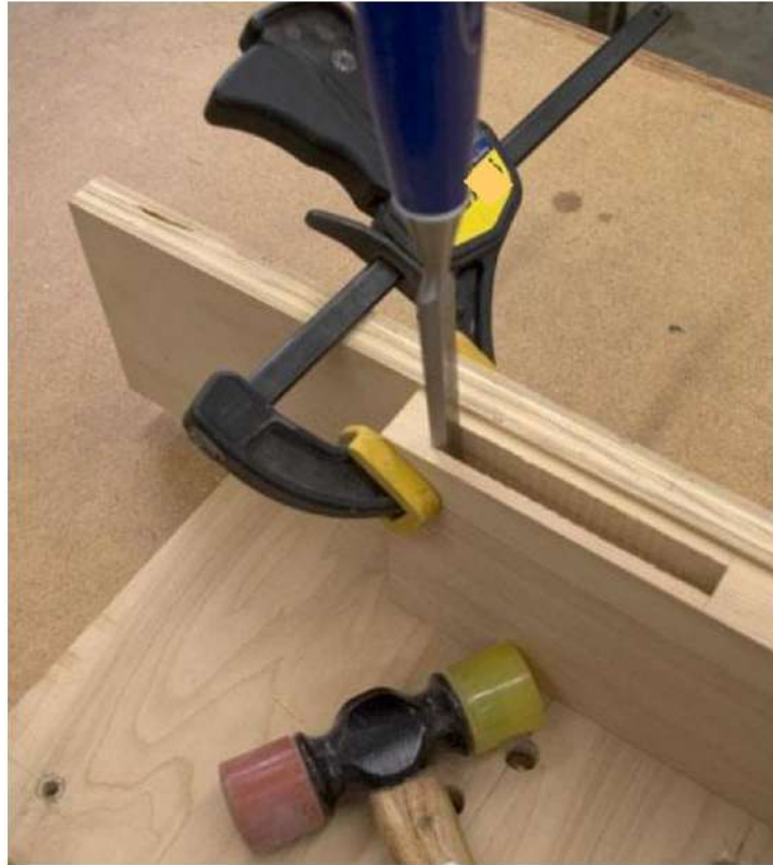
الشكل (2- 84) يوضح تعامل المنقار مع سطح الشغلة
