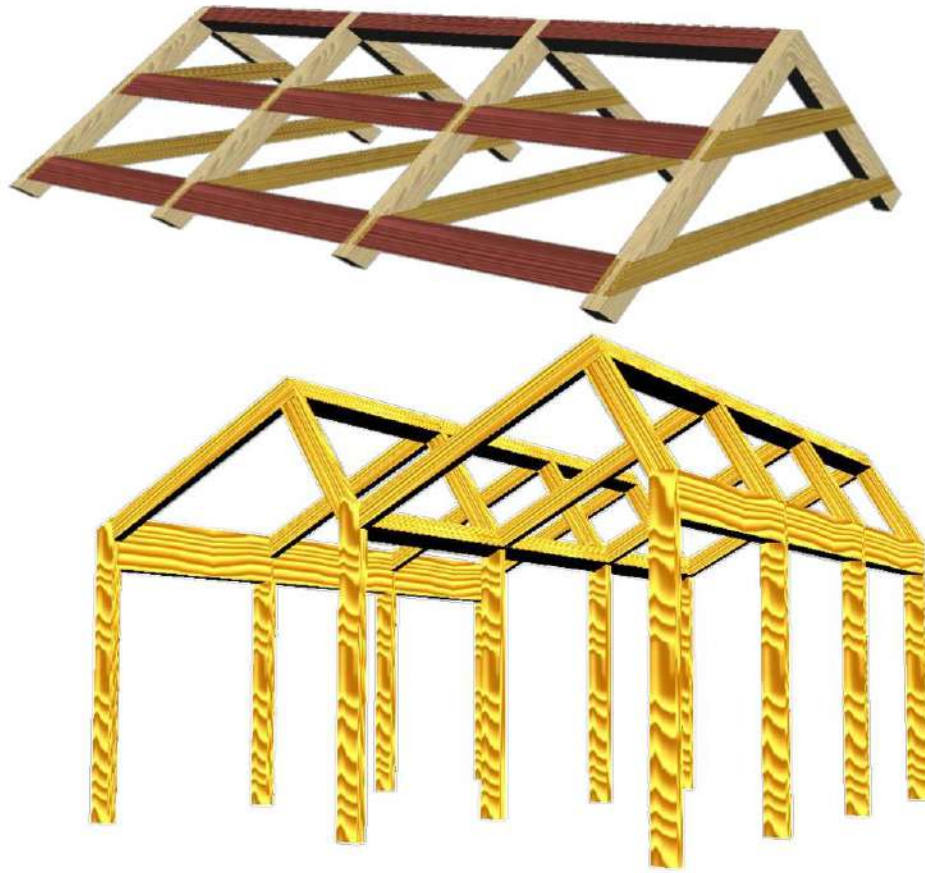
شكل (3 - 17) يوضح استعمال تشبيقة اللجام في عمل المسقفات
