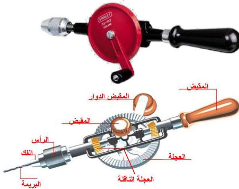
الشكل (2- 92) يبين المثقاب اليدوي البسيط وأجزائه
