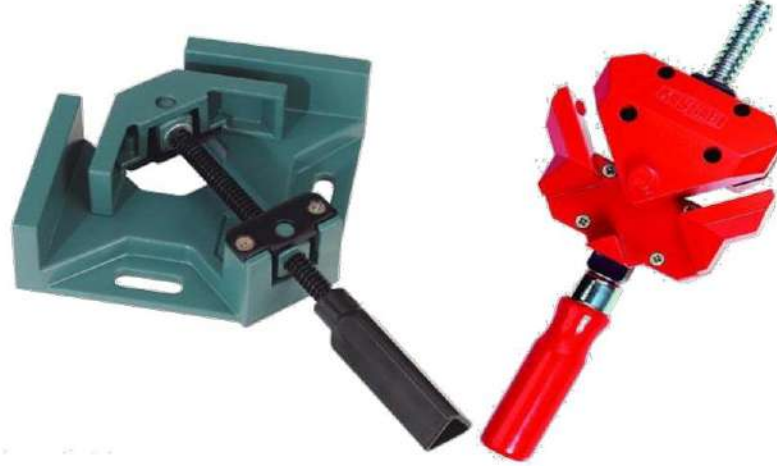
الشكل ( 2 - 64 ) يوضح بعض أشكال فخة ربط الزوايا
