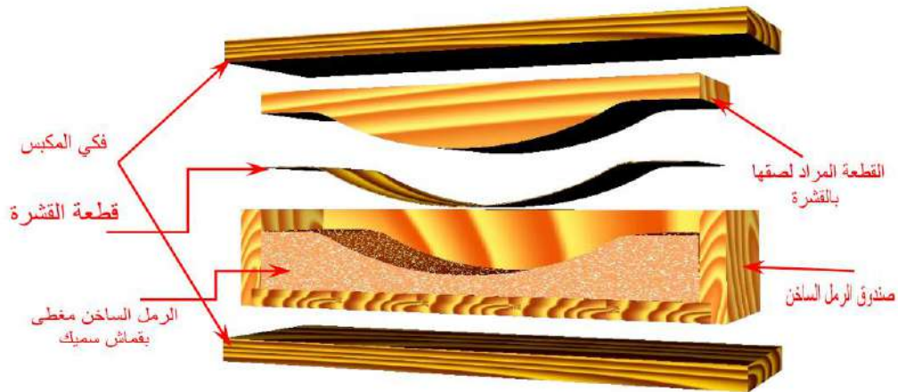
شكل (1 - 56) يبين كيفية لصق القشرة بصندوق الرمل الساخن
