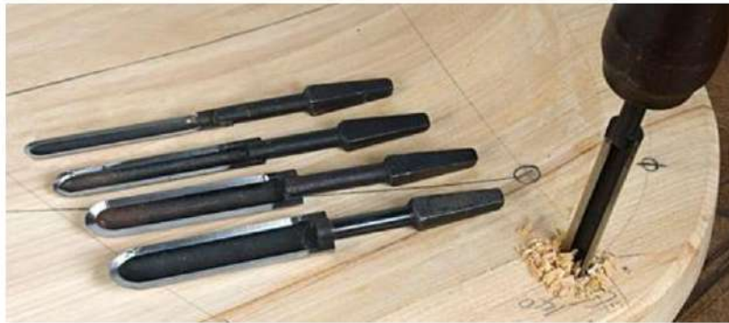
الشكل (2- 98) يوضح بعض أشكال بريمة الملعقة
