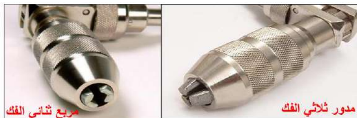
الشكل (2 - 90) يوضح أنواع الرأس الماسك للبرايم
