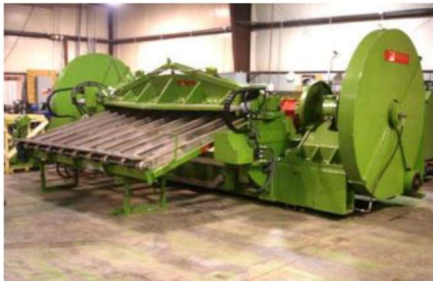
شكل (1- 48 ب) يبين ماكنة قطع القشرة المركزية
