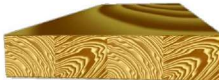
الشكل (1-65) يوضح الألواح ذات السدائب المتوسطة
