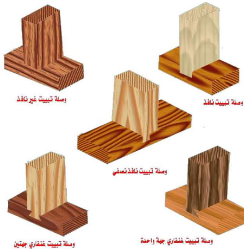
شكل (3 - 15) يوضح أنواع الوصلات المستعرضة
