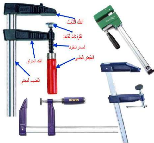
الشكل (2 - 63) يوضح بعض أشكال الفخة المنزلقة
