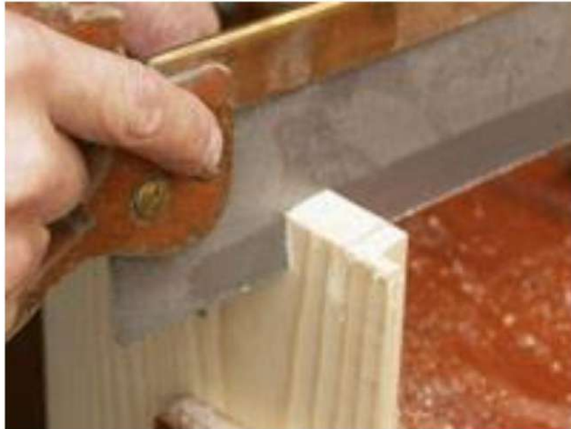
الشكل (2 - 36 أ) يوضح استعمال منشار الظهر
