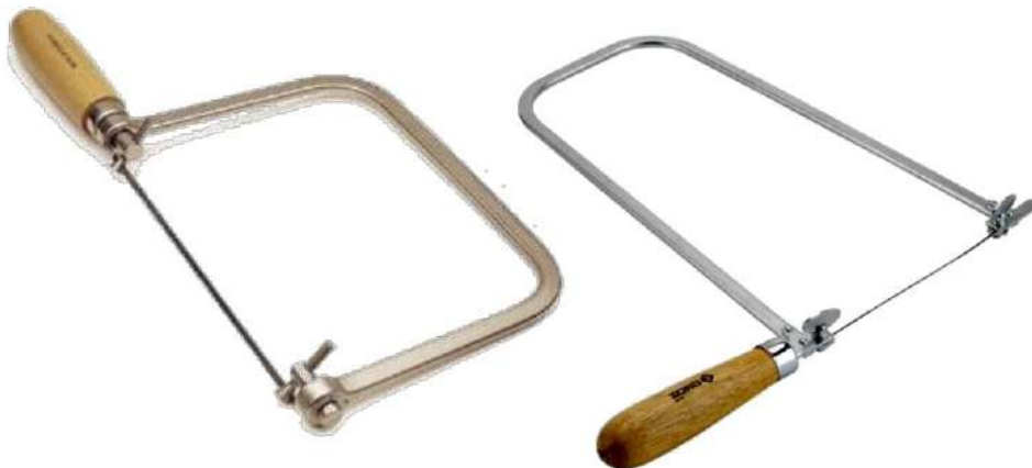
الشكل (2 - 40) يوضح بعض أشكال منشار التخريم
