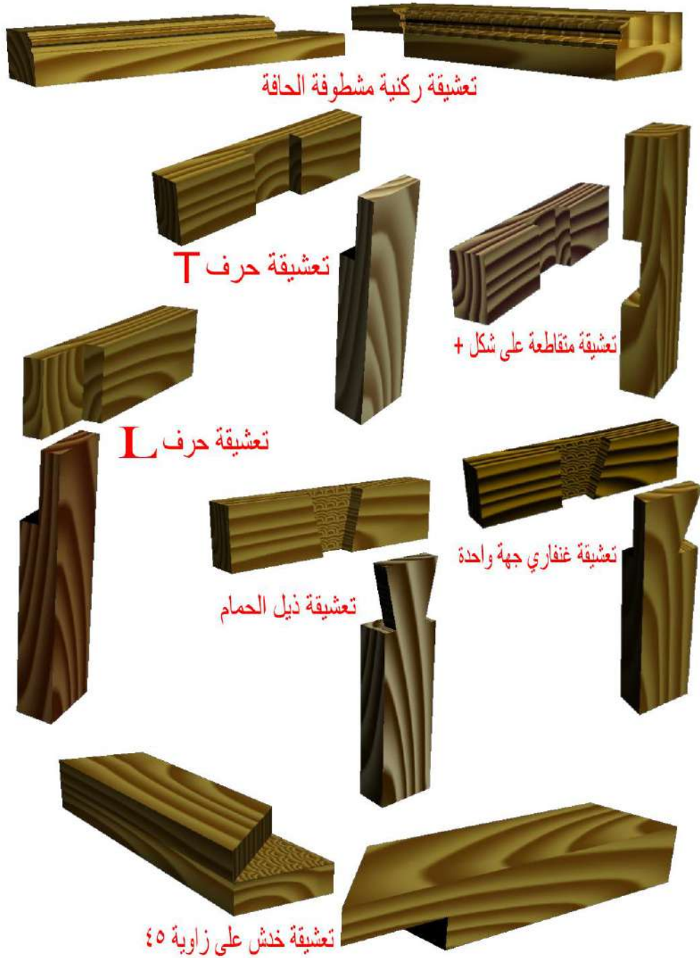
شكل (3 - 1) يوضح أنواع وصلات الخدش
