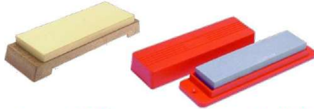
الشكل (2 - 73) يوضح بعض أشكال حجر السن
