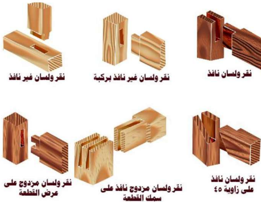
شكل رقم (3 - 9) يبين أنواع وصلات النقر واللسان
