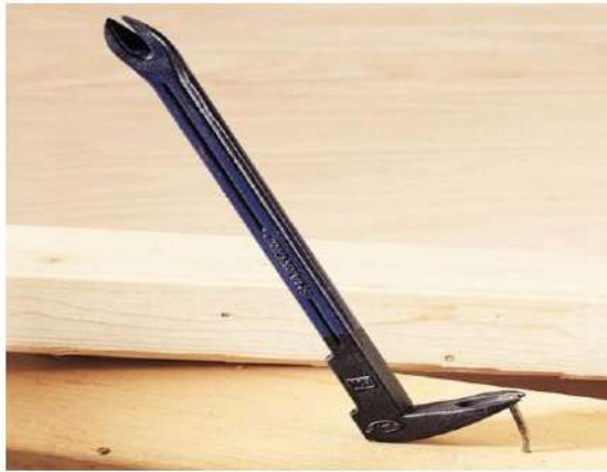
الشكل (2 - 57) يوضح العتلة الخاصة لرفع المسامير الكبيرة
