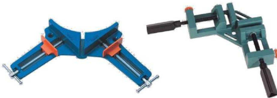
الشكل ( 2 - 65 ) يوضح بعض أنواع فخات قطع الزوايا والبراويز
