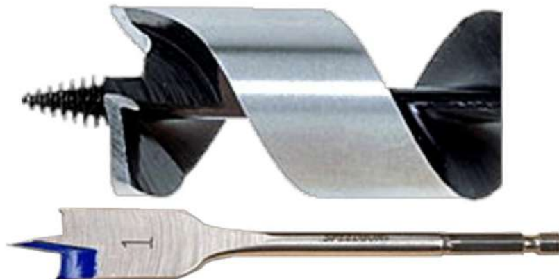
الشكل (2- 99) يوضح بعض أنواع بريمة المركز
