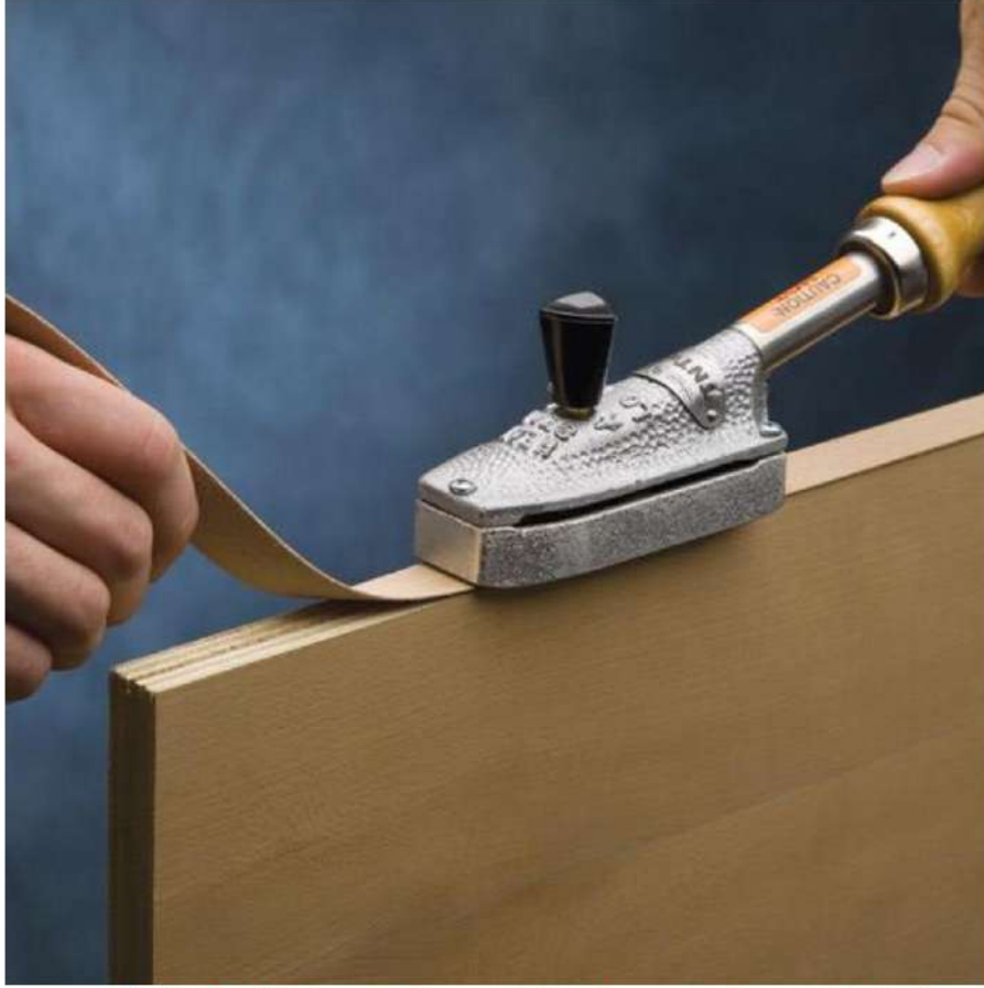
الشكل (1- 54) يوضح طريقة لصق القشرة بواسطة مطرقة القشرة
