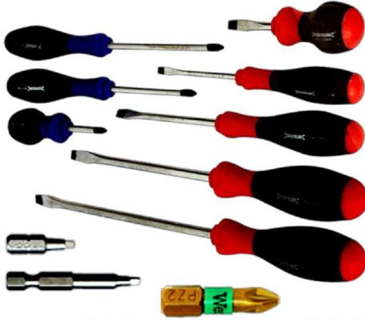
الشكل (2- 86) يوضح بعض أشكال المفك الاعتيادي
