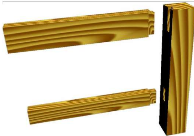
شكل (3 - 11) تجميع الأرجل مع العارضة الجانبية للطاولة
