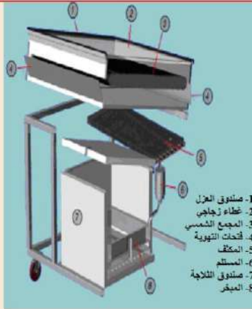
شكل 6-11 أجزاء الثلاجة الامتزازية الشمسية
