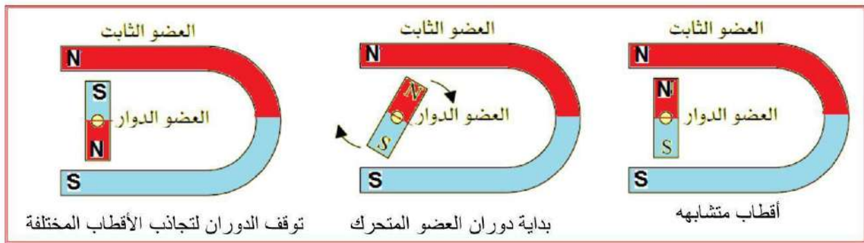
شكل 7-14 مبدأ عمل المحرك الكهربائي
