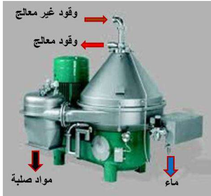
الشكل (2- 9) يوضح أجهزة الطرد المركزي لتنقية الوقود الخام
