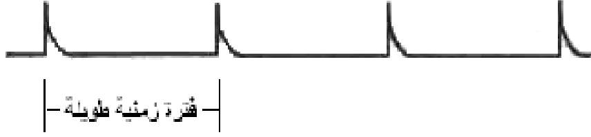
الشكل ( 41 - 7 ) الموجات الكهرومغناطيسية المرسلية من مرسل الرادار
