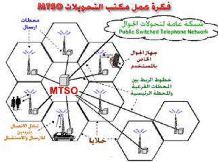
الشكل ( 4 - 6 ) فكرة عمل مكتب التحويلات MTSO
