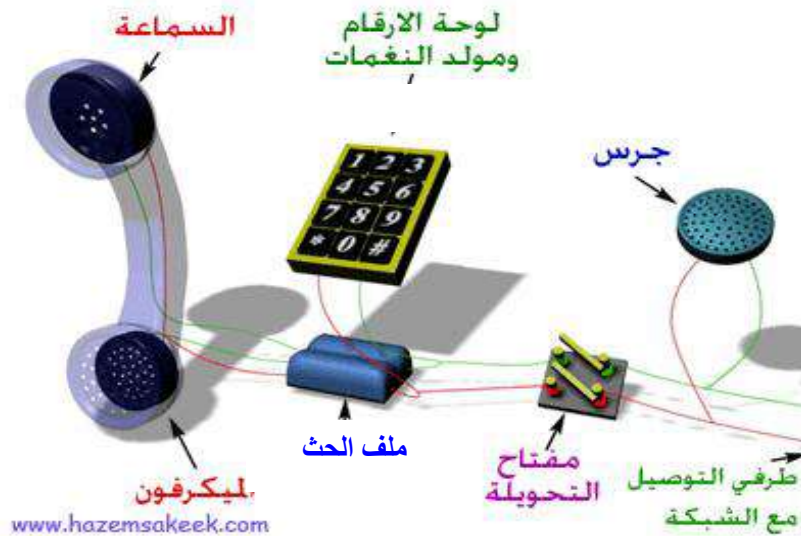
الشكل ( 1 - 1 ) اجزاء الهاتف الاساسيه
