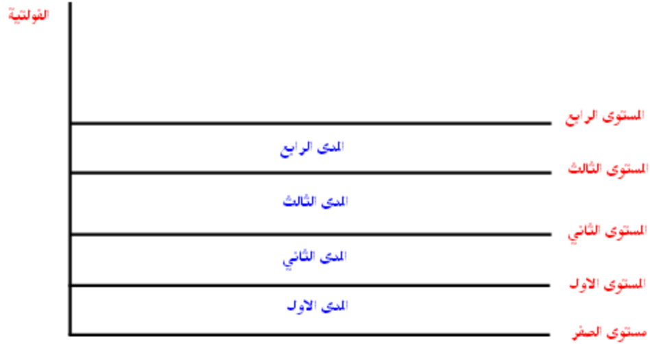
الشكل ( 2 - 23 ) التحويل التماثلي الرقمي A / D
