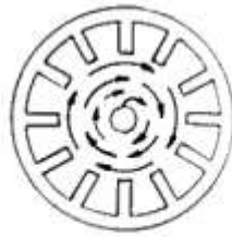
الشكل (7-24) تأثير المجال الكهربائي والمجال المغناطيسي على حركة الالكترونات
