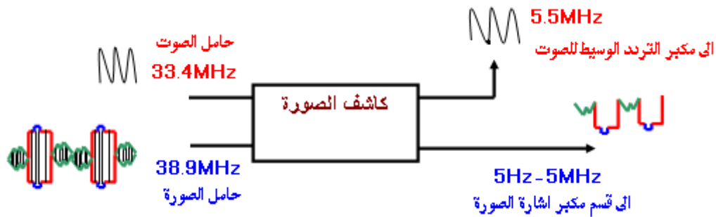
الشكل ( 5 - 30 ) المخطط الكتلي لكاشف الصورة
