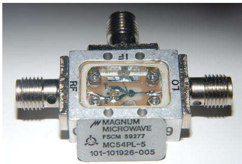
الشكل ( B - 6 - 7 ) يوضح المازج في منظومة مايكروويف
