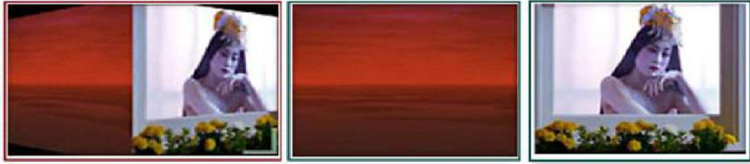
الشكل 6 - 18 عملية المسح
