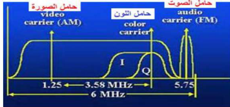
الشكل 4-2 طيف إشارة الصورة لنظام NTSC
