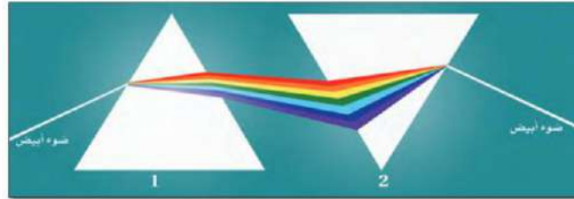
الشكل 1 - 15 تحليل وتركيب الضوء بالموشور
