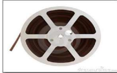
الشكل 4 - 4 الشريط المغطى بطبقة مغناطيسية
