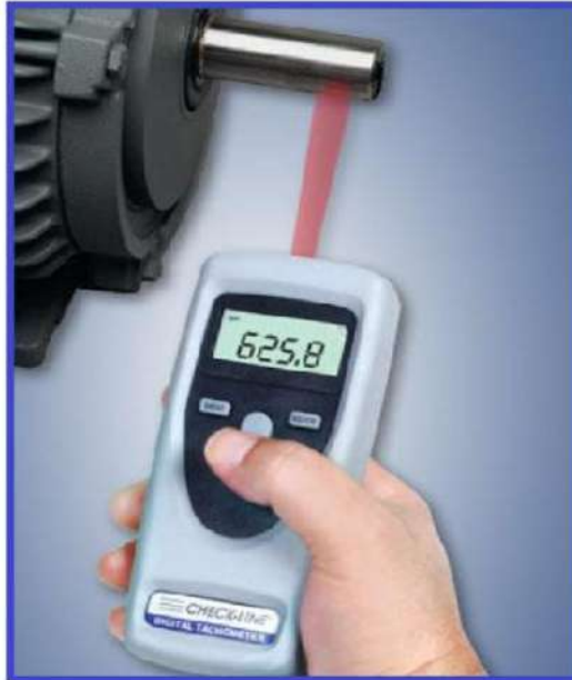
شكل (2-35) مقياس سرعة ضوئي يعتمد على استخدام اشعة الليزر
