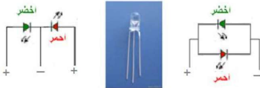
الشكل (3-1) ثنائيات الانبعاث الضوئي مزدوج الألوان
