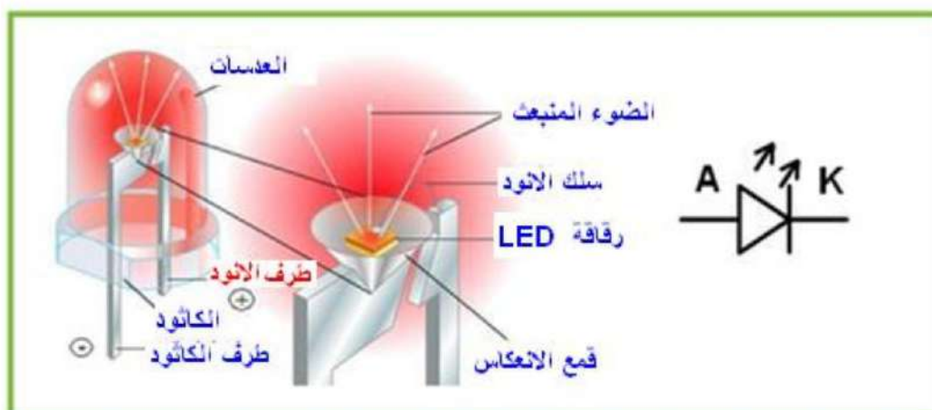
الشكل (2-1) تركيب ورمز ثنائي الانبعاث الضوئي
