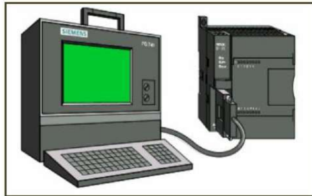
الشكل (3-5) جهاز البرمجة مع جهاز PLC
