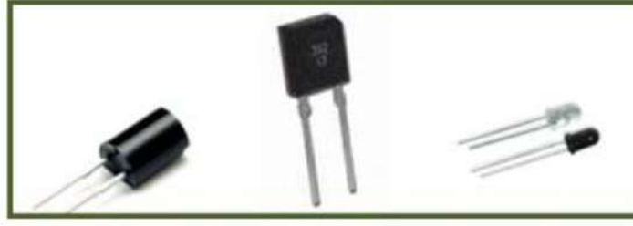
الشكل (28-1) أنواع مختلفة من الثنائيات الضوئية للأشعة تحت الحمراء
