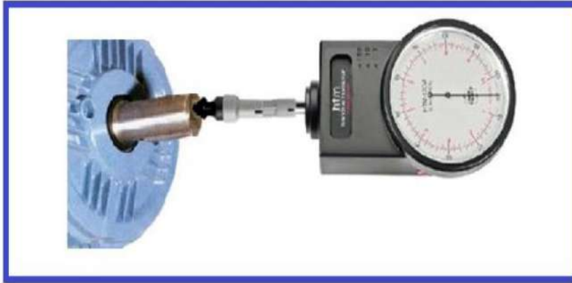
الشكل (31-2) استخدام جهاز قياس السرعة الكهروميكانيكي لقياس سرعة المحرك الكهربائي
