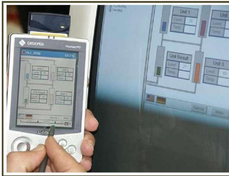
الشكل (1-34) شاشة عرض لنظام Scada
