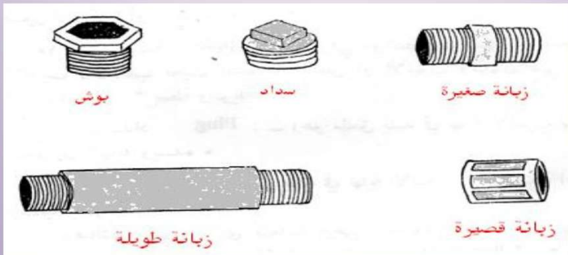
الشكل رقم (٥-٧) بعض أنواع التوصيلات (الملحقات) للأنابيب
