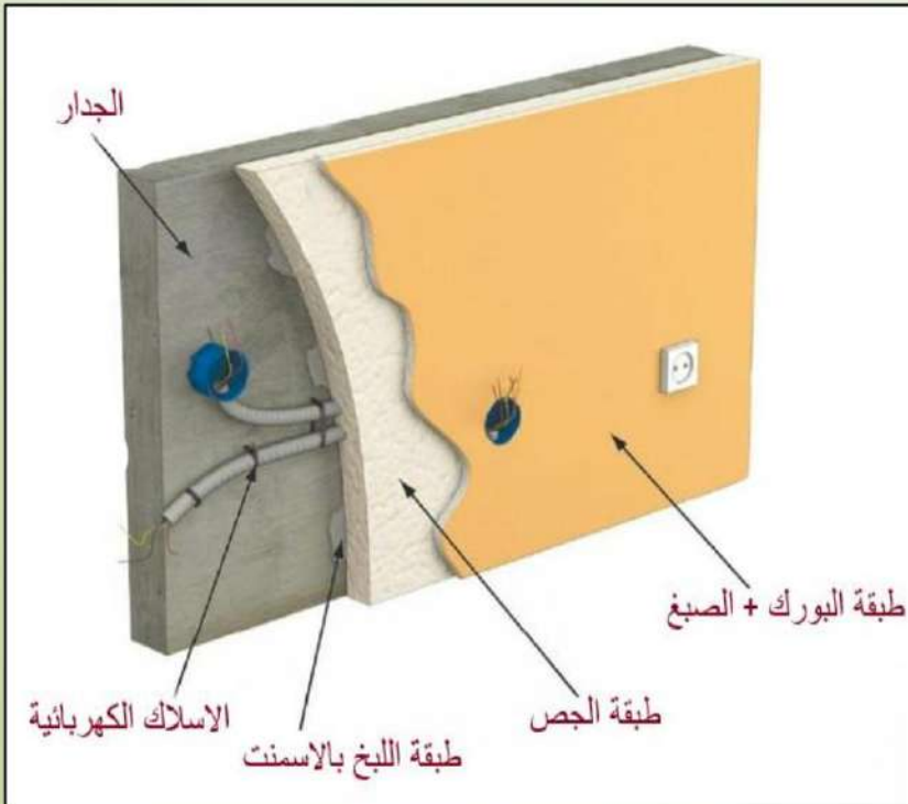
الشكل رقم (٨-٤) عملية التأسيس تحت البياض
