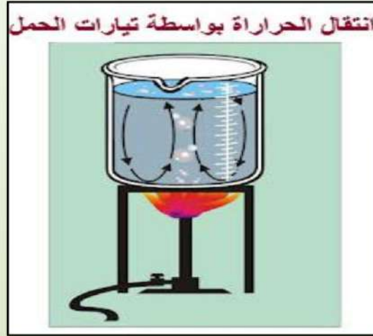
الشكل رقم (٢-٩) الانتقال بطريقة الحمل
