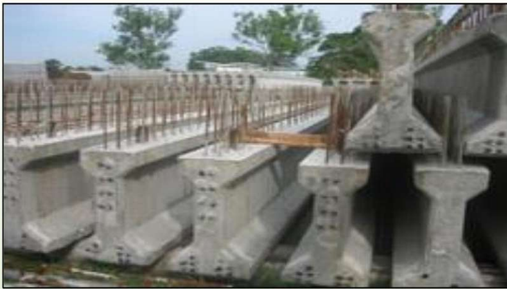
أعتاب خرسانية جاهزة ذات مقطع على شكل حرف I
