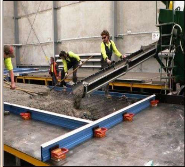
الشكل (٥-٢) يوضح صب الخرسانة في القالب الشكل (٥-٣) طريقة رفع القطع الخرسانية الجاهزة
