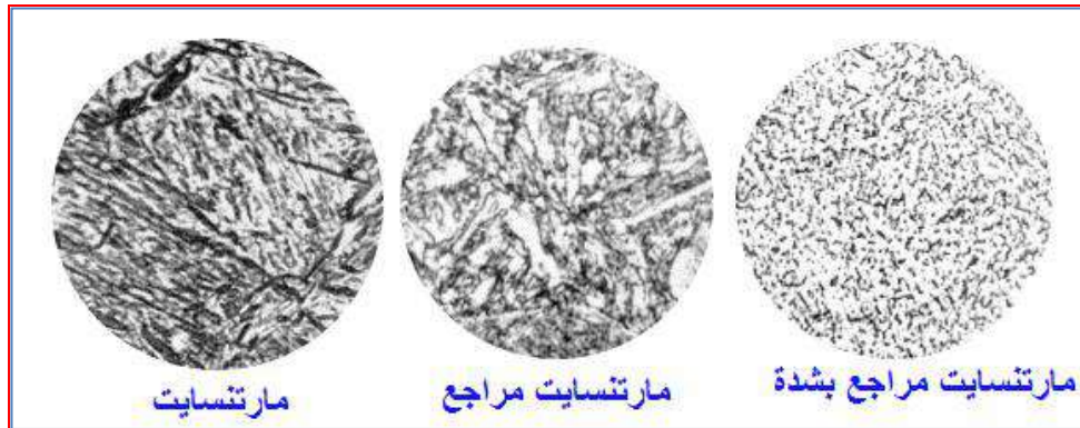
شكل 4-23 بنية المارتنسايت وبنية المارتنسايت المراجع
