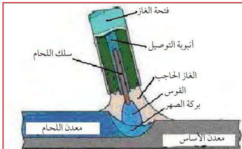
شكل 4-2 نظام الحجب بعملية لحام (MIG/MAG)
