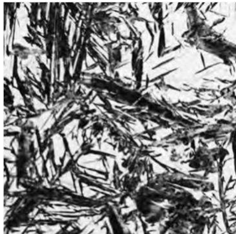
شكل 4-11 البنية المجهرية لطور المارتنسايت من سبيكة الفولاذ
