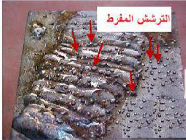
الشكل 5-13 عيب الترشش المفرط
